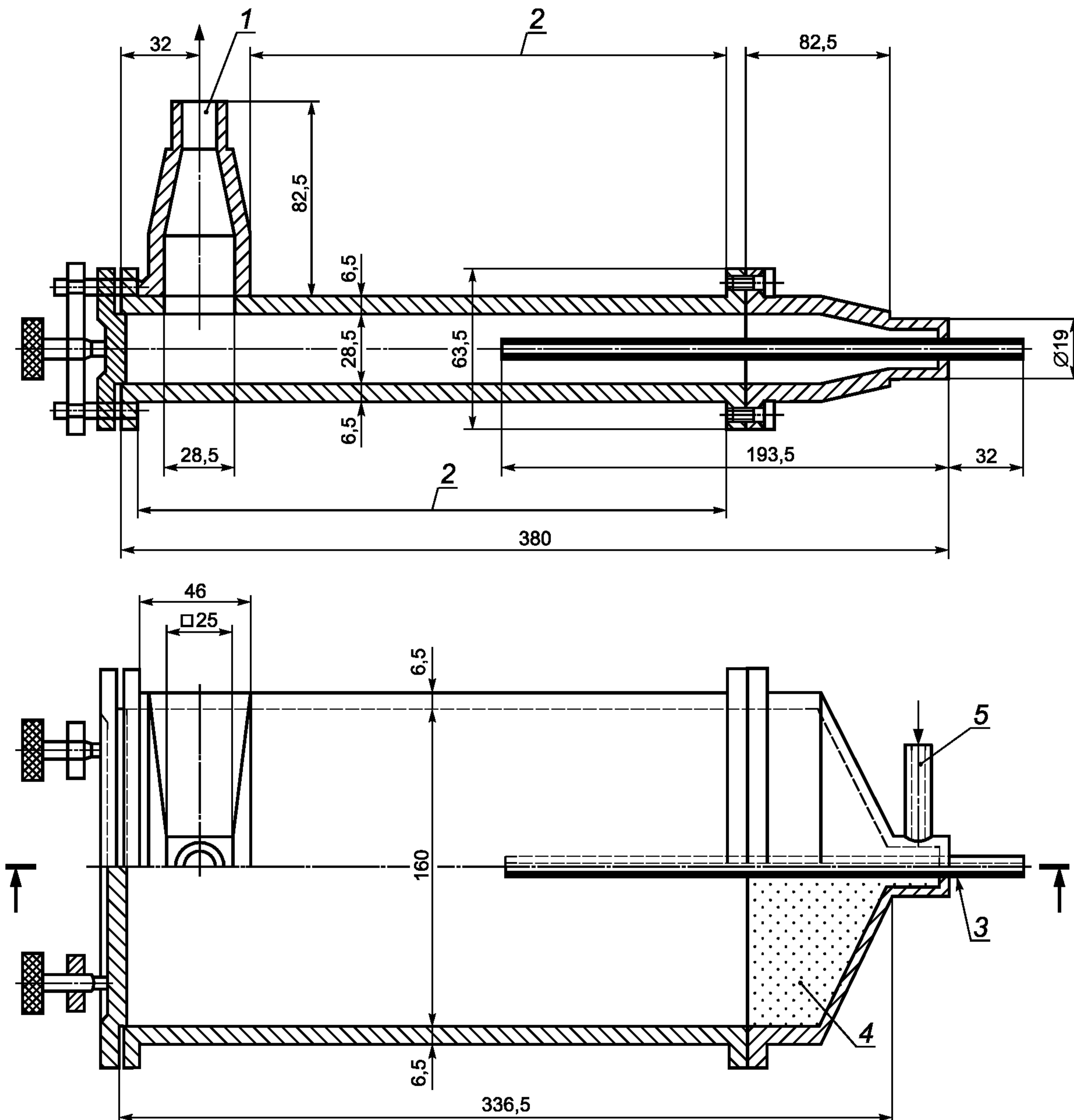
1 — выпускное отверстие для азота; 2 — пространство для нагревательного элемента; 3 — трубка для термометра;
