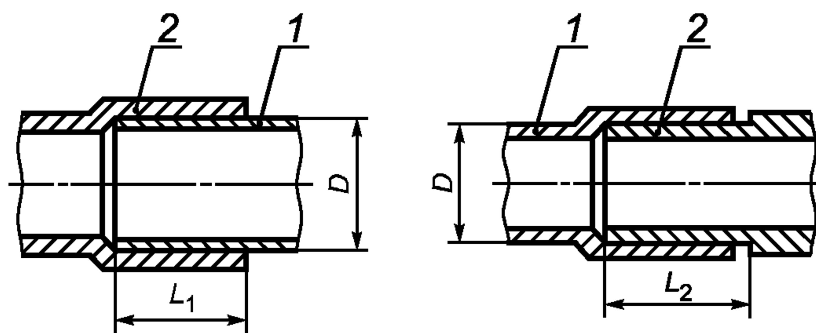
1 — труба; 2 — фитинг;  $D$  — номинальный диаметр соединяемых труб;  $L_1$  — длина внутреннего участка под пайку для фитинга, охватывающего трубу в соединении;  $L_2$  — длина наружного участка под пайку для фитинга, охватываемого трубой в соединении
