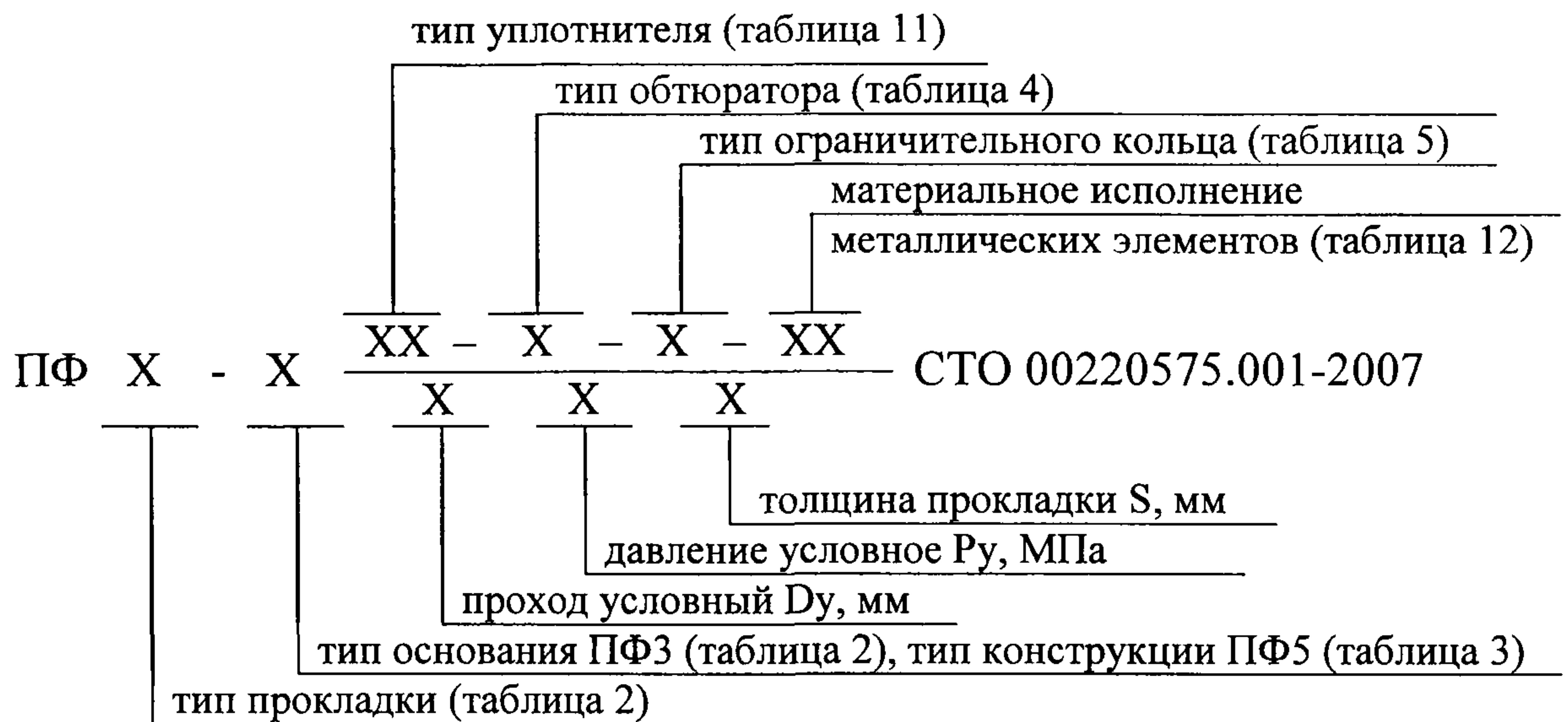
Пример условного обозначения прокладки типа ПФ1, тип уплотнителя 03 с обтюратором типа 1, с ограничителем сжатия типа 1, материалным исполнением типа 2, условным проходом Dy 100 мм, давлением условным Ру 1,6 МПа, толщиной 2 мм:
