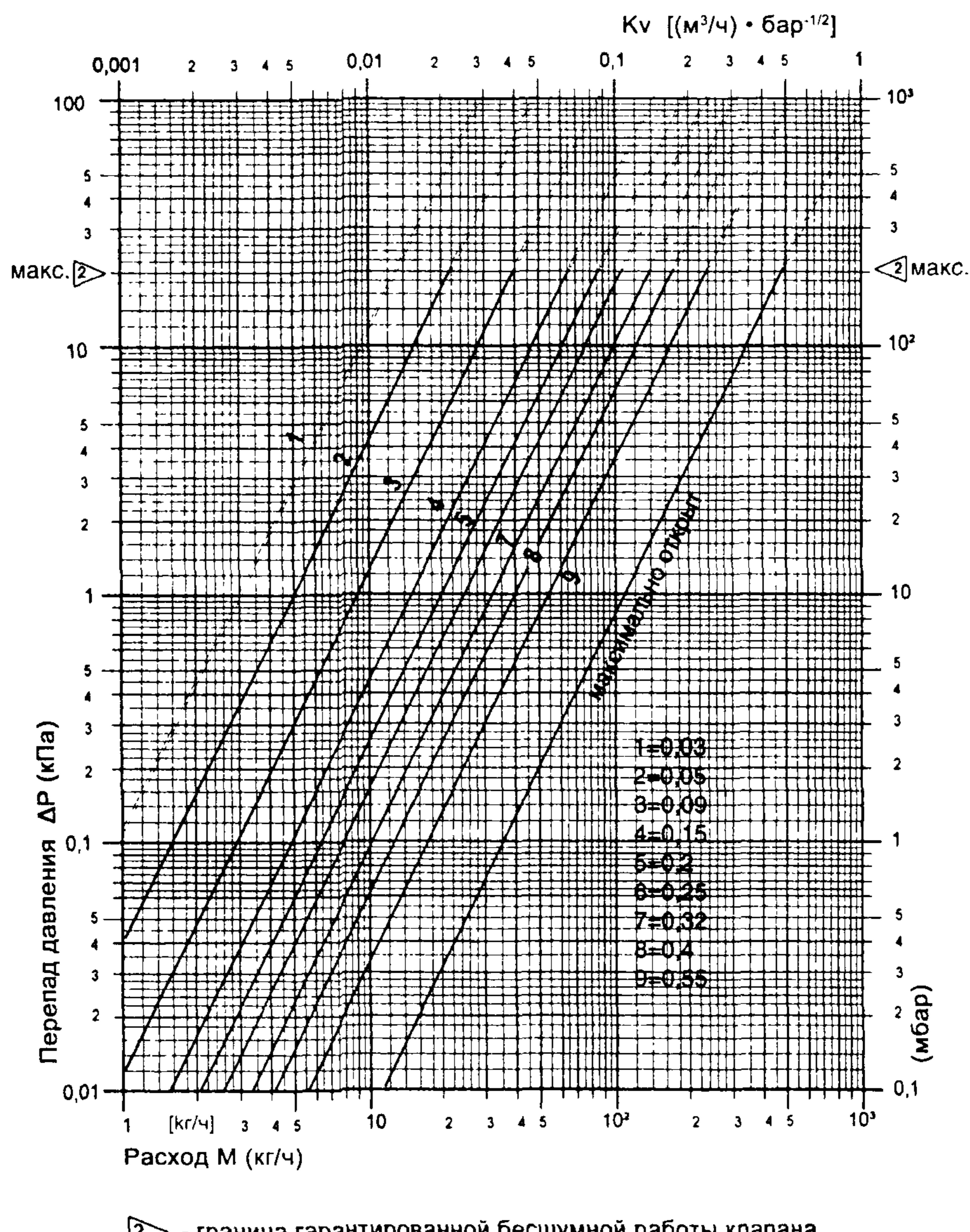
Рис. 3.1. Гидравлические характеристики термостатов «ГЕРЦ-TS-90-V» с присоединительными размерами 3/8" и 1/2" с настройкой на режим 2К ( $2^{\circ}\text{C}$ ) и при снятой терmostатической головке (при полном открытии вентиля)
