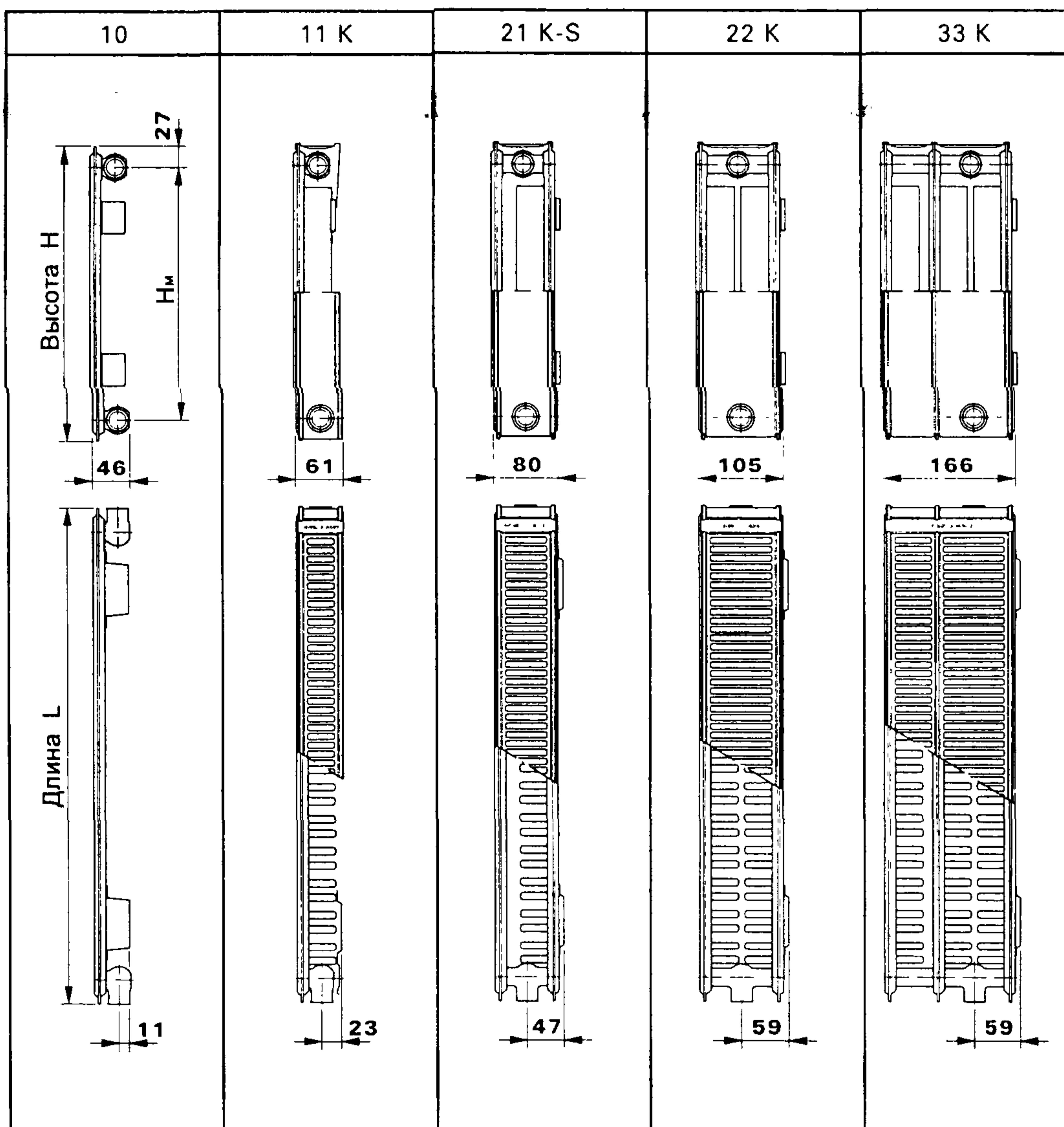
Рис. 1.2. Номенклатура радиаторов «VONOVA Kompakt»
