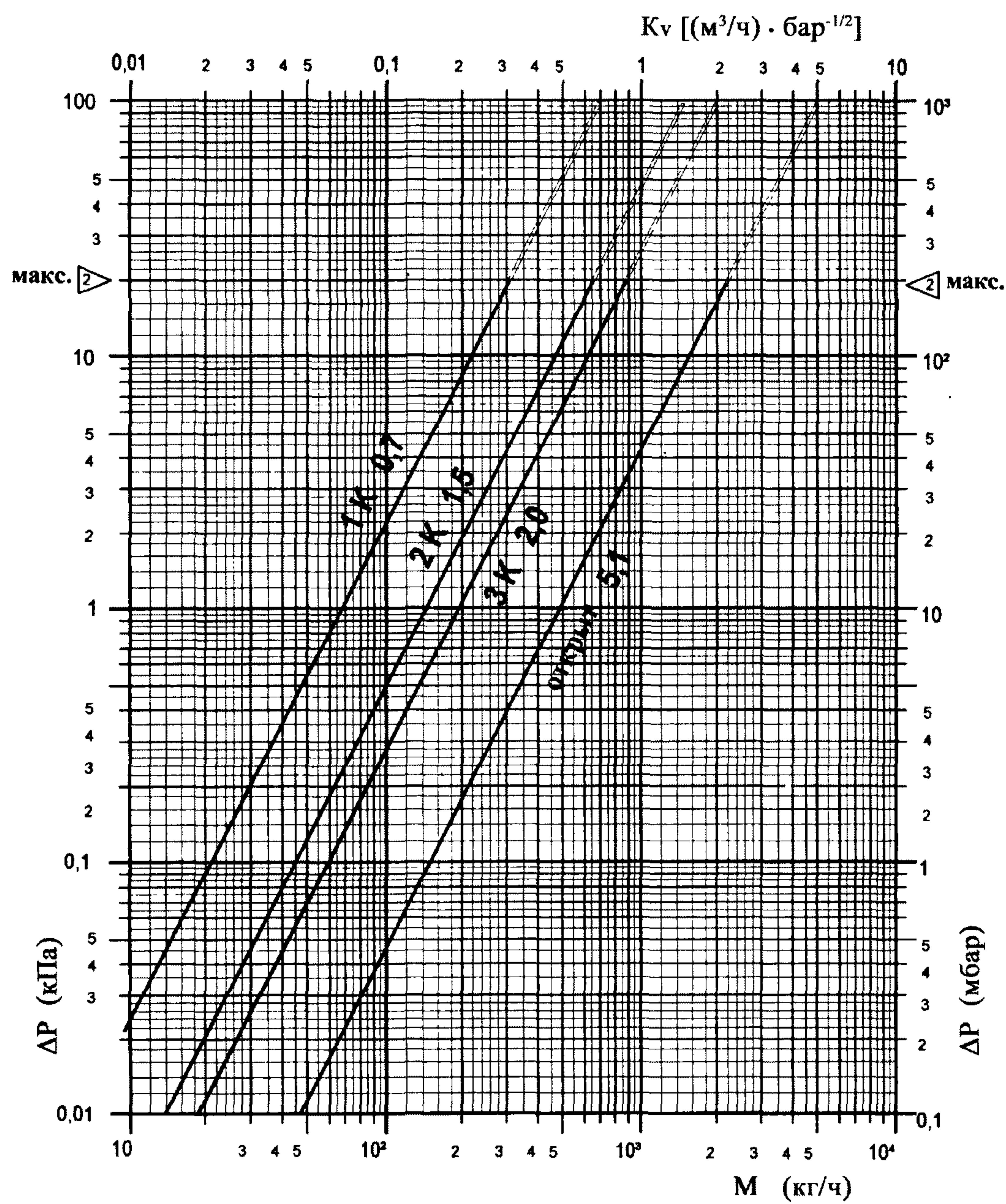
Рис. 3.2. Гидравлические характеристики терmostатов «ГЕРЦ-TS-E» при различных режимах настройки
