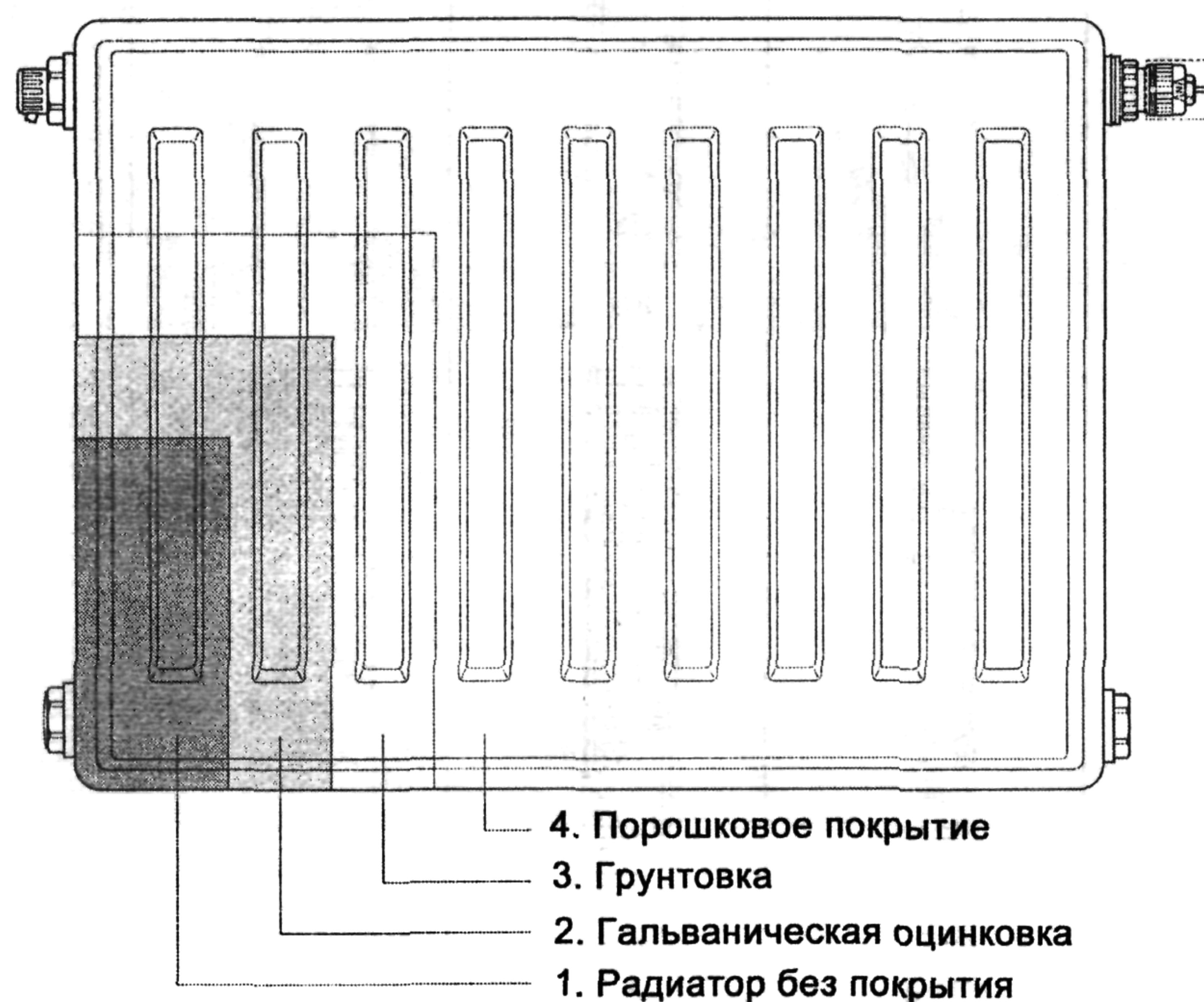
Рис. 1.3. Последовательность покрытия оцинкованных радиаторов «VONOVA»
