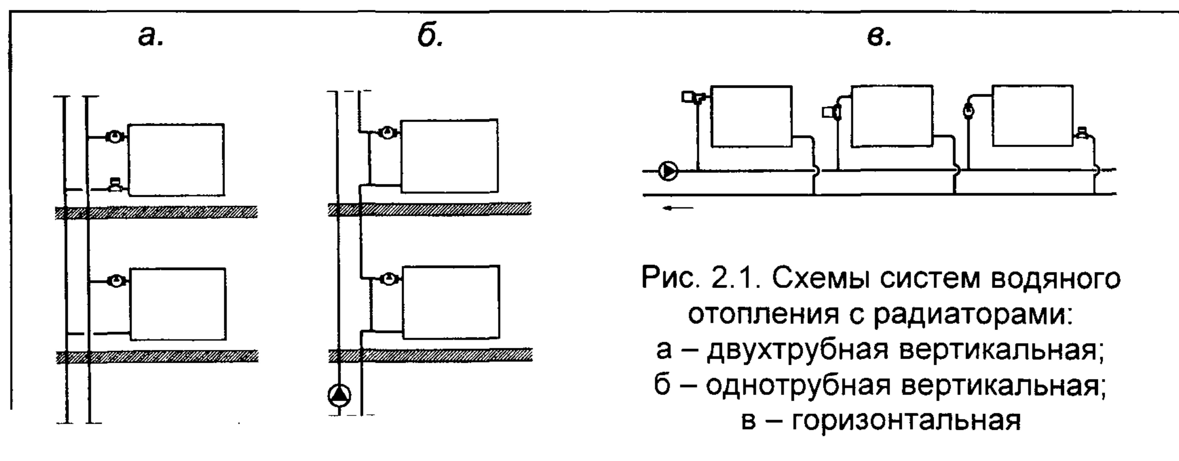
Рис. 2.1. Схемы систем водяного отопления с радиаторами:
