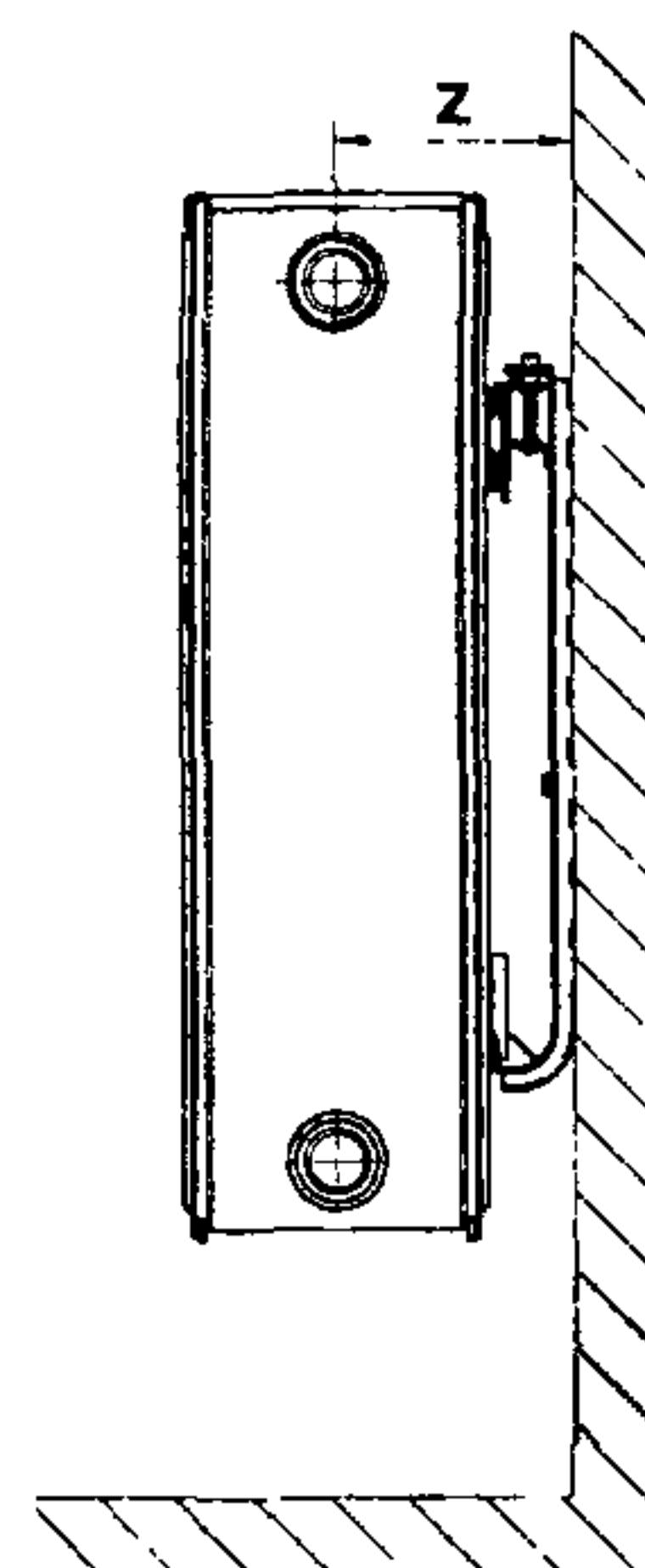
Рис. 6.2. Установка радиатора «VONOVA Komпakt» на стене на кронштейнах-консолях «Vonomat»
