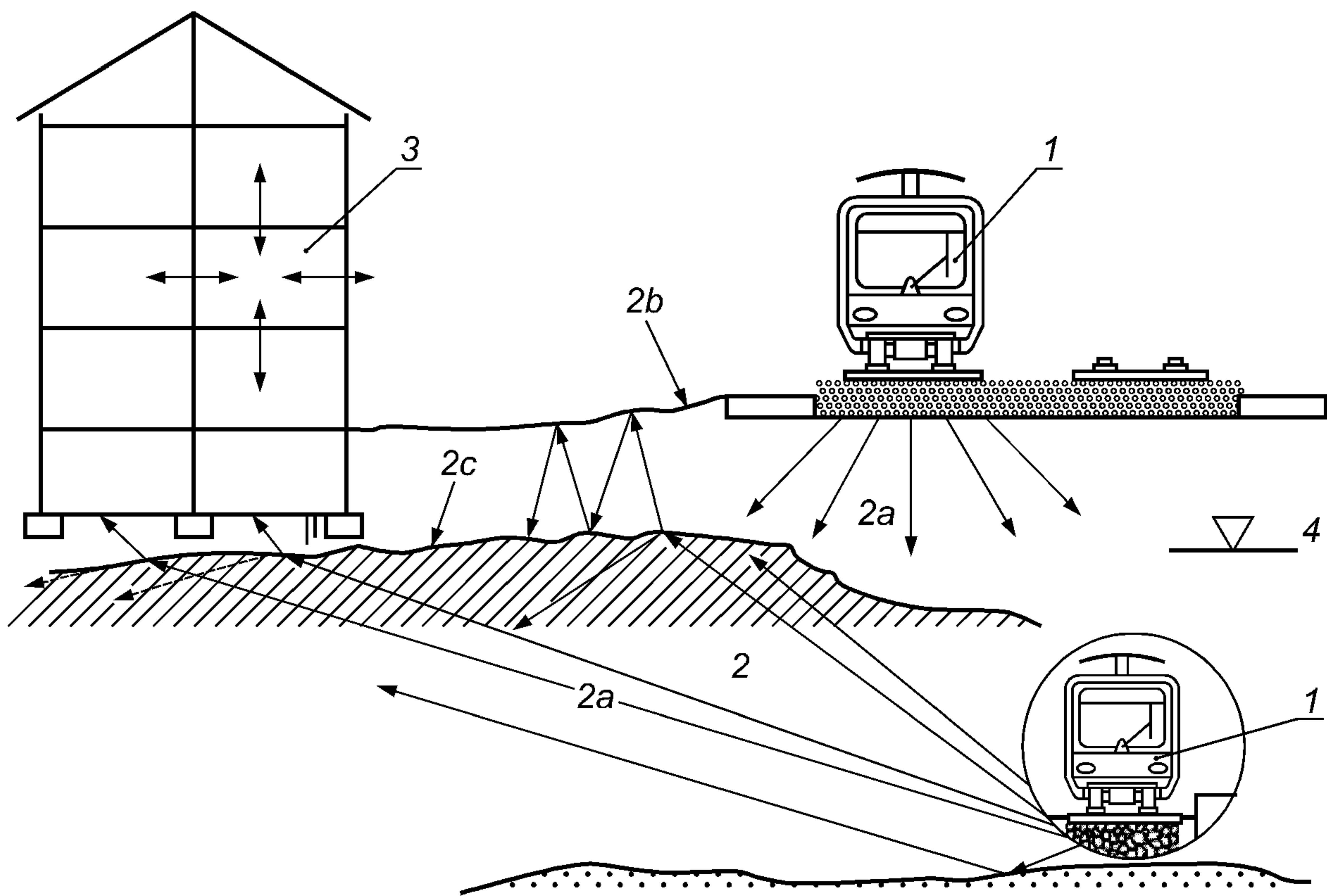
1 — источник вибрации; 2 — путь распространения (2а — волны внутри тела: сжатия, сдвига; 2б — поверхностные волны: Рэлея, Лява; 2с — волны на границе сред: Стоунли); 3 — объект воздействия (вибрация, переизлученный шум);
