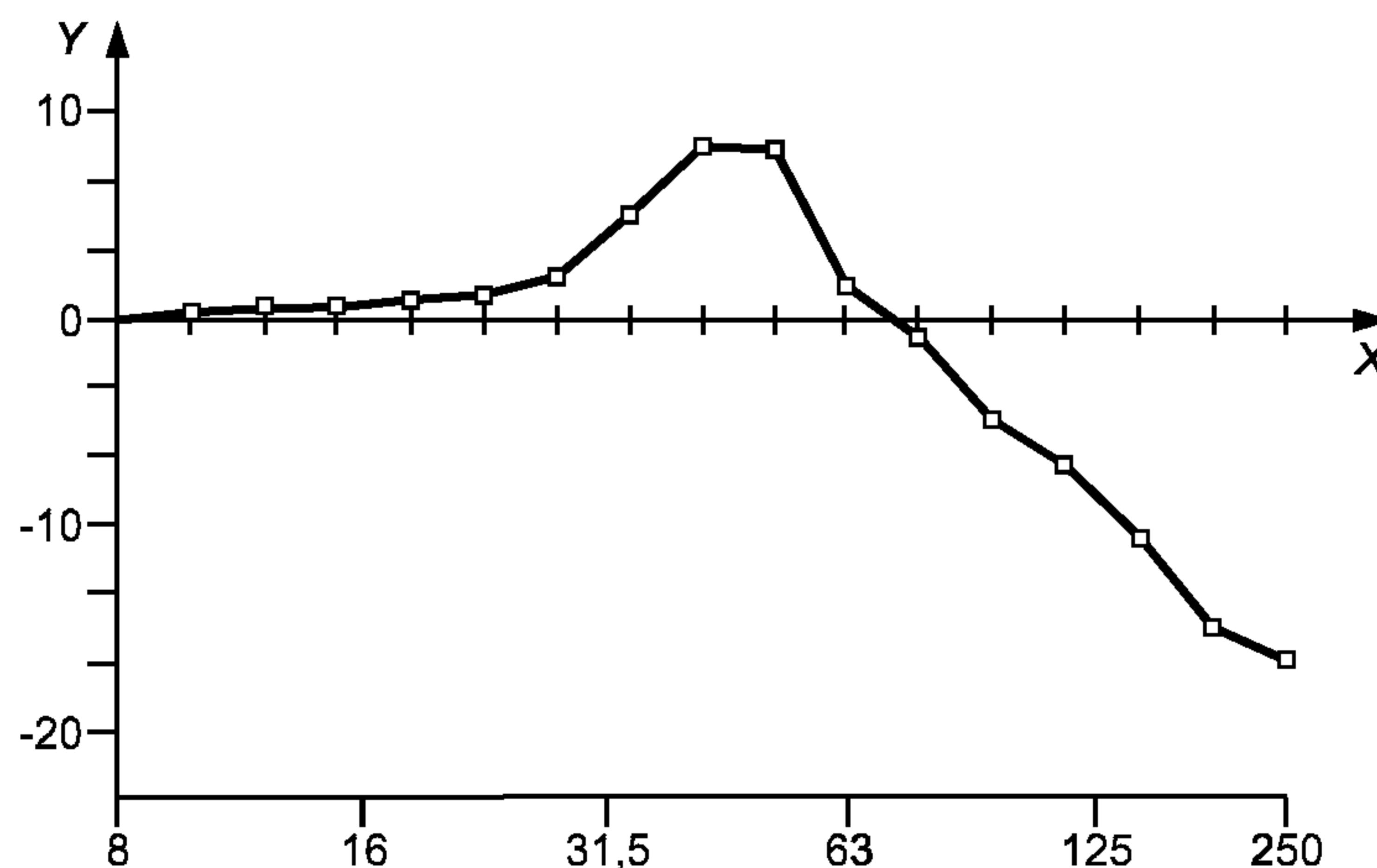
$X$  — частота, Гц (отложены среднегеометрические частоты третьоктавных фильтров);  $Y$  — вносимое усиление вибрации (относительно эталонного рельсового пути), дБ
