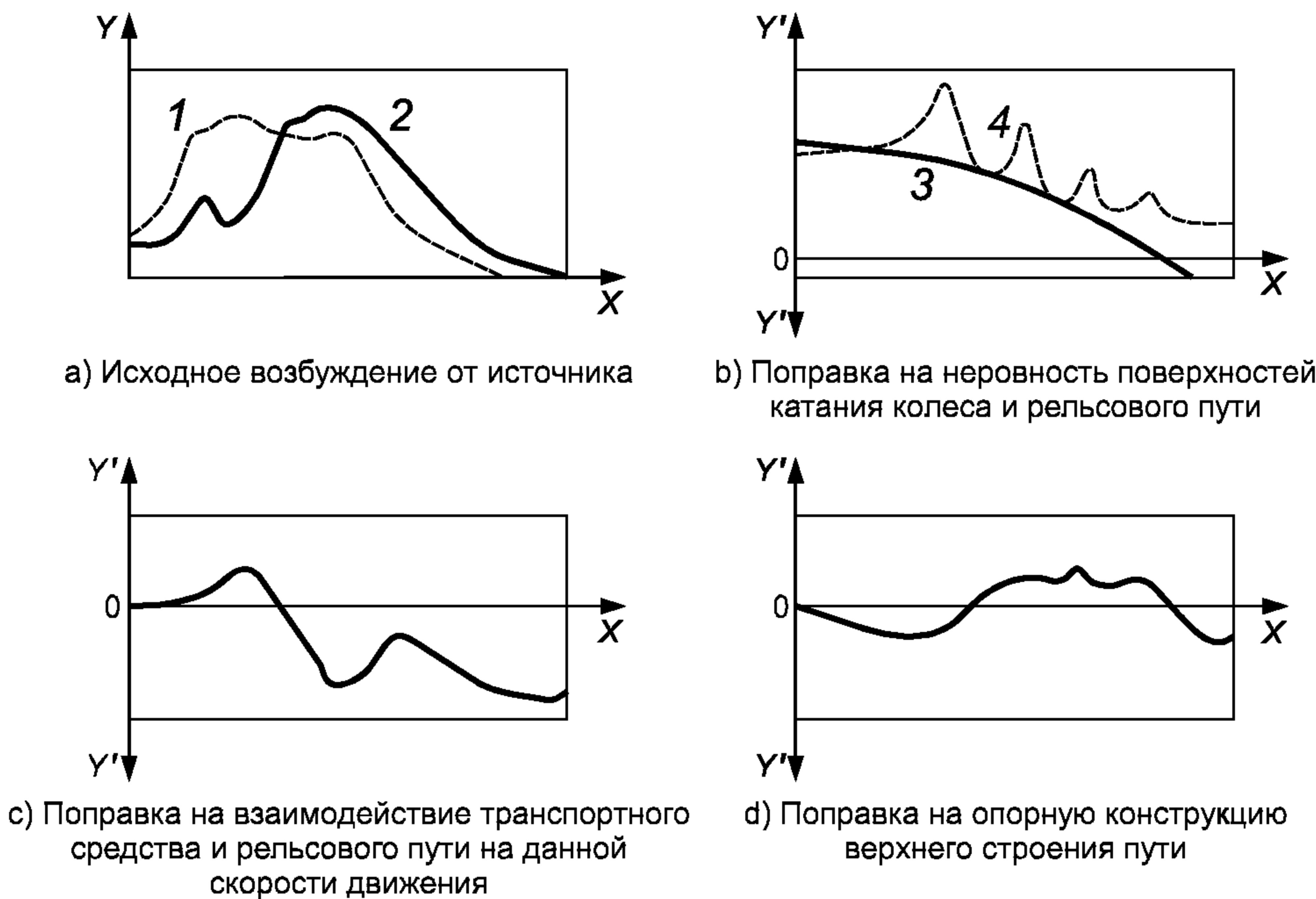
$X$  — частота (в логарифмическом масштабе);  $Y$  — функция возбуждения (в логарифмическом масштабе);  $Y'$  — поправка для функции возбуждения (в логарифмическом масштабе); 1 — мягкий грунт; 2 — скальный грунт; 3 — хорошее состояние поверхностей катания; 4 — поверхности катания с выбоинами
