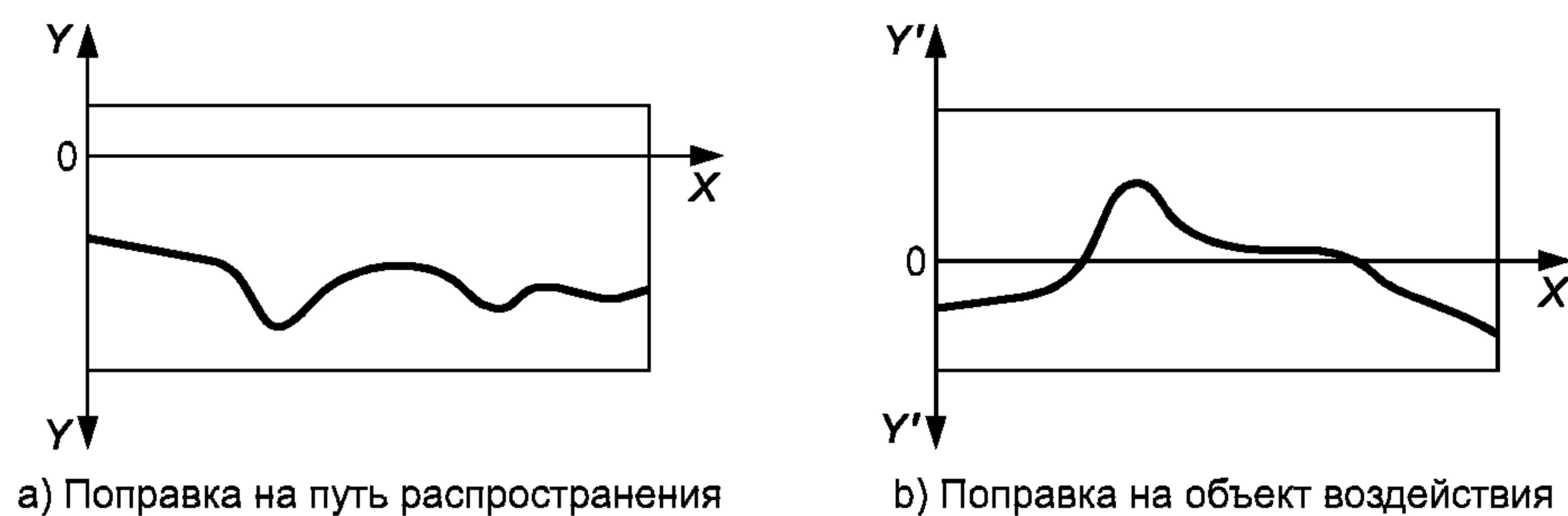
$X$  — частота (в логарифмическом масштабе);  $Y$  — поправка для функции возбуждения на пути распространения (в логарифмическом масштабе);  $Y'$  — поправка для функции возбуждения в объекте воздействия (в логарифмическом масштабе)
