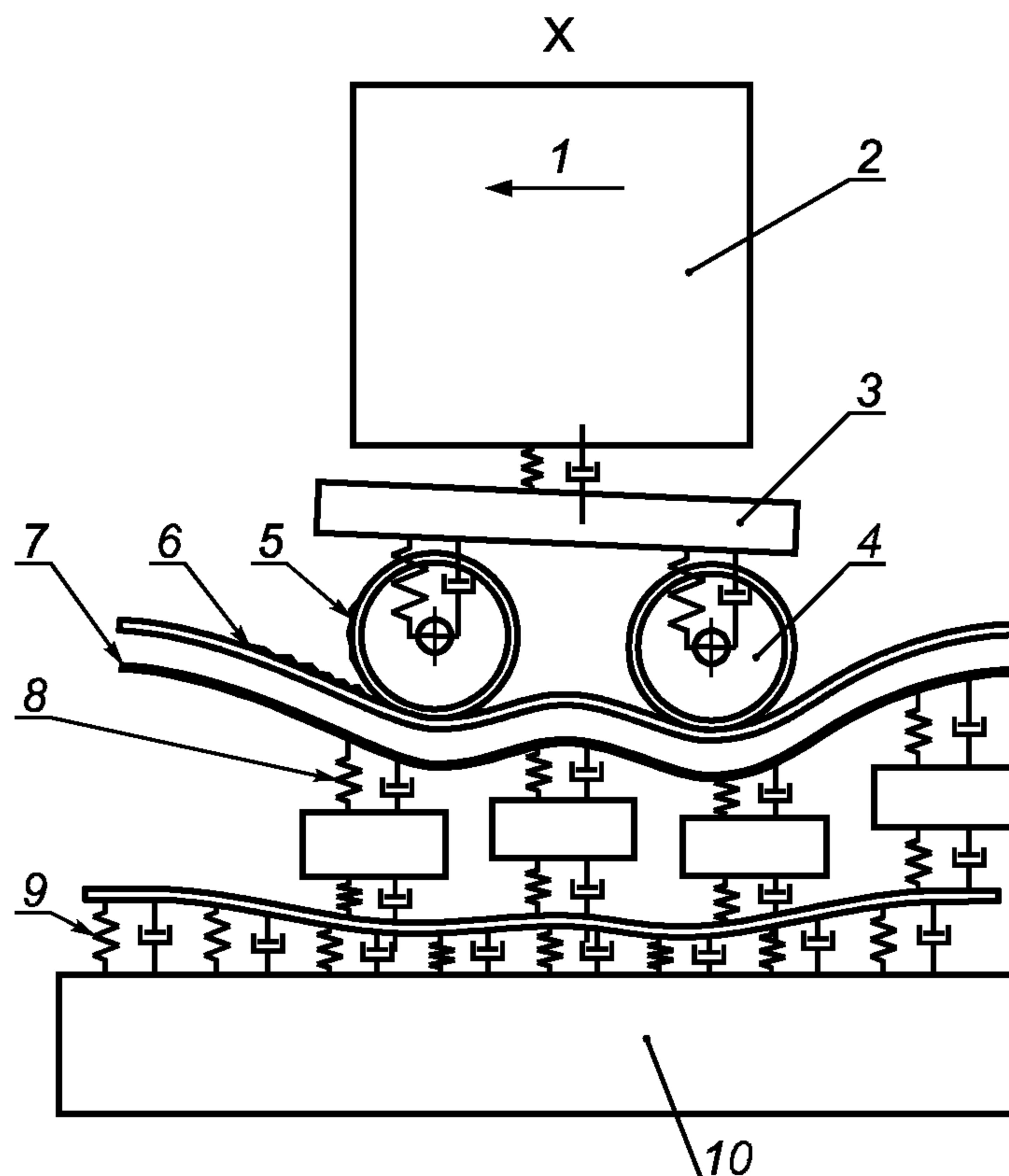
1 — скорость движения  $v$ ; 2 — часть массы кузова  $m_C$ ; 3 — часть массы тележки  $m_B$ ; 4 — неподрессоренная масса  $m_W$ ; 5 — неровность поверхности обода колеса; 6 — неровность поверхности катания рельса; 7 — импеданс рельса; 8 — модель системы «рельс — колесо»; 9 — модель системы «основание — рельс»; 10 — импеданс грунта
