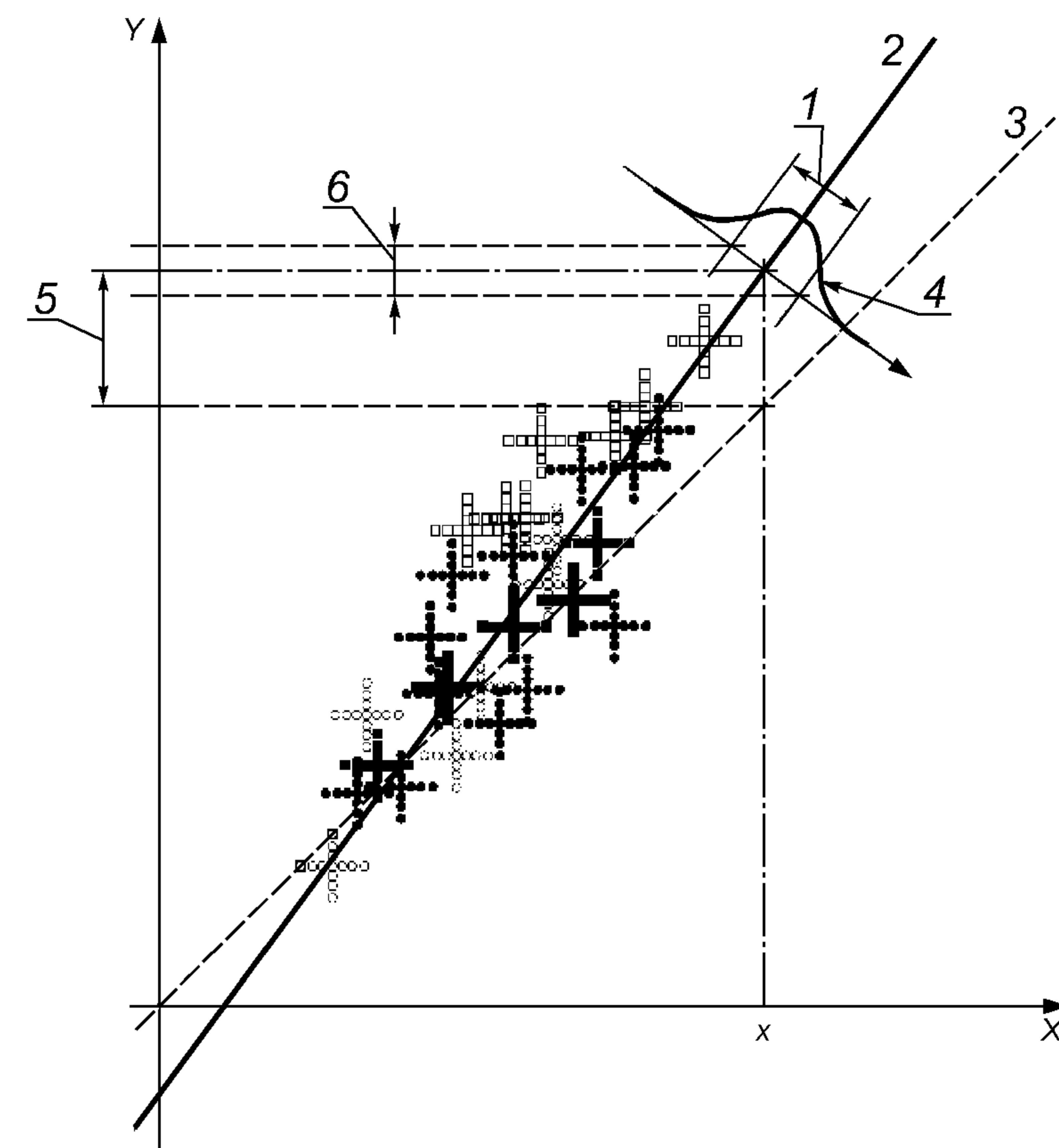
$X$  — измеренное значение;  $Y$  — прогнозное значение; 1 — интервал, равный удвоенному стандартному отклонению; 2 — реальная градуировочная кривая; 3 — градуировочная кривая, полученная путем подгонки данных; 4 — статистическое распределение выборочных значений; 5 — систематическая погрешность градуировочной характеристики на уровне  $x$ ; 6 — случайная погрешность прогноза на уровне  $x$
