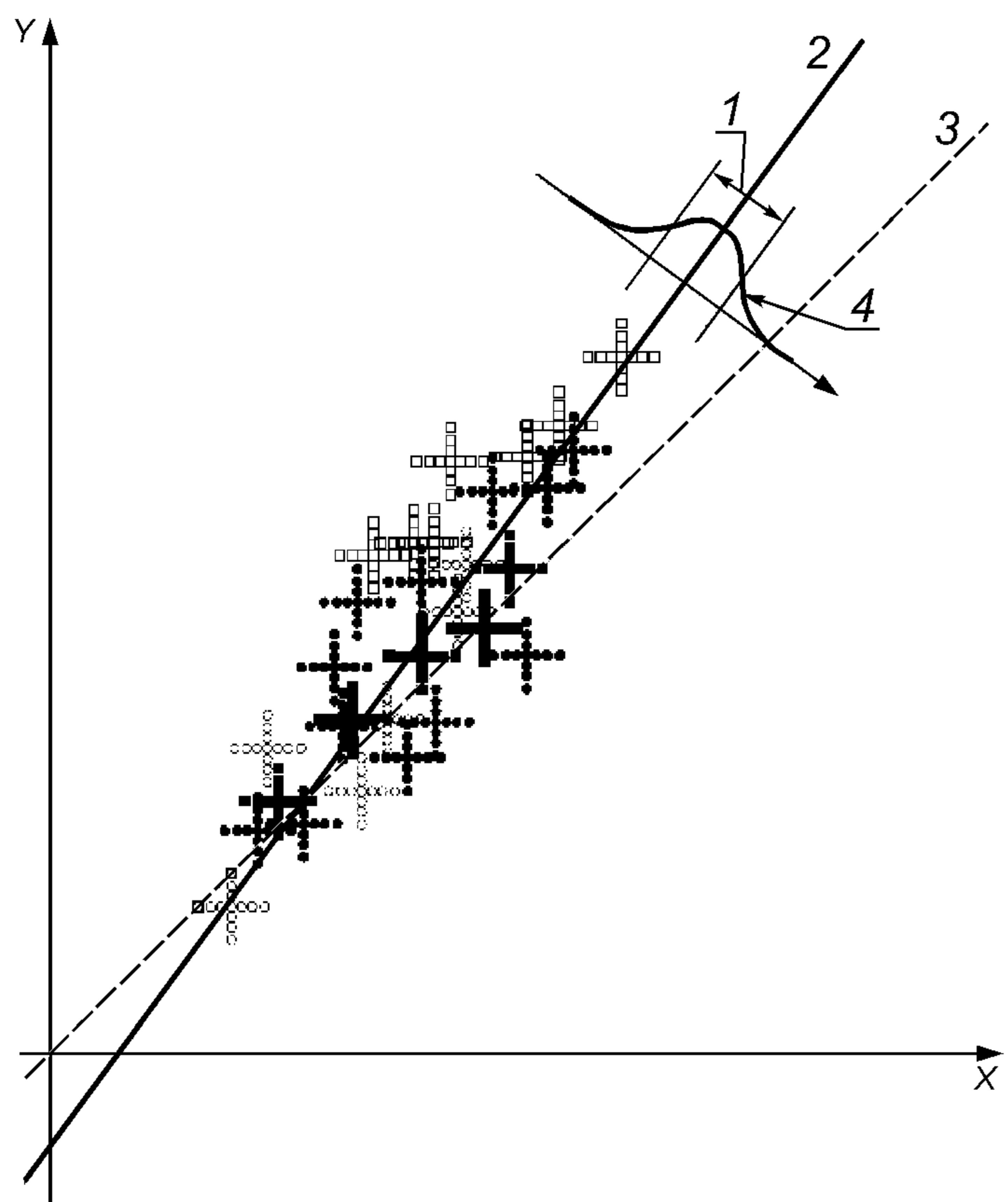
$X$  — измеренное значение;  $Y$  — прогнозное значение; 1 — интервал, равный удвоенному стандартному отклонению; 2 — реальная градуировочная кривая; 3 — градуировочная кривая, полученная путем подгонки данных; 4 — статистическое распределение выборочных значений
