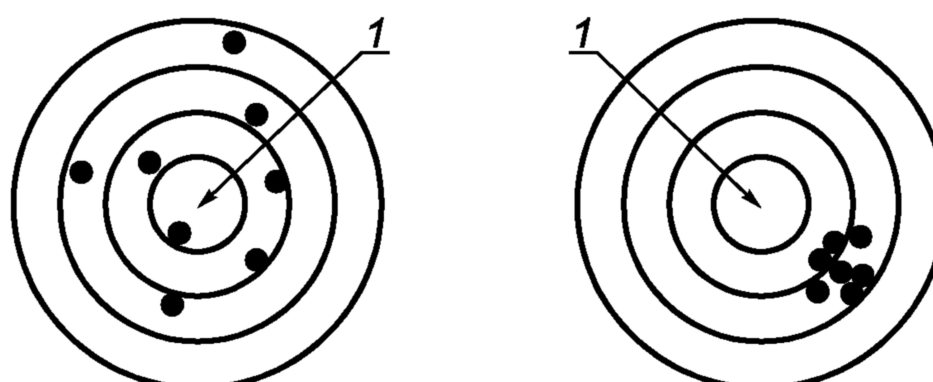
a) Преобладает случайная погрешность      b) Преобладает систематическая погрешность
