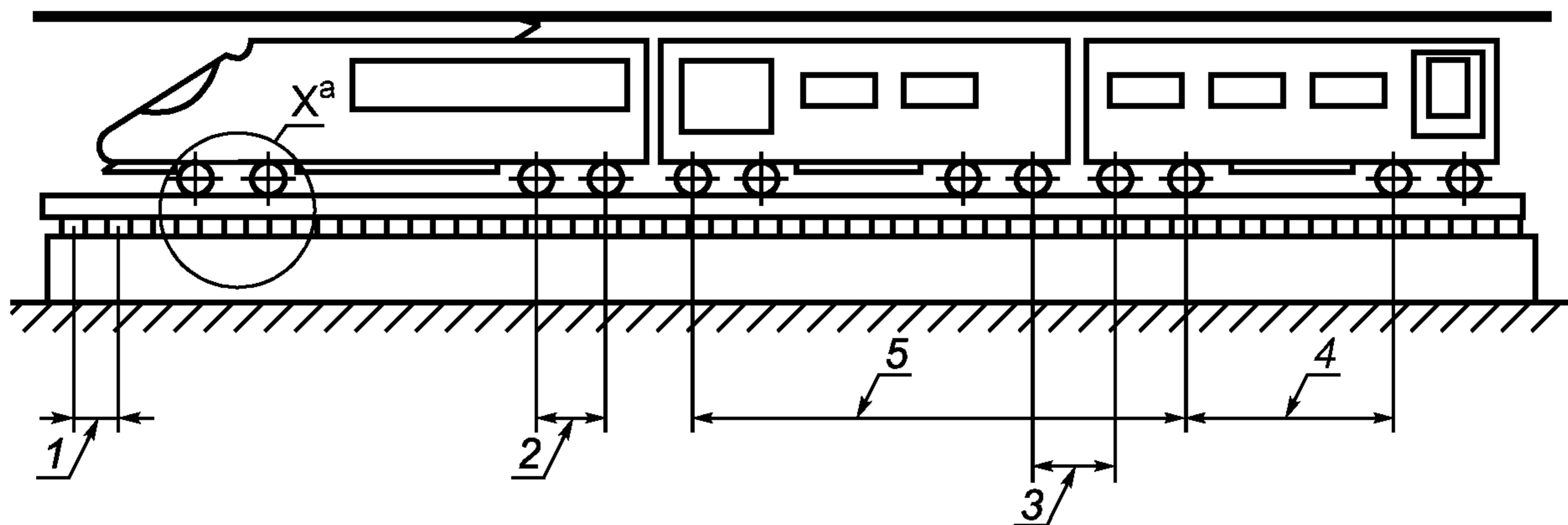
1 — расстояние между опорными элементами пути; 2 — расстояние между колесными парами тележки; 3 — расстояние между соседними тележками соседних вагонов; 4 — расстояние между тележками одного вагона; 5 — междугонное расстояние
