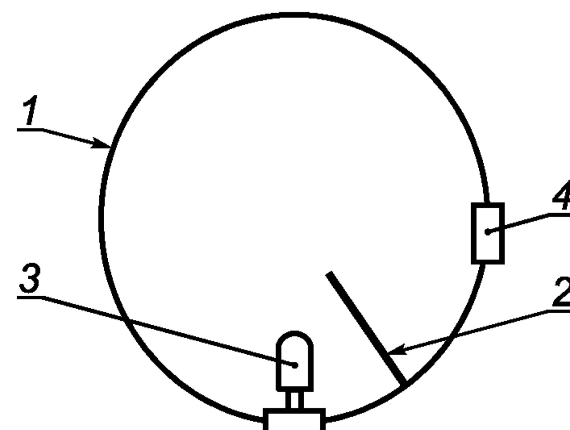
1 — интегрирующая сфера; 2 — непрозрачный рассеивающий экран; 3 — лазер; 4 — калибранный первичный измерительный преобразователь
