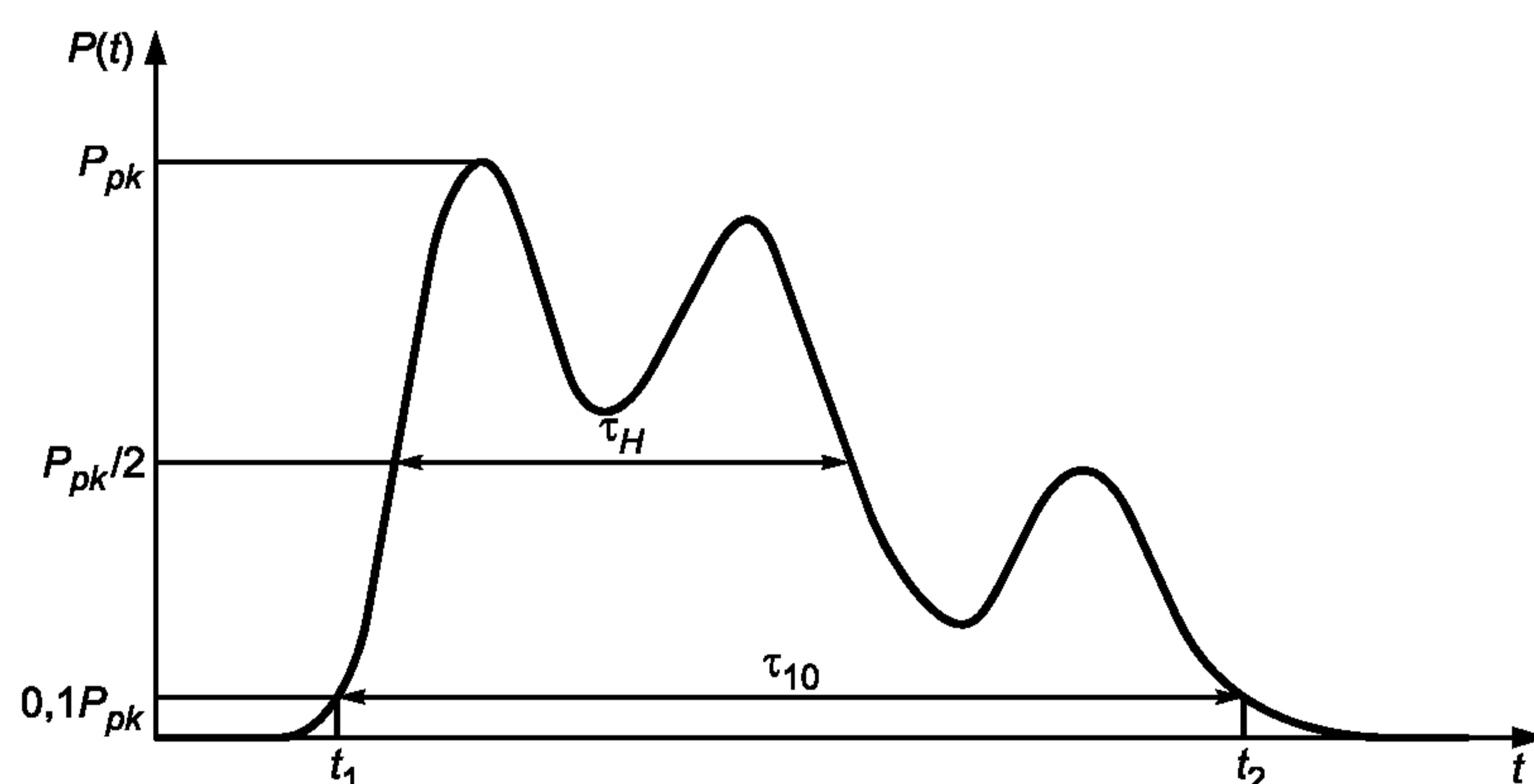
Рисунок 3 — Форма импульса  $P(t)$
