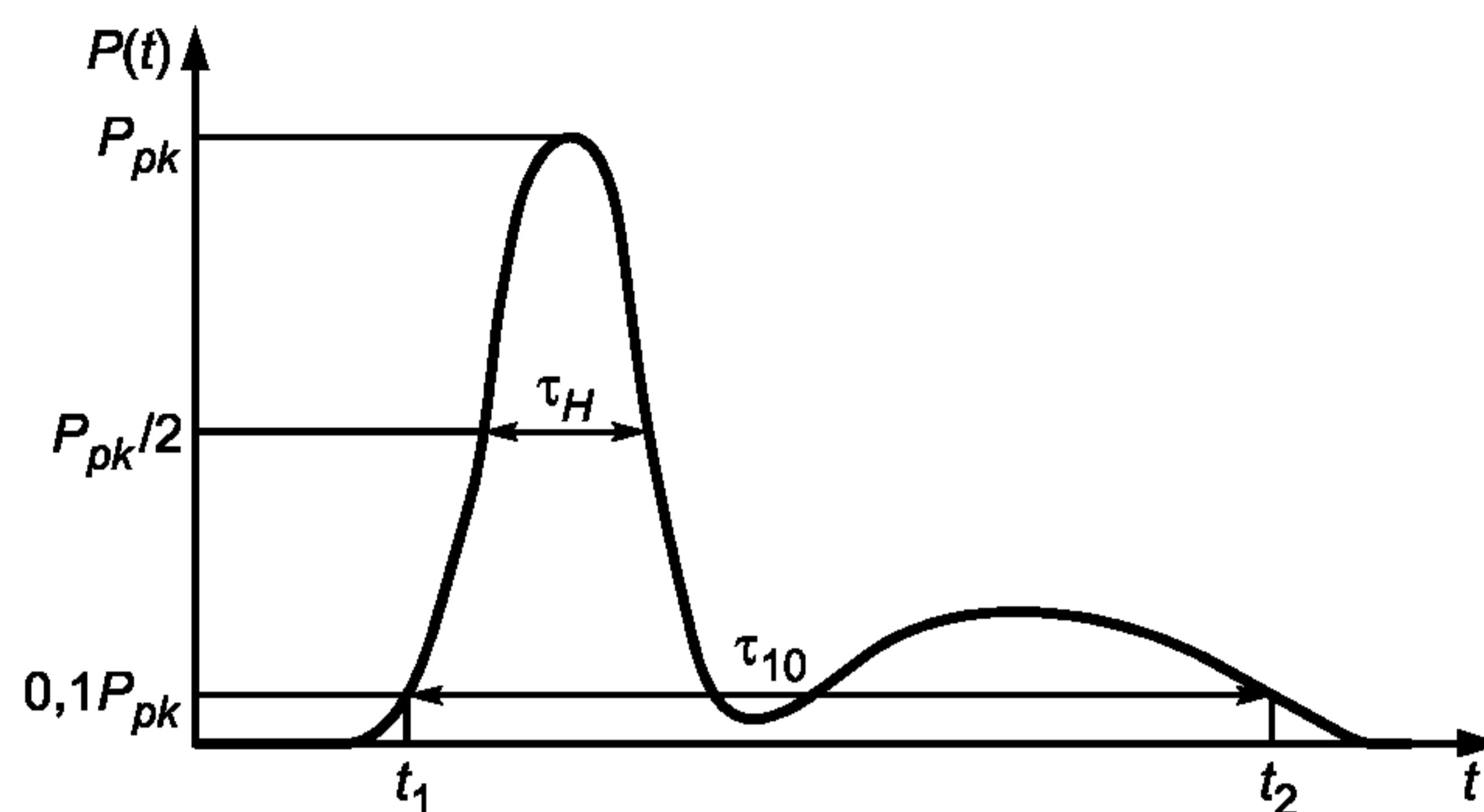
Рисунок 4 — Форма импульса *TEA* лазера
