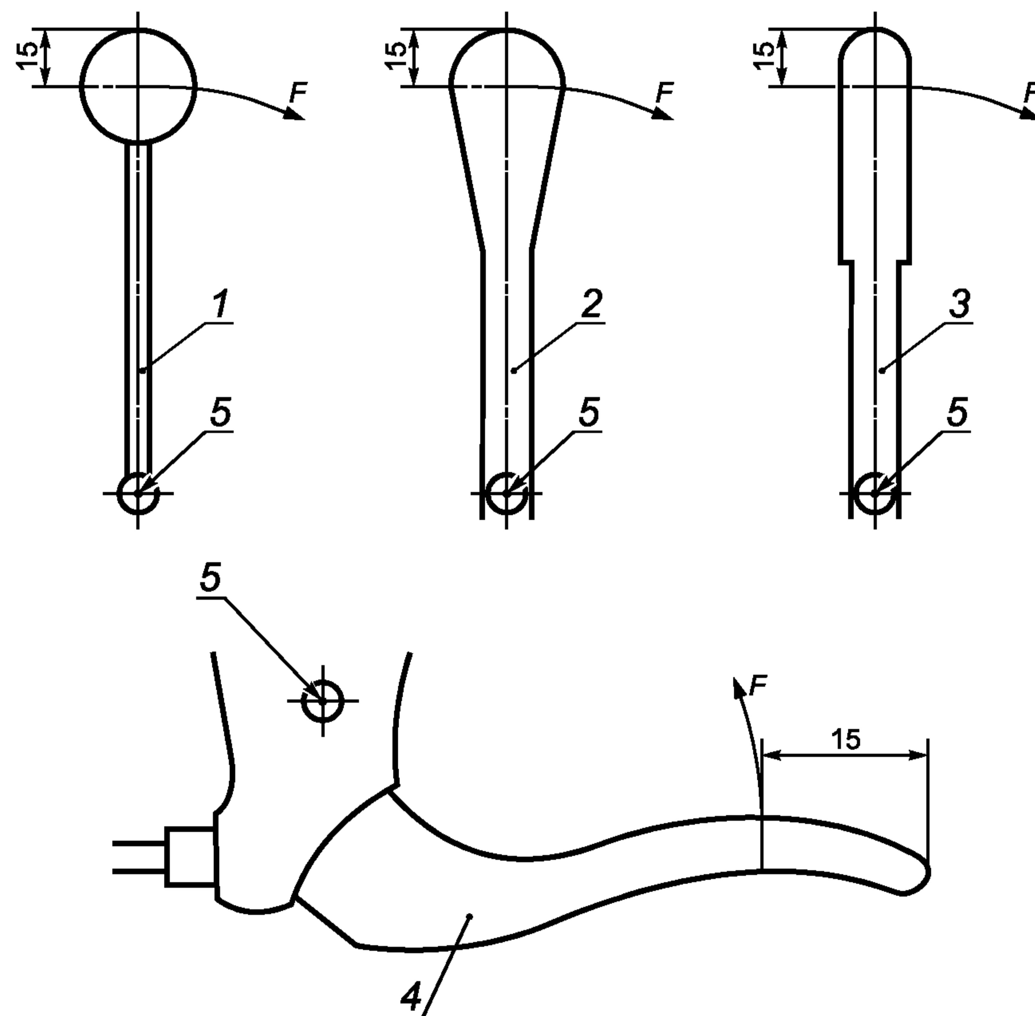
1 — рычаг со сферической головкой; 2 — рычаг с конусообразной головкой; 3 — рычаг с цилиндрической головкой;
