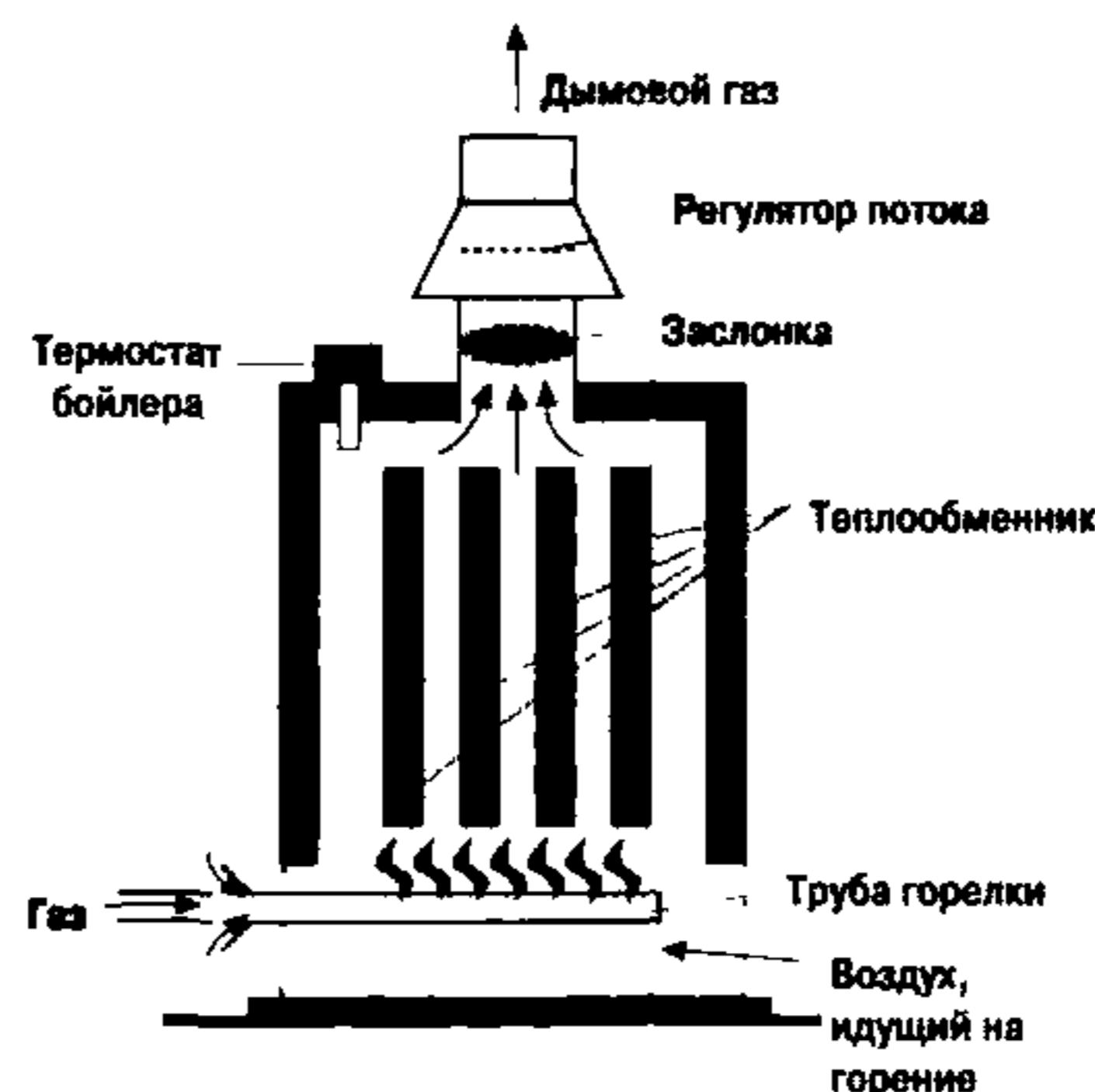
Рис. 7: Отопительная система с атмосферной горелкой
