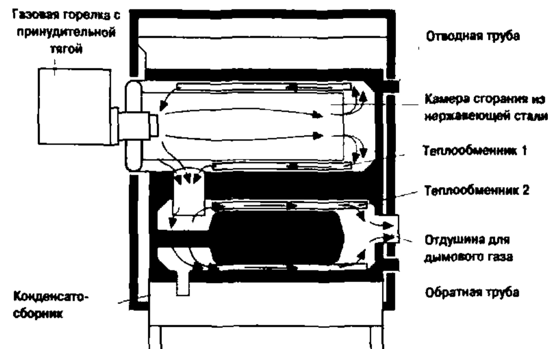
Рис. 8: Конструкция газового конденсационного котла
