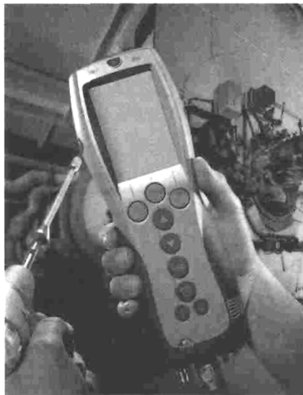
Рис. 19: Прибор testo 335 первый на рынке 3-х компонентный прибор с возможностью прямого измерения  $\text{NO}_x$
