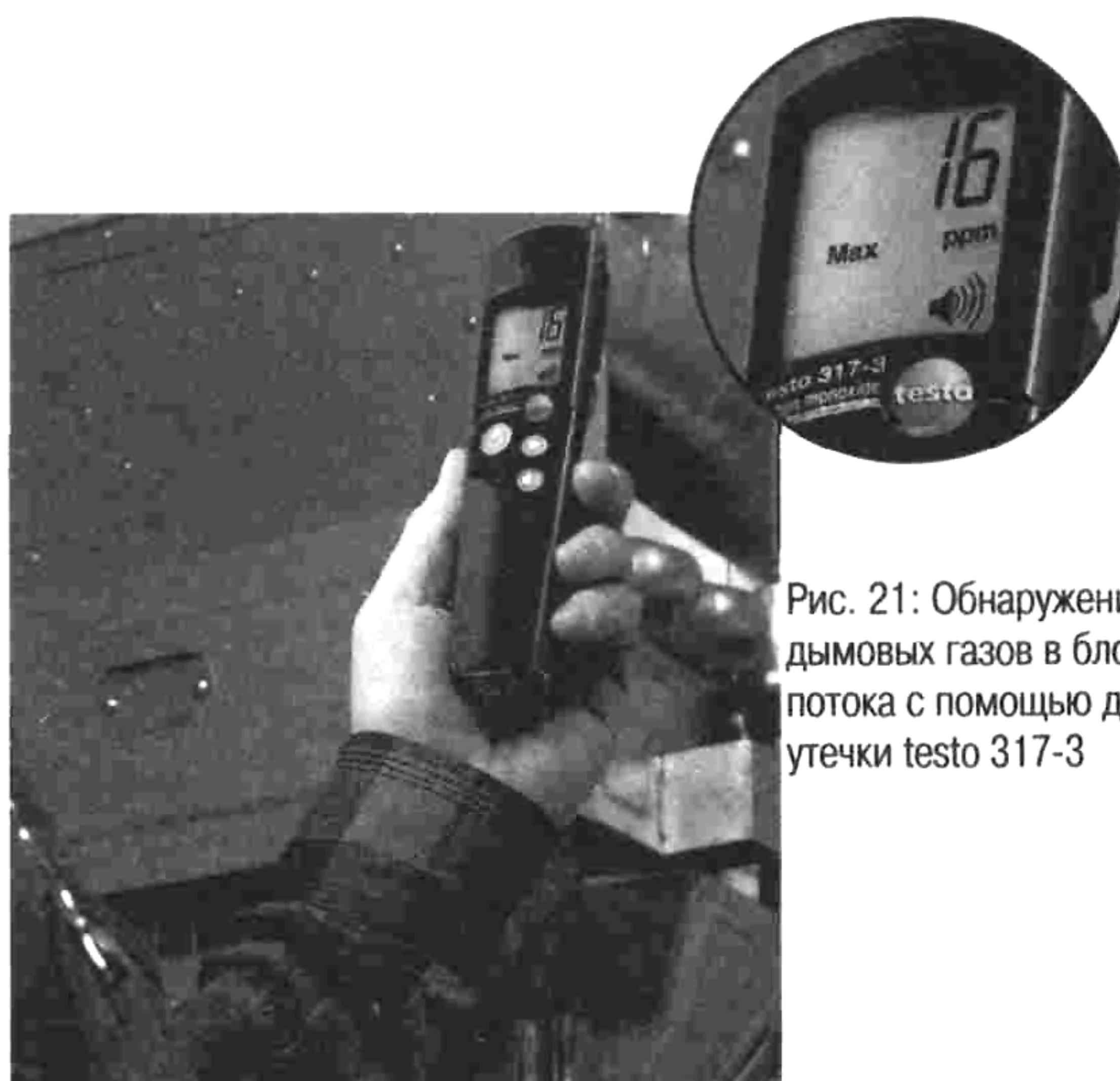
Рис. 21: Обнаружение утечки дымовых газов в блоке контроля потока с помощью детектора утечки testo 317-3
