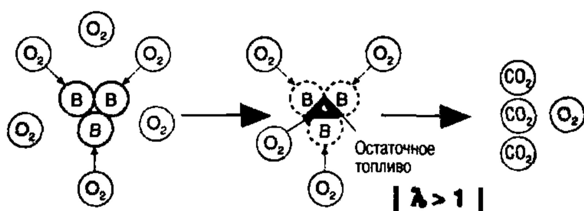
Рис. 4: Реальный процесс сгорания
