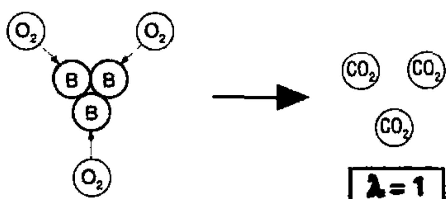
Рис. 3: Идеальный процесс сгорания
