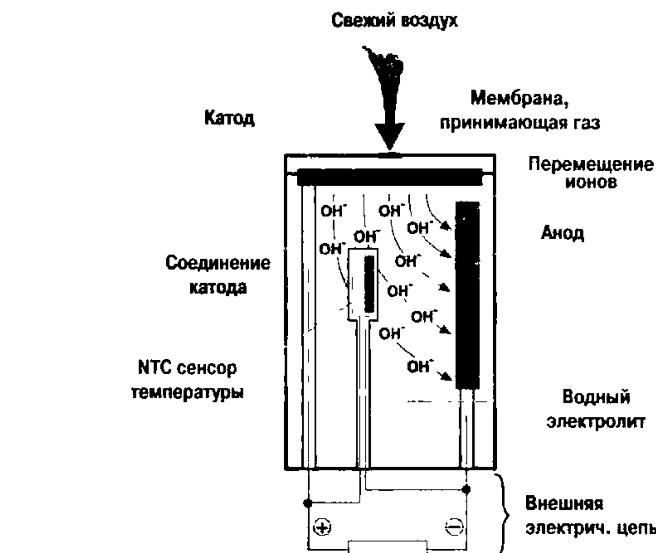
Рис. 27: Принцип работы сенсора  $O_2$ **Принцип работы сенсора кислорода в ключевых словах:**
