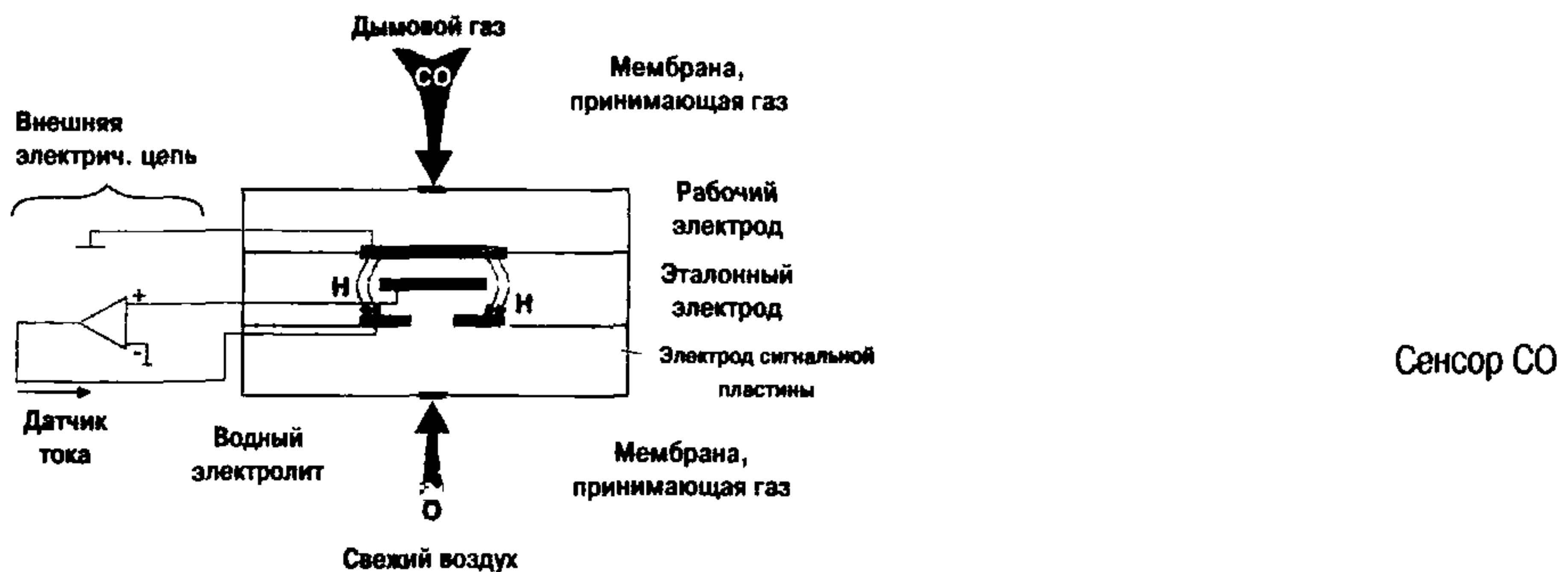
Рис. 28: Принцип работы сенсора CO
