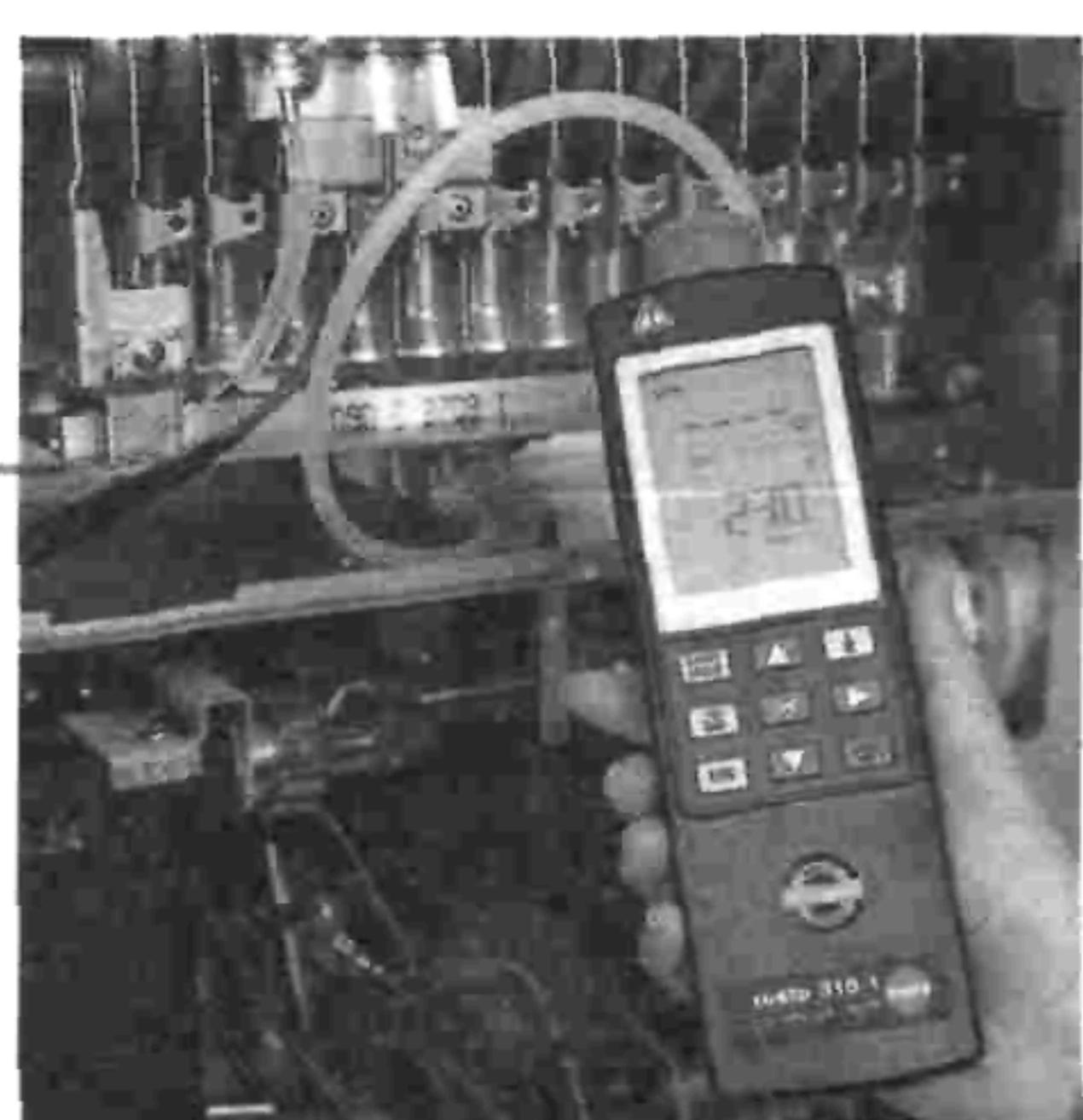
Испытание на герметичность с
