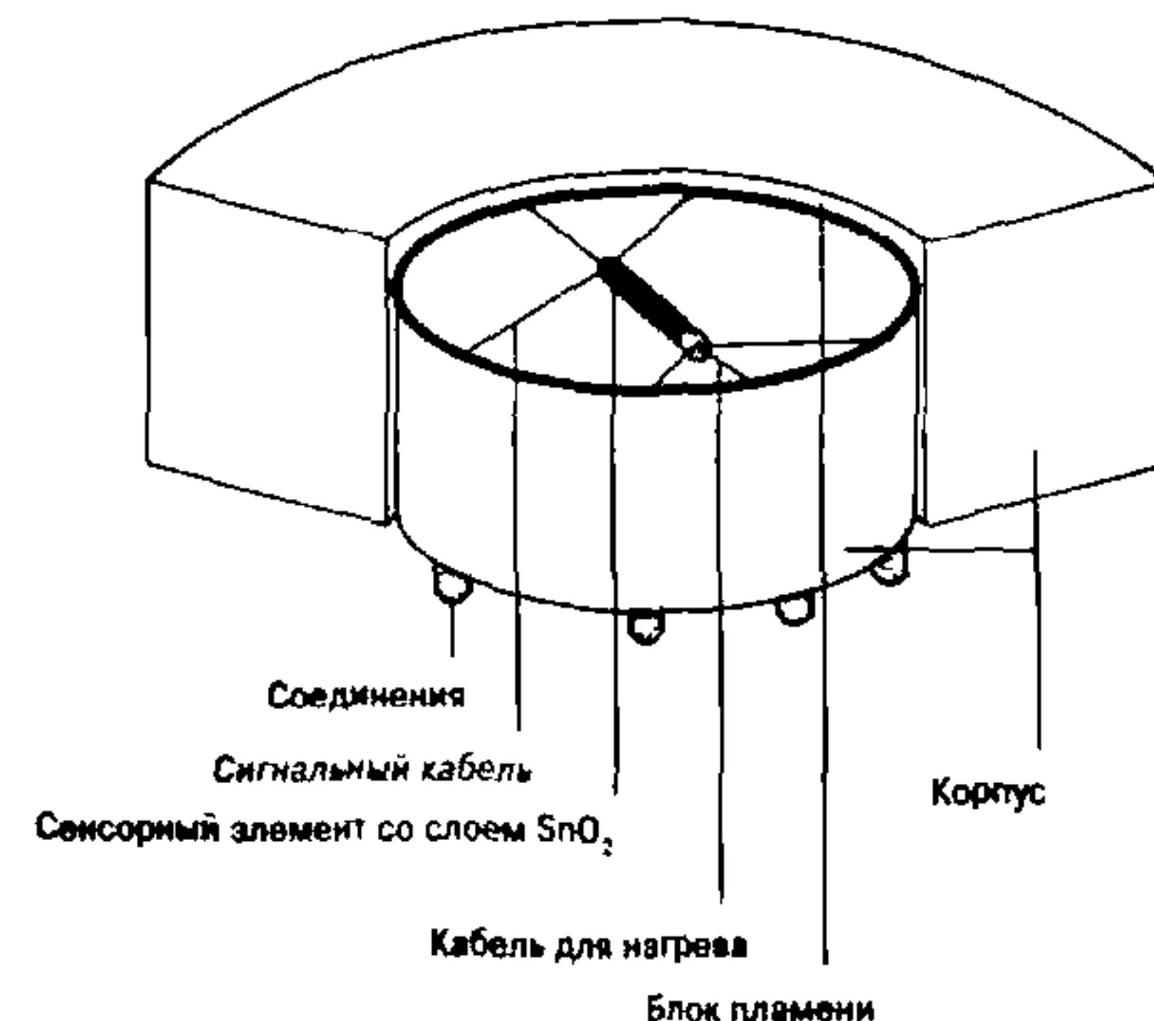
Рис. 29: Конструкция полупроводникового сенсора
