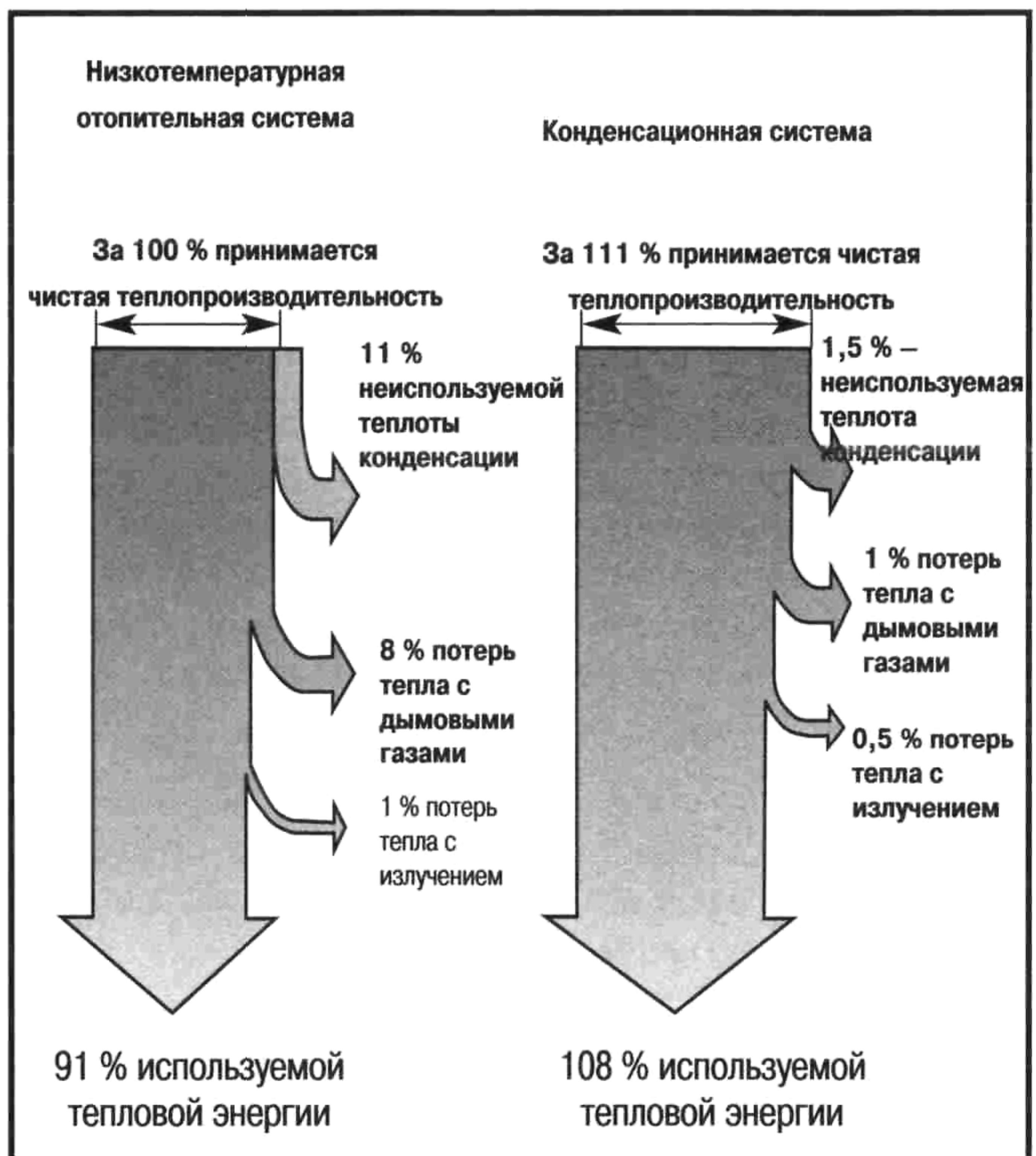
Рис. 17: Потеря энергии в низкотемпературных и конденсационных системах.
