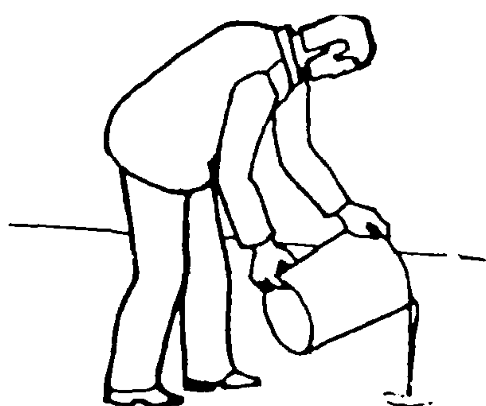
Рисунок 8 – Выливание клея из ведра
