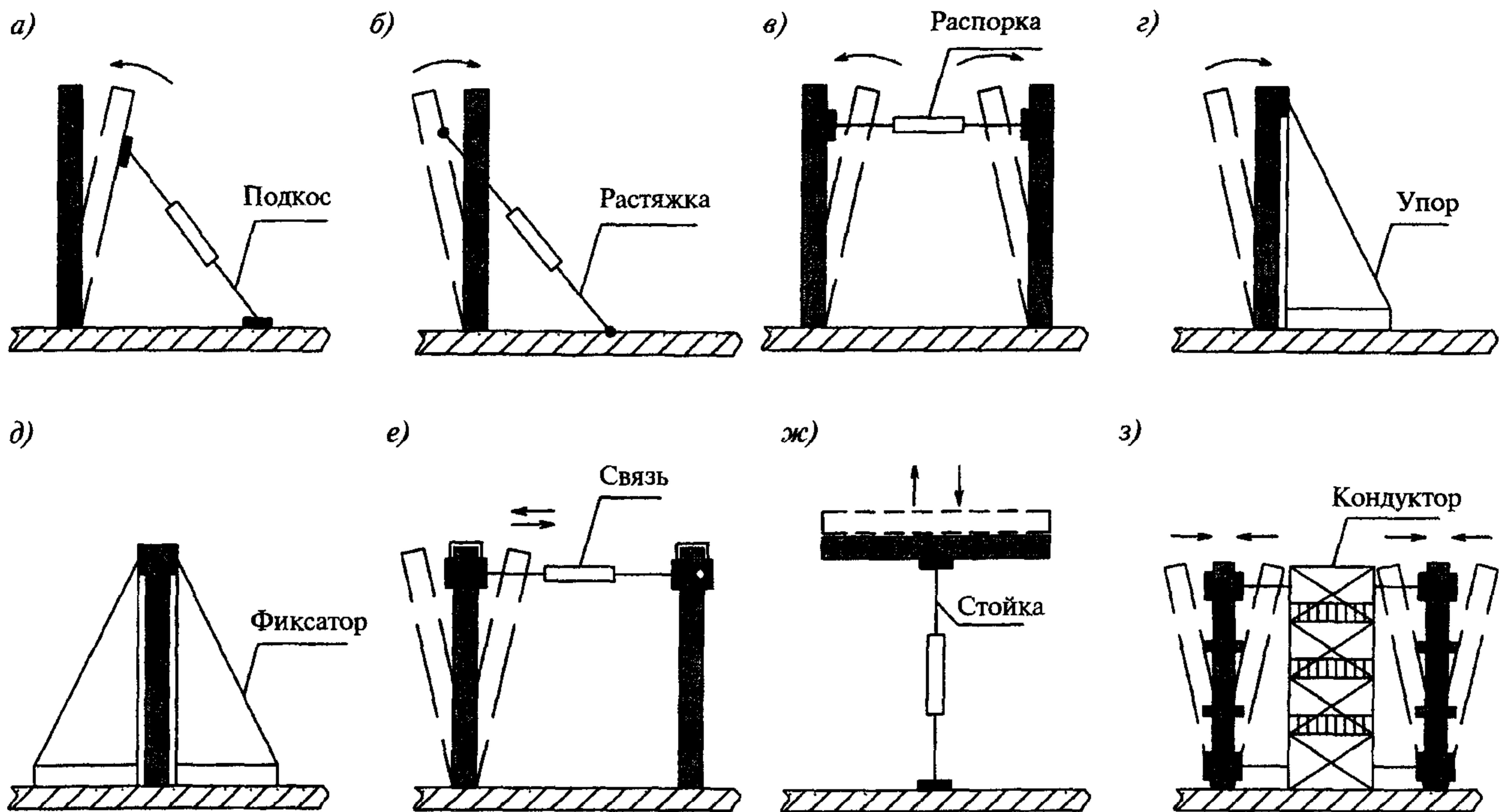
Рис. 1. Схемы монтажной оснастки
