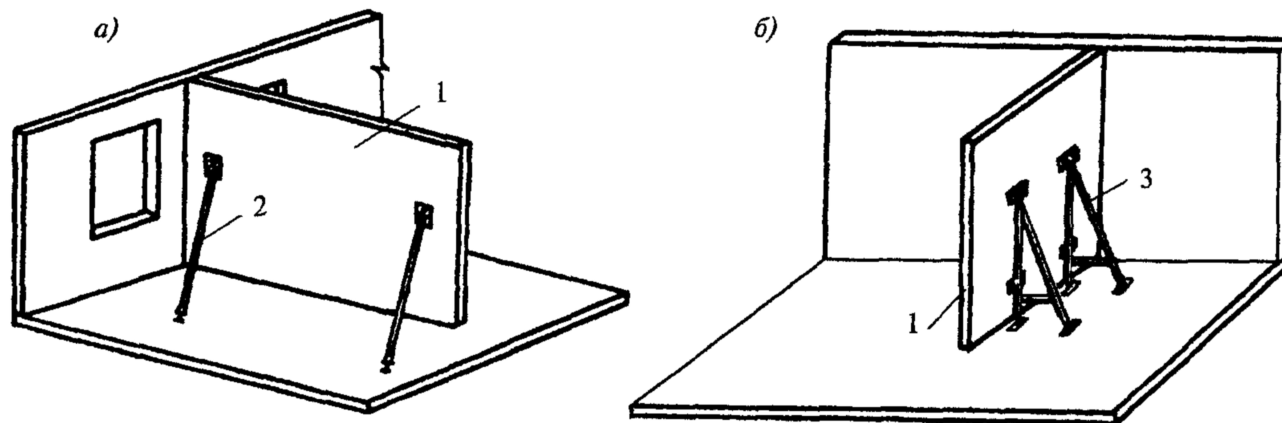
**Рис. 11. Временное закрепление панелей перегородок**
