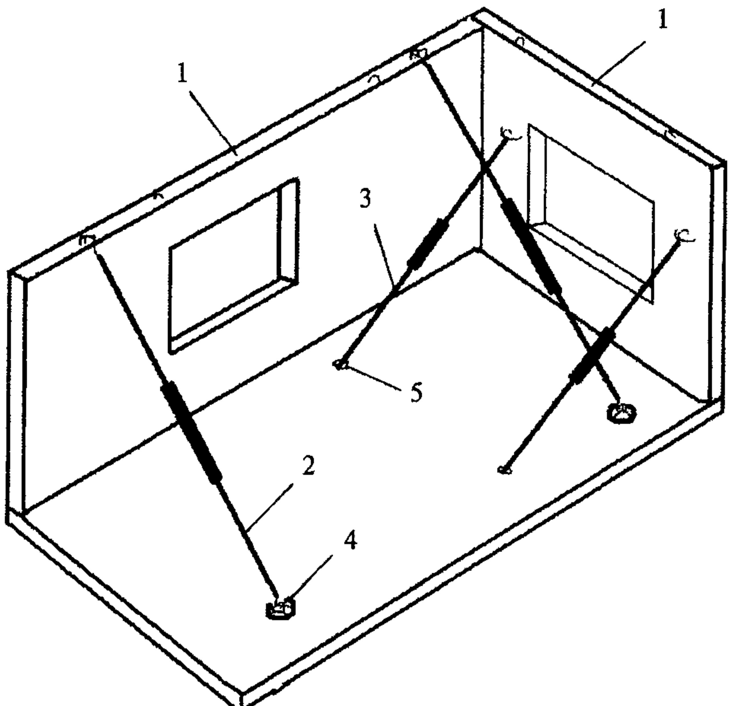
Рис. 9. Временное закрепление наружных стеновых панелей
