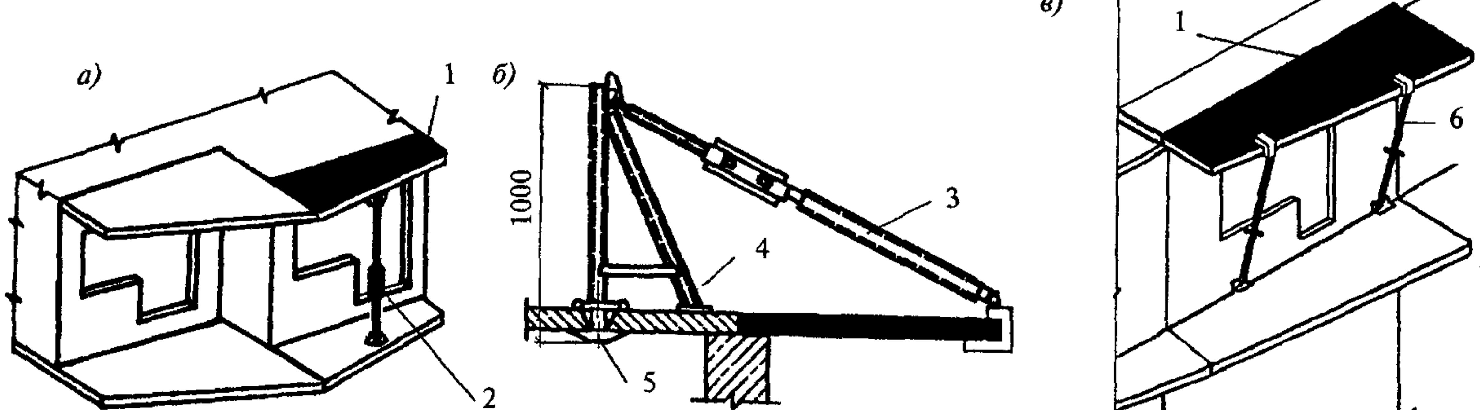
**Рис. 12. Временное закрепление балконных плит**
