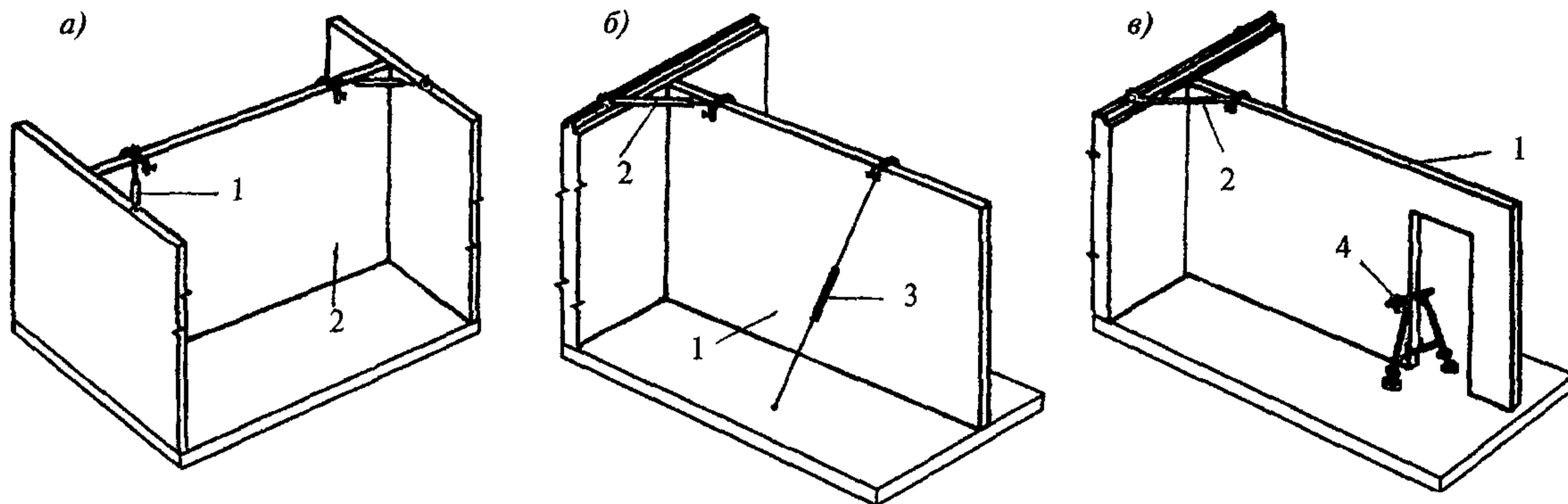
**Рис. 10. Временное закрепление внутренних стеновых панелей**
