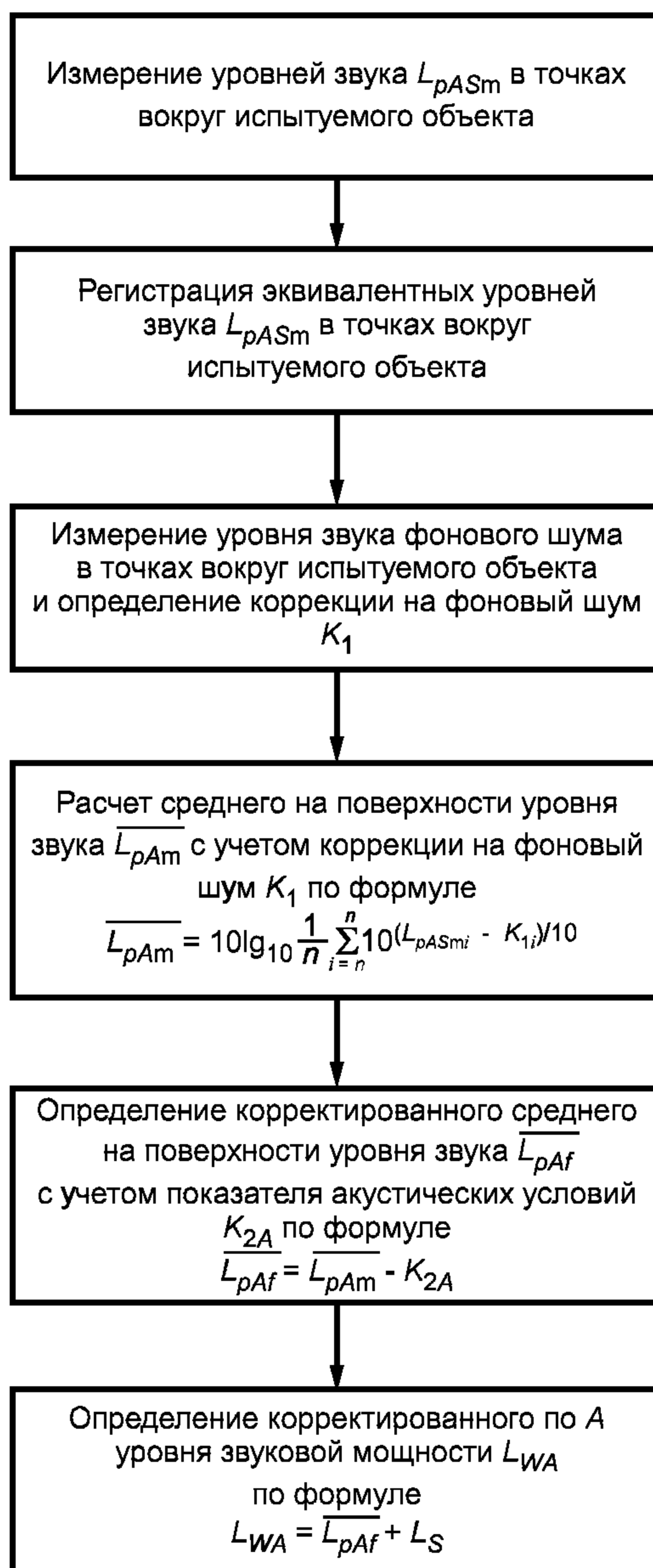
Рисунок С.1 — Диаграмма последовательности действий при определении звуковой мощности по звуковому давлению
