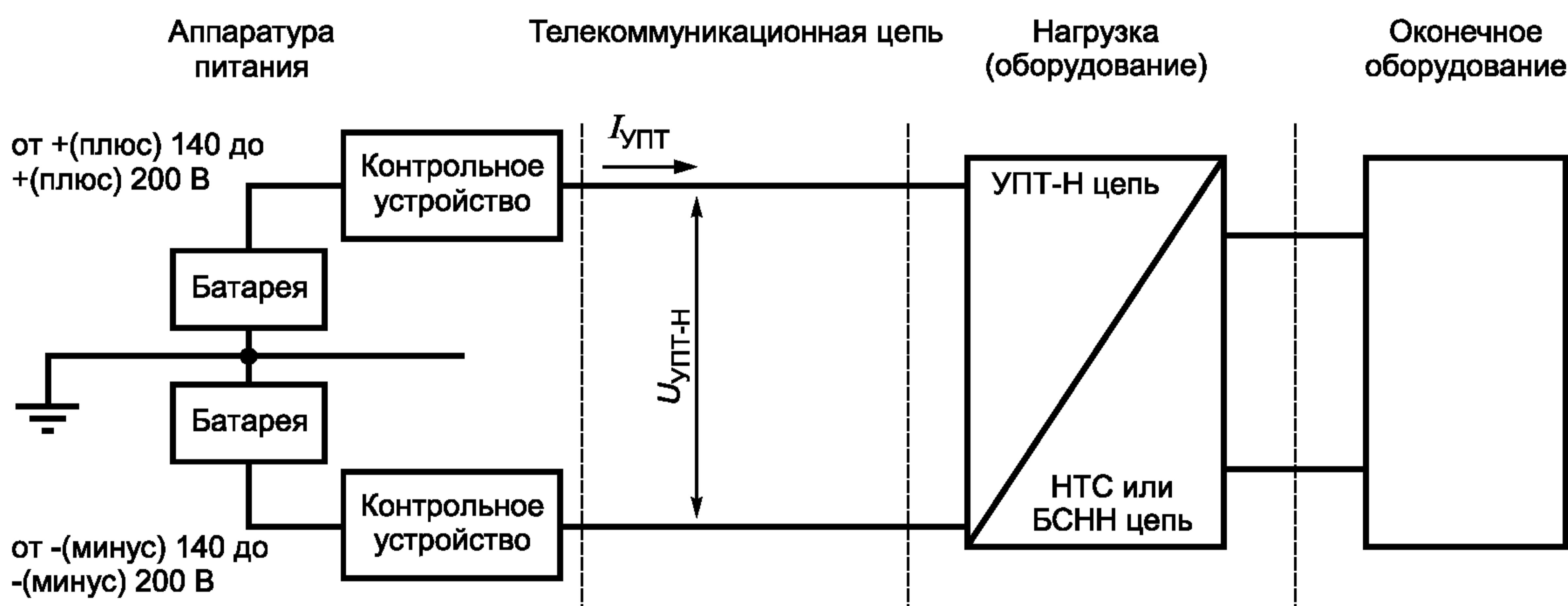
Рисунок А.2 — Пример УПТ-Н системы удаленного электропитания
