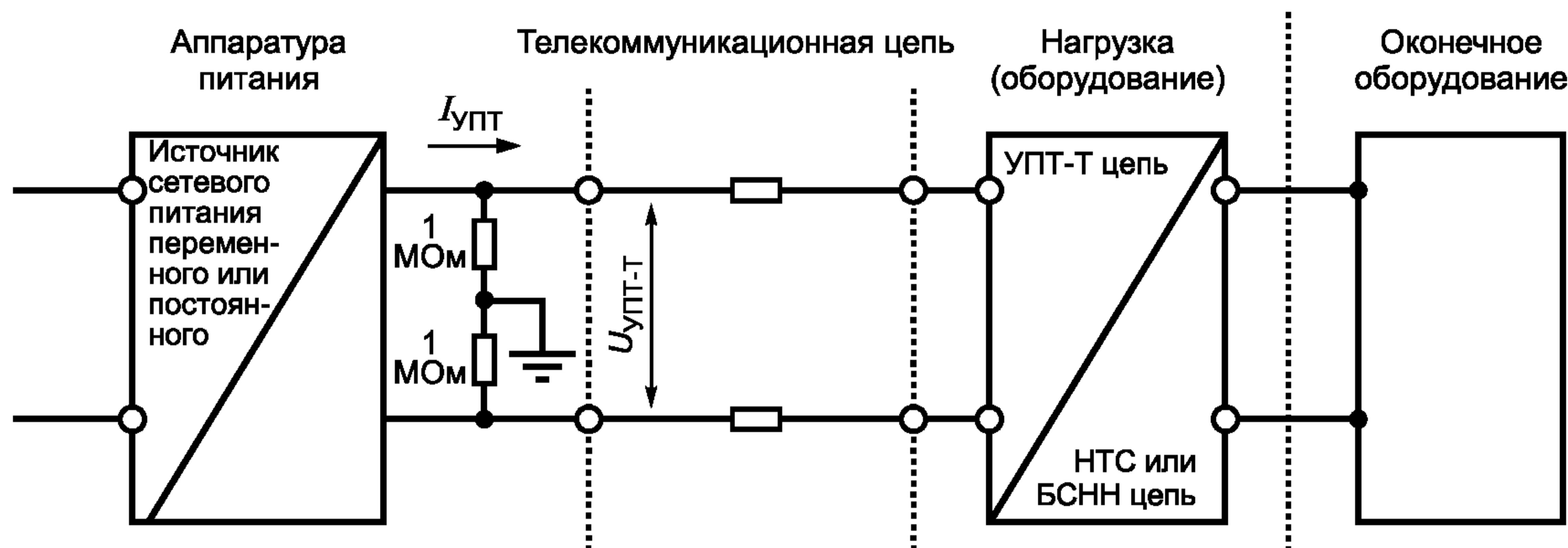
Рисунок А.1 — Пример УПТ-Т системы удаленного электропитания
