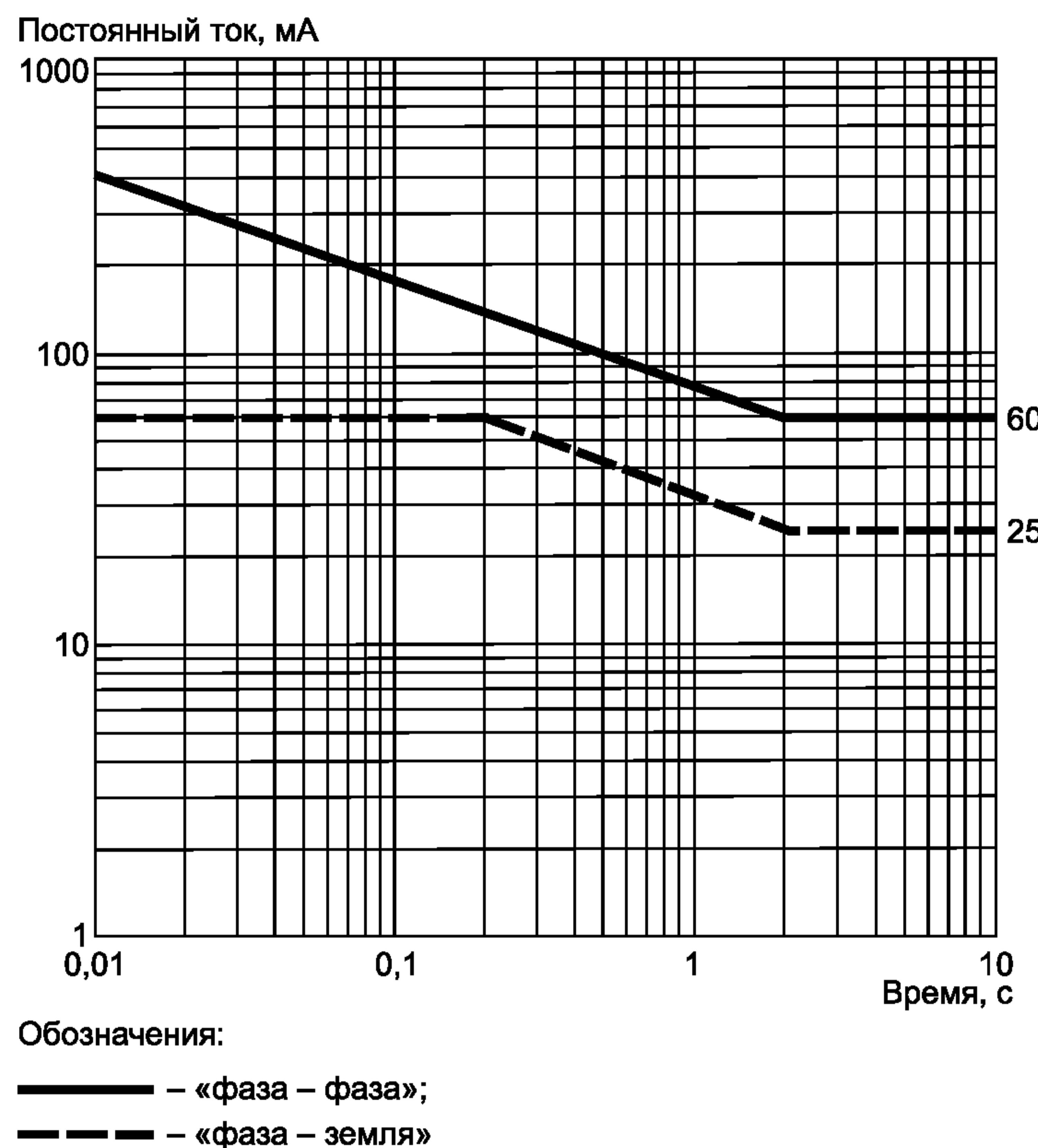
Рисунок 1 — Максимальный ток после единичной неисправности
