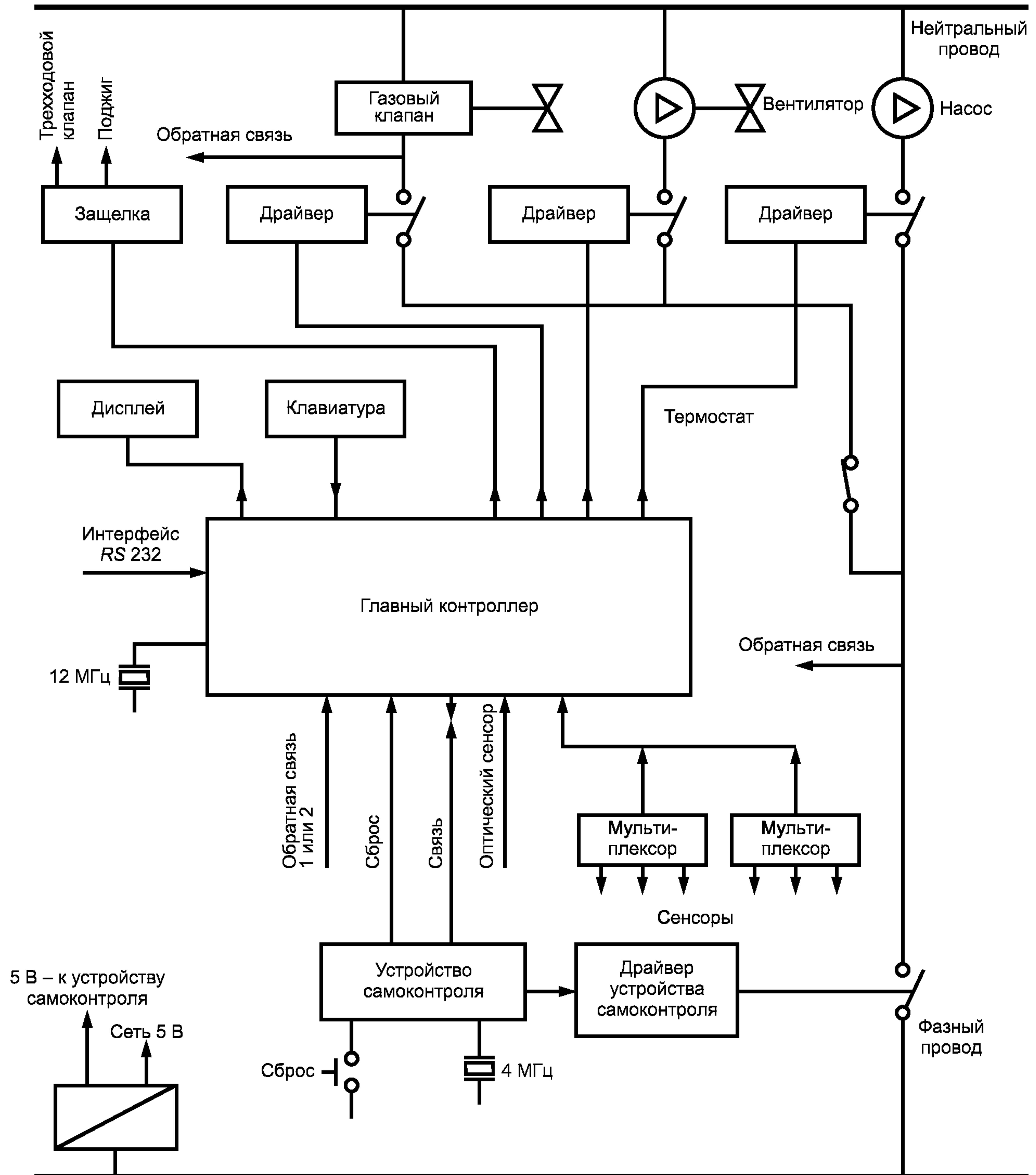
Рисунок Б.2 — Контроллер газовой горелки: структура
