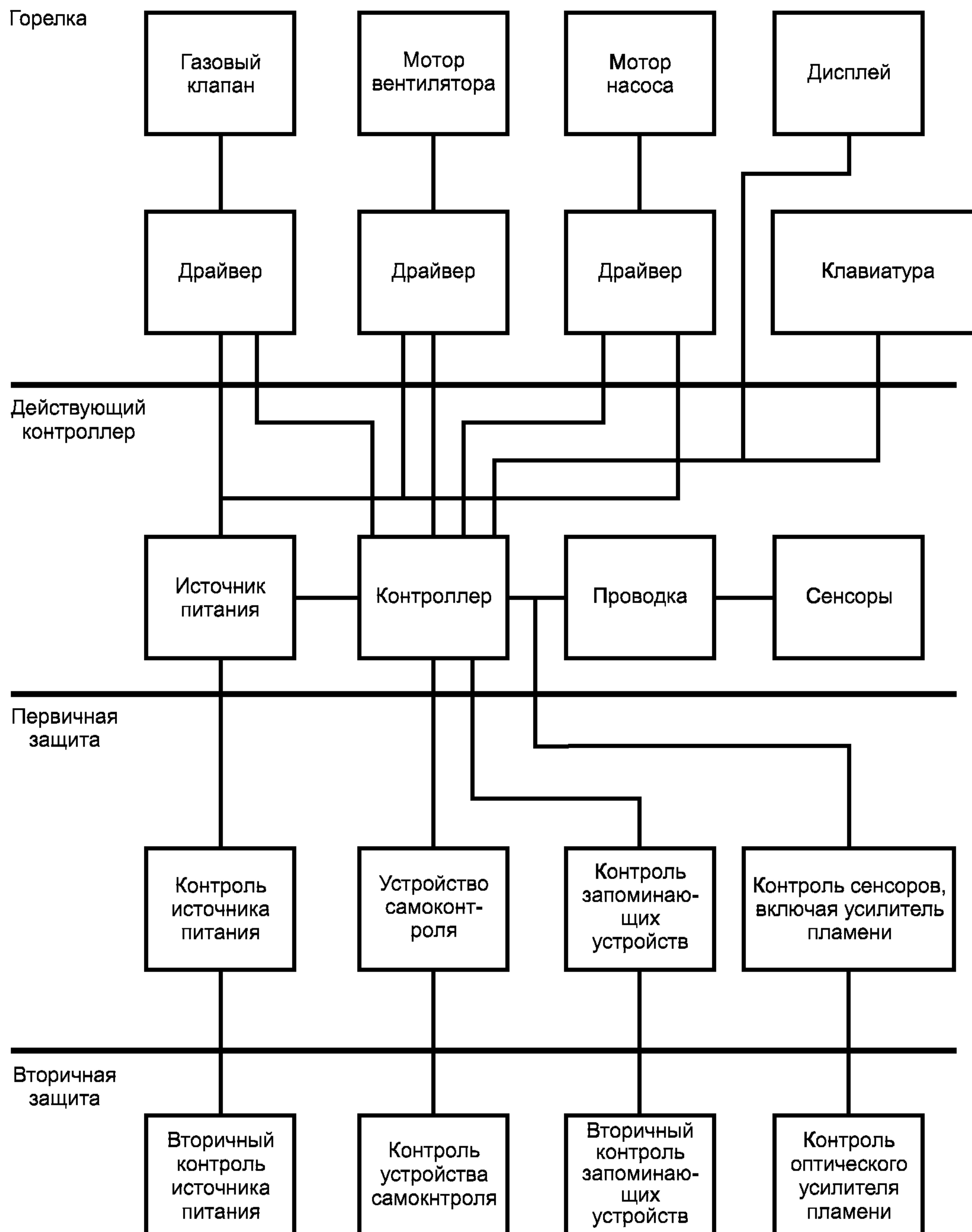
Рисунок Б.3 — Контроллер газовой горелки: блок-схема
