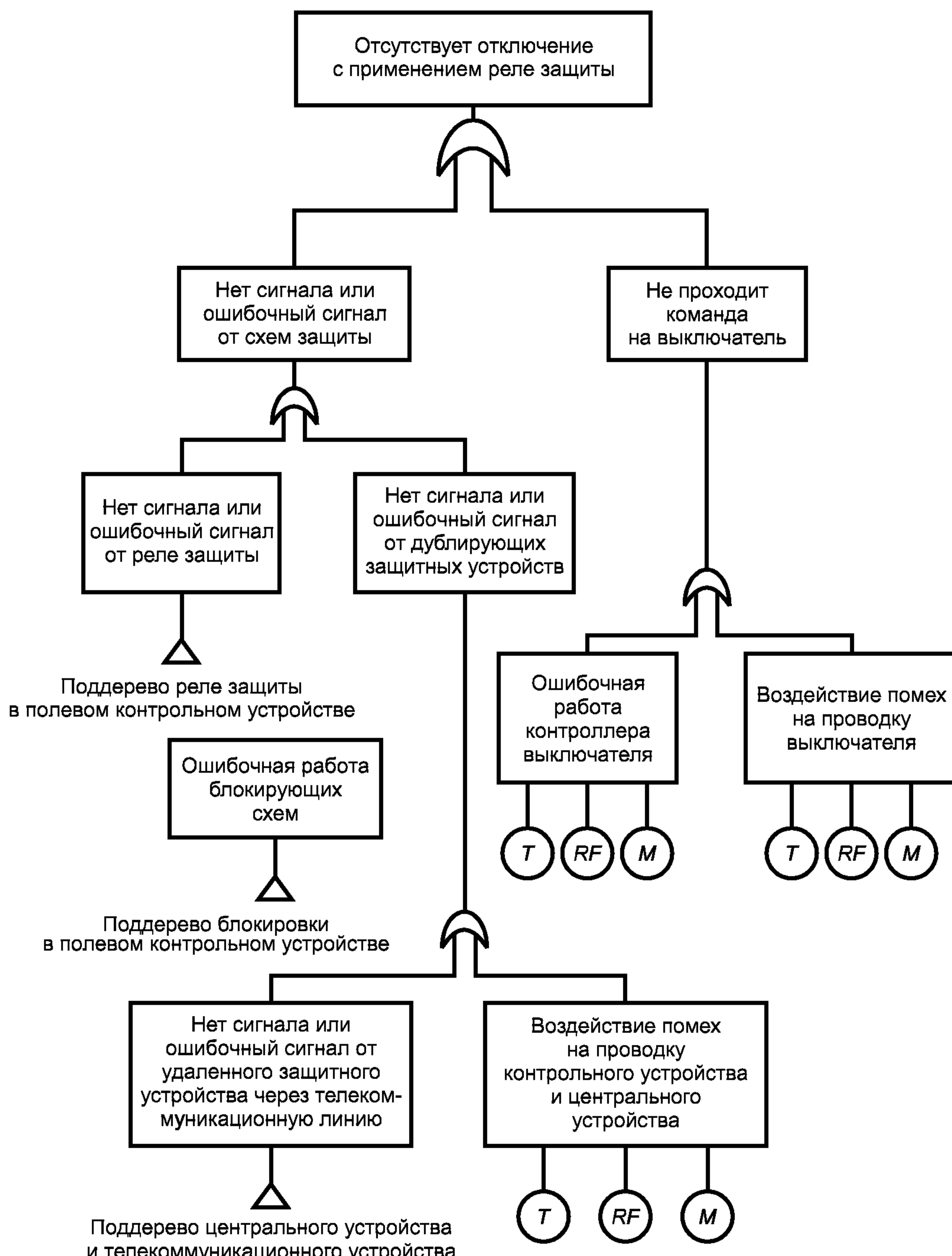
*T* — электромагнитные помехи в виде однополярных и колебательных переходных процессов; *RF* — длительные радиочастотные электромагнитные поля; *M* — магнитное поле
