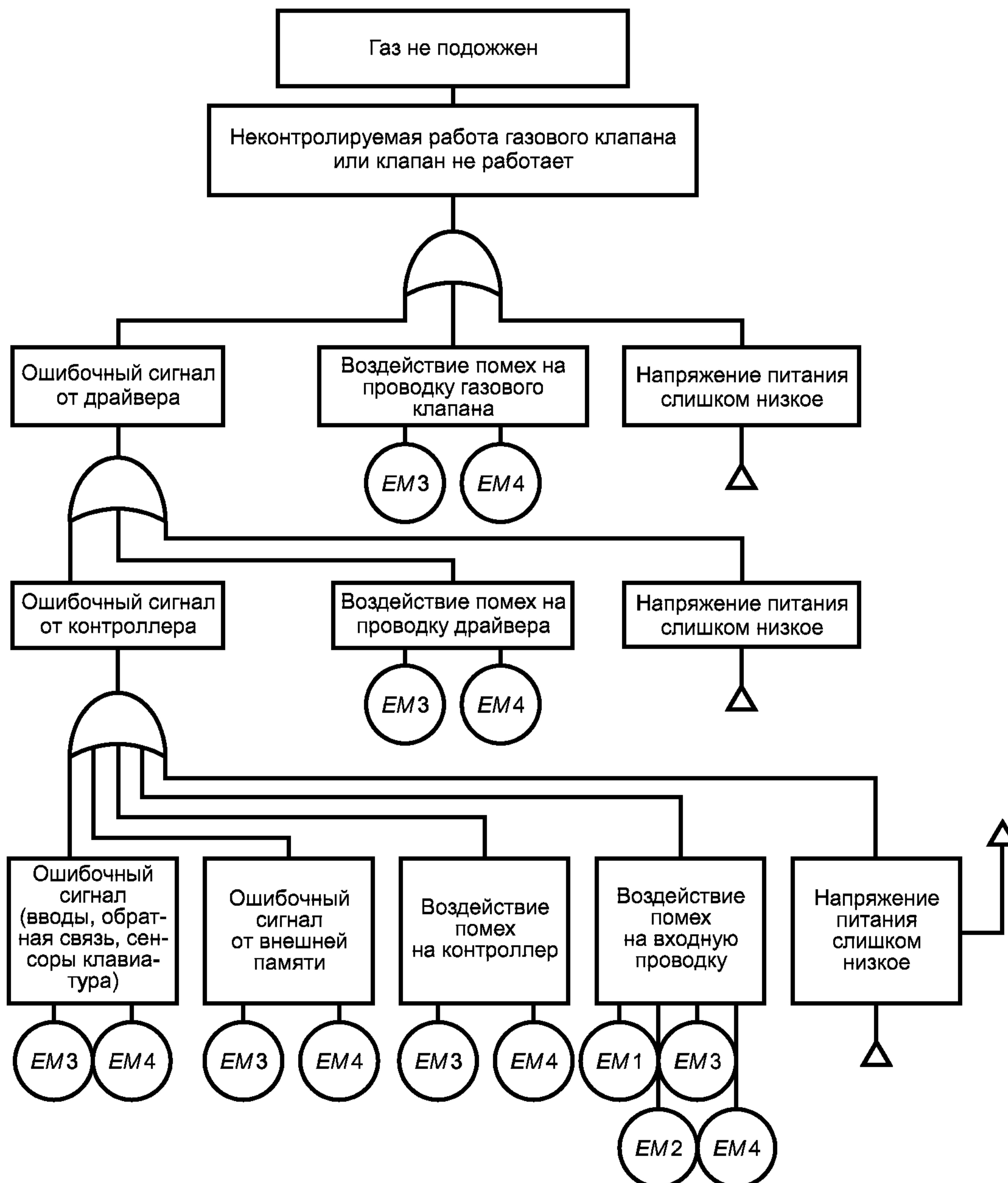
*EM1* — низкочастотные излучаемые помехи; *EM2* — высокочастотные кондуктивные помехи; *EM3* — высокочастотные излучаемые помехи; *EM4* — электростатические разряды
