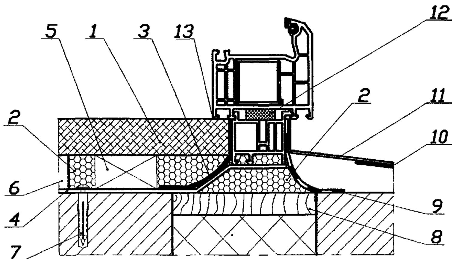
Рисунок 2 - Узел нижнего примыкания оконного блока, подоконника и слива к проему слоистой стены с эффективным утеплителем:
