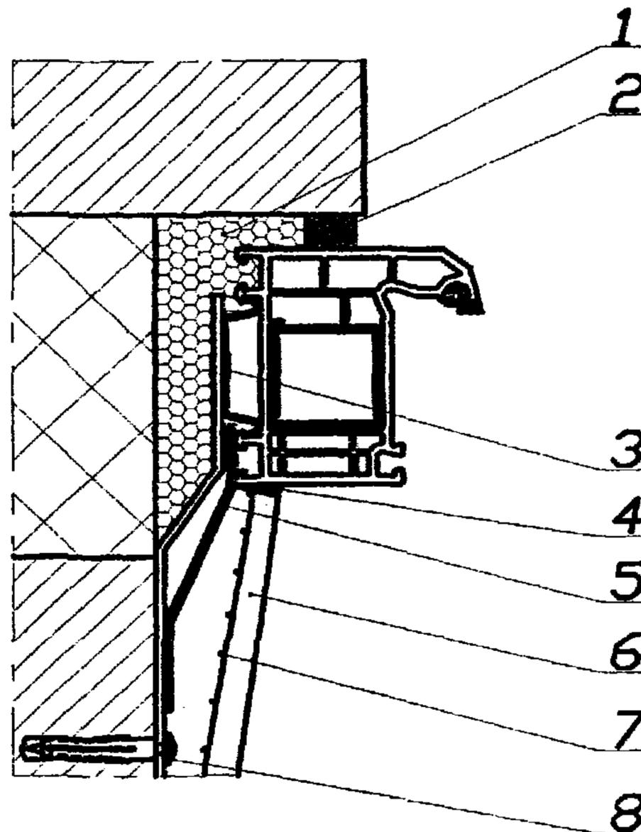
Рисунок 1 - Узел бокового примыкания оконного блока к проему с четвертью слоистой стены из кирпича с эффективным утеплителем и отделкой внутреннего откоса штукатурным раствором:
