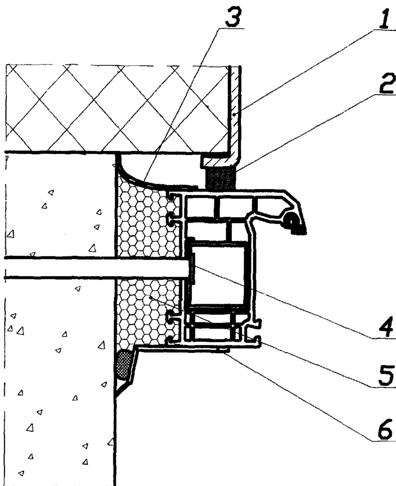
Рисунок 5 - Узел бокового примыкания оконного блока к проему стены из бетона с наружным утеплением фасада и установкой внутреннего декоративного нащельника с пароизоляционной системой:
