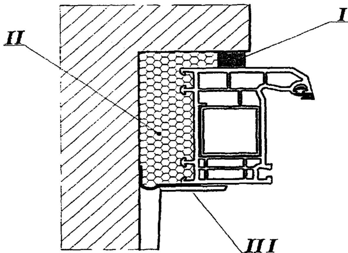
Рисунок 1 – Принципиальная схема монтажного шва
