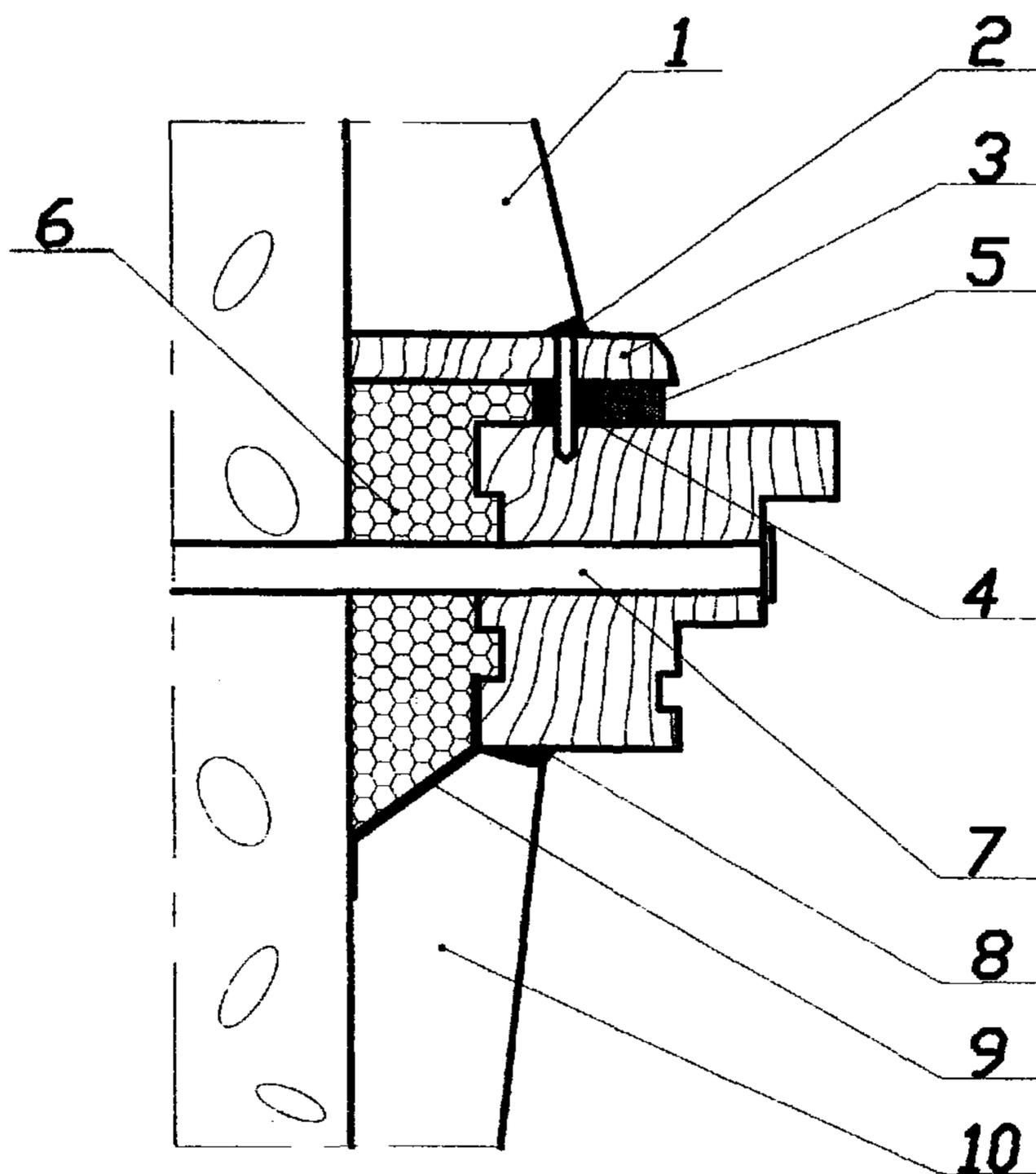
Рисунок 4 - Узел бокового примыкания оконного блока к проему без четверти в стене из ячеистобетонных блоков с отделкой наружных и внутренних откосов штукатурным раствором:
