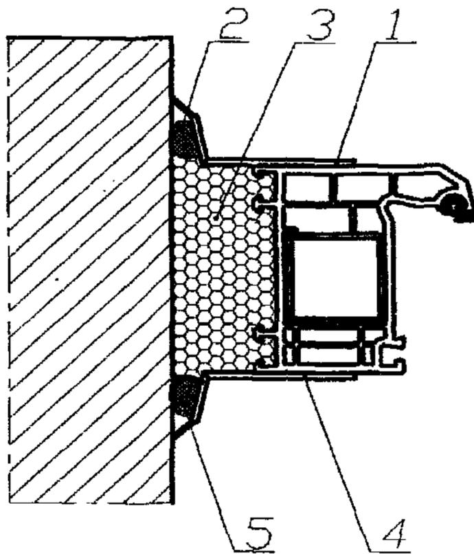
Рисунок 6 - Узел изоляции и отделки оконного стыка за одну рабочую операцию (планки установлены с наружной или внутренней сторон стыка):
