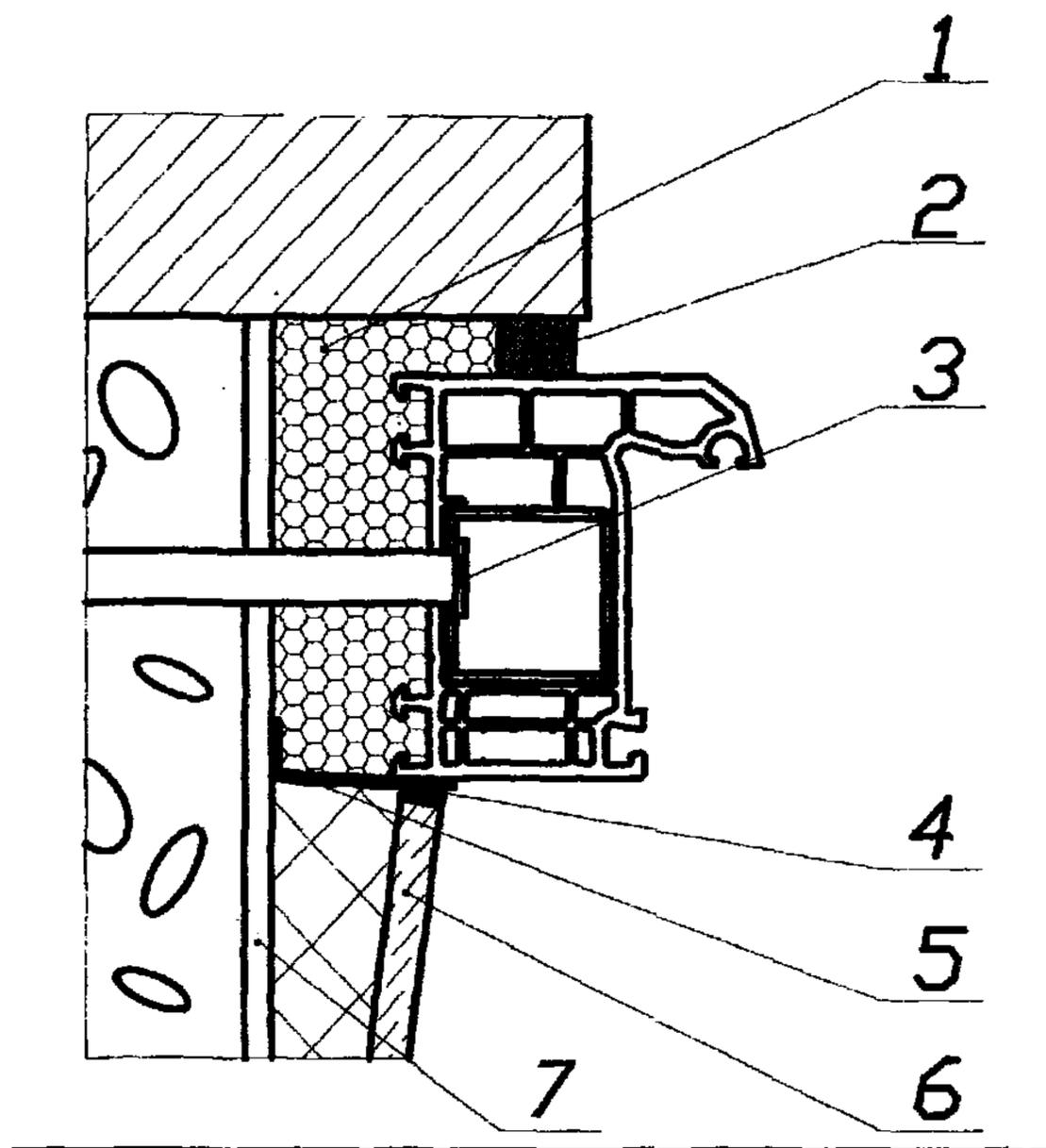
Рисунок 3 - Узел бокового примыкания оконного блока к проему с четвертью в стене из ячеистобетонных блоков (плотностью 400 – 450 кг/м<sup>3</sup>) с облицовкой кирпичом и отделкой внутреннего откоса панелью:
