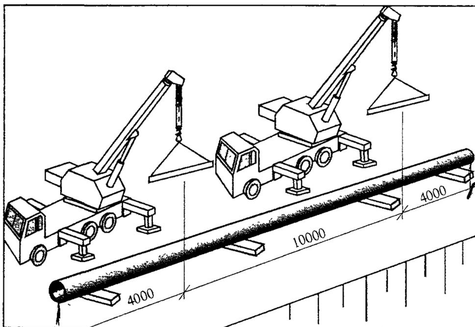
2.11 После зачистки монтажники, по двое на каждом конце звена труб (или отдельных труб), размечают с помощью рулетки места строповки звена (или трубы) для грузоподъемных механизмов.
