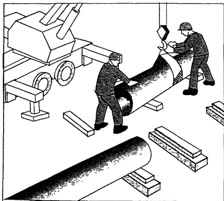
2.7 Монтажники Т1 и Т2 по рулетке размечают середину трубы. Машинист устанавливает кран-трубоукладчик на расстоянии около 1 м от трубы так, чтобы стрела находилась над центром ее тяжести, и опускает строп-полотенце. Монтажник Т2 строкует первую трубу, и машинист крана приподнимает ее на 20-30 см.
