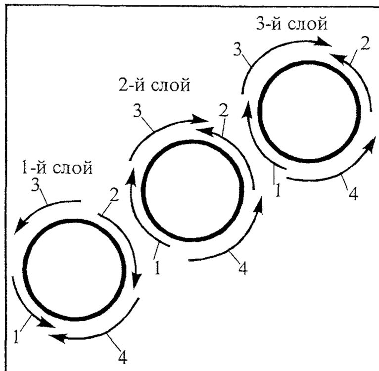
Рисунок 3 – Порядок наложения шва при сварке стыка
