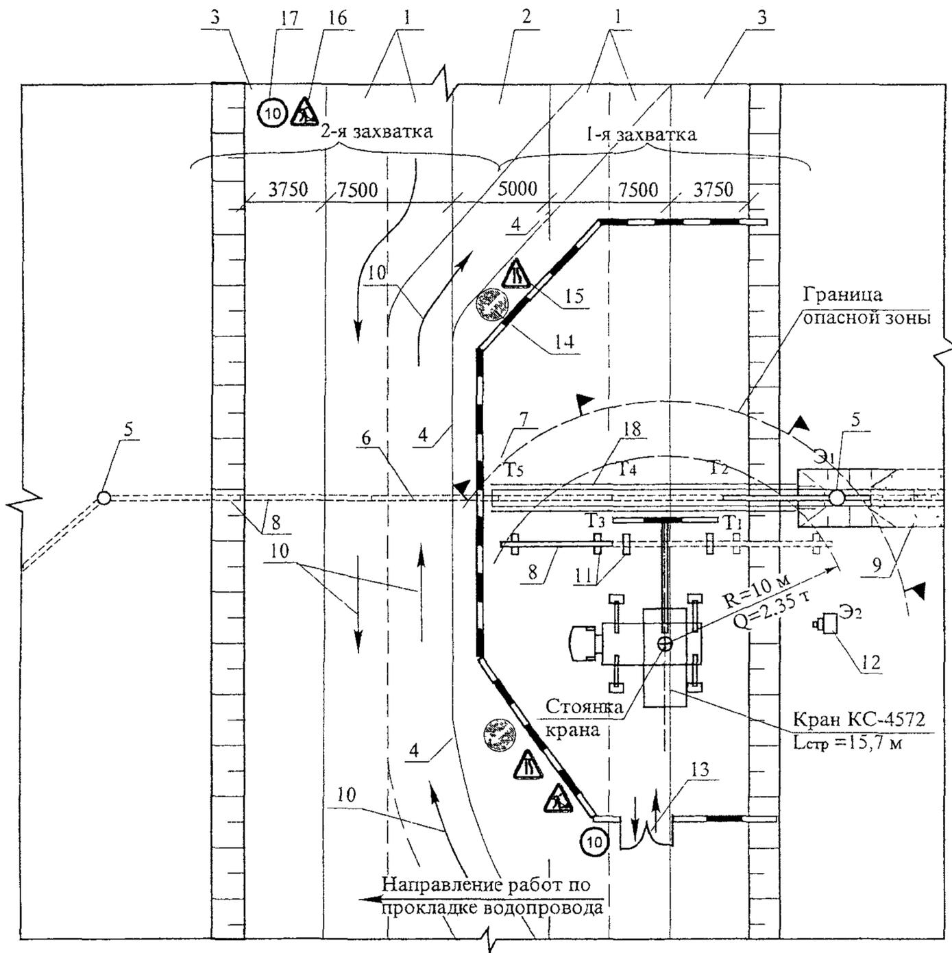
1 – проезжая часть, полосы движения; 2 – разделительная полоса; 3 – обочина; 4 – дорожный барьер; 5 – водопроводные колодцы; 6 – проектируемый переход водопровода; 7 – дорожные тумбы; 8 – трубы водопроводные; 9 – проложенный участок водопровода; 10 – направление движения автотранспорта; 11 – лежни; 12 – сварочный агрегат; 13 – ворота; 14 – импульсная стрелка; 15 – сужение дороги (налево, направо); 16 – дорожные работы; 17 – ограничение скорости; 18 – ограждение траншеи и участка работ.
