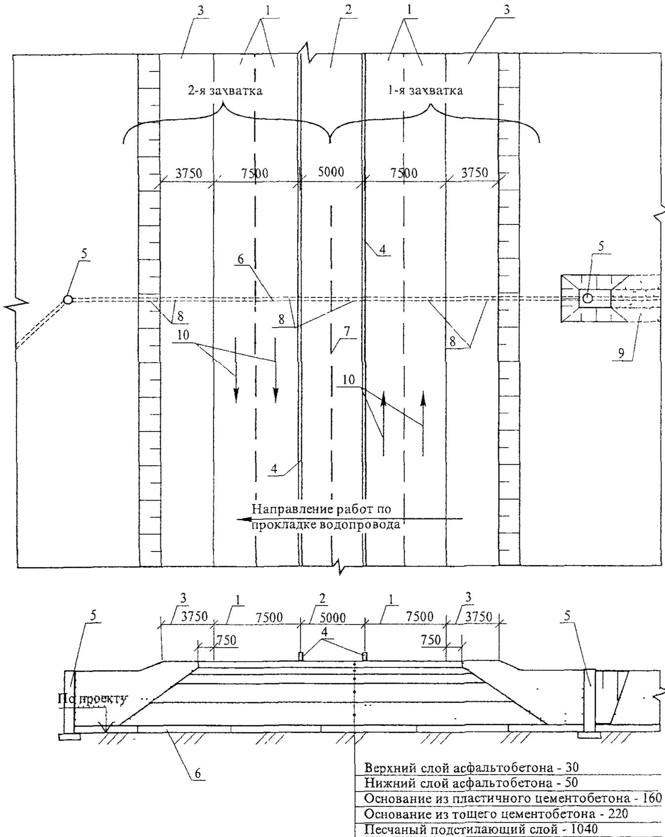
1 – проезжая часть, полосы движения; 2 – разделительная полоса; 3 – обочина; 4 – дорожный барьер; 5 – водопроводные колодцы; 6 – проектируемый переход водопровода; 7 – линия раздела по захваткам; 8 – трубы водопровода; 9 – проложенный участок водопровода, 10 – направление движения автотранспорта
