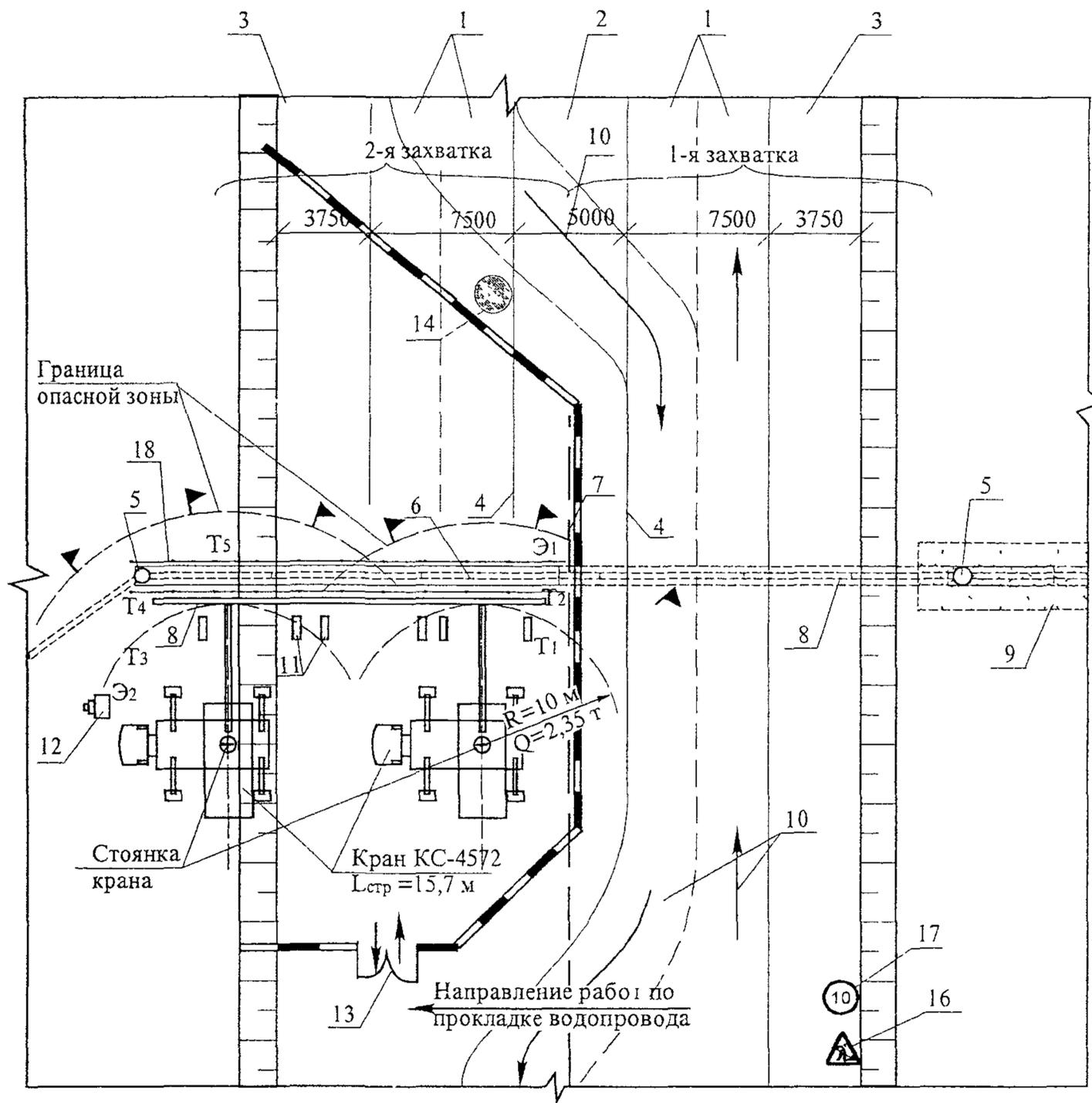
1 – проезжая часть, полосы движения; 2 – разделительная полоса; 3 – обочина, 4 – дорожный барьер; 5 – водопроводные колодцы; 6 – проектируемый переход водопровода; 7 – дорожные тумбы, 8 – трубы водопроводные; 9 – проложенный участок водопровода; 10 – направление движения автотранспорта; 11 – лежни; 12 – сварочный агрегат; 13 – ворота; 14 – импульсная стрелка; 16 – дорожные работы; 17 – ограничение скорости; 18 – ограждение траншеи и участка работ.
