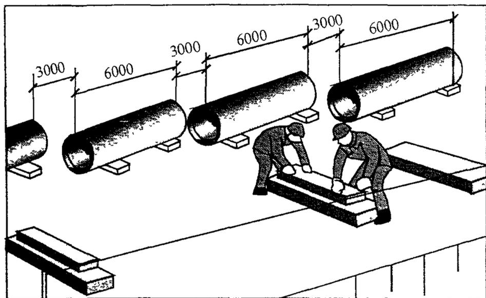
Монтажники Т3 и Т4 натягивают рулетку вдоль оси раскладки звеньев и размечают по ней положение лежней, после чего подносят лежни и раскладывают их по разметке так, чтобы середина лежней совпадала с осью раскладки. По концам крайних лежней забивают четыре стальных стержня и натягивают между ними
