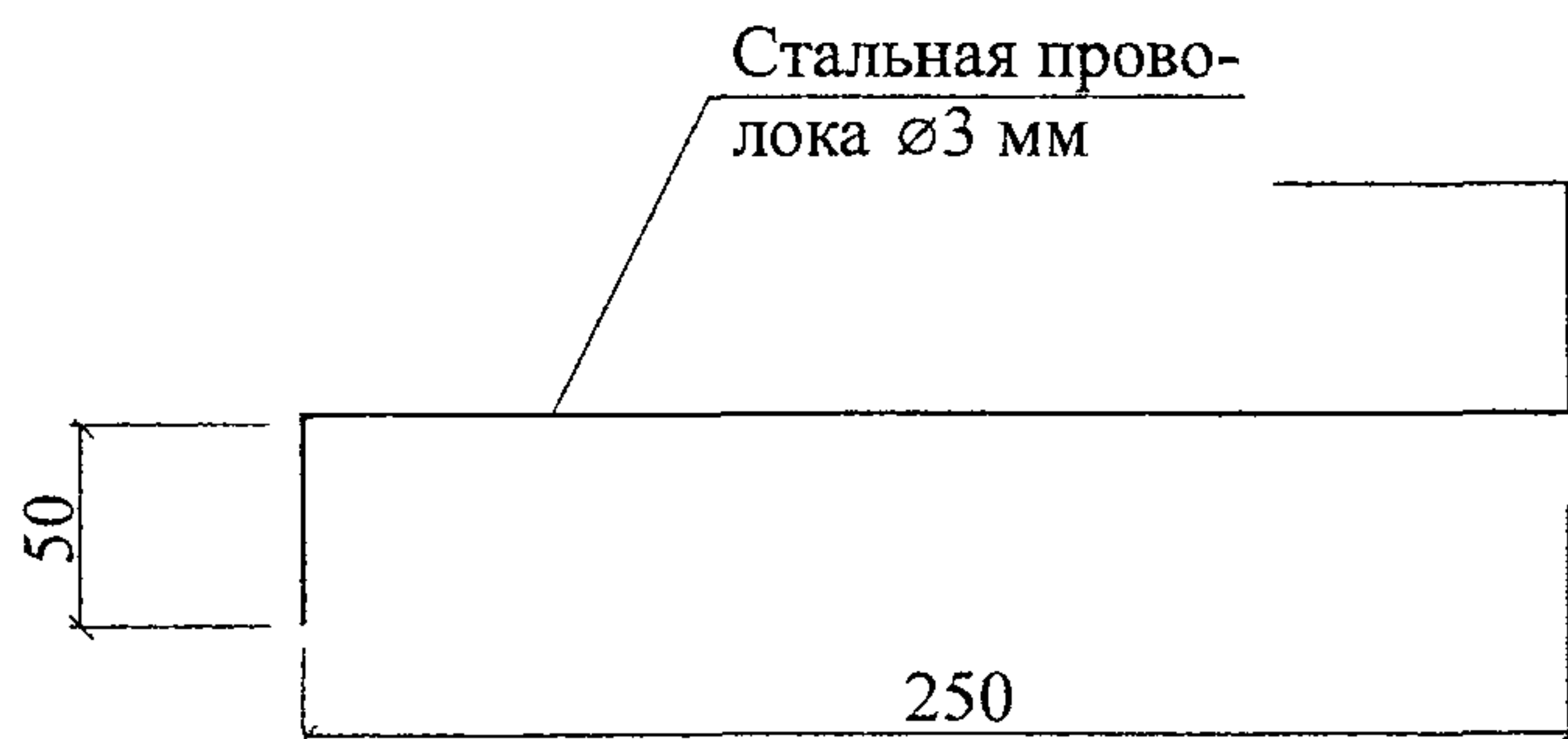
Рисунок 6 – Щуп для замера величины зазора между торцами стыкуемых труб
