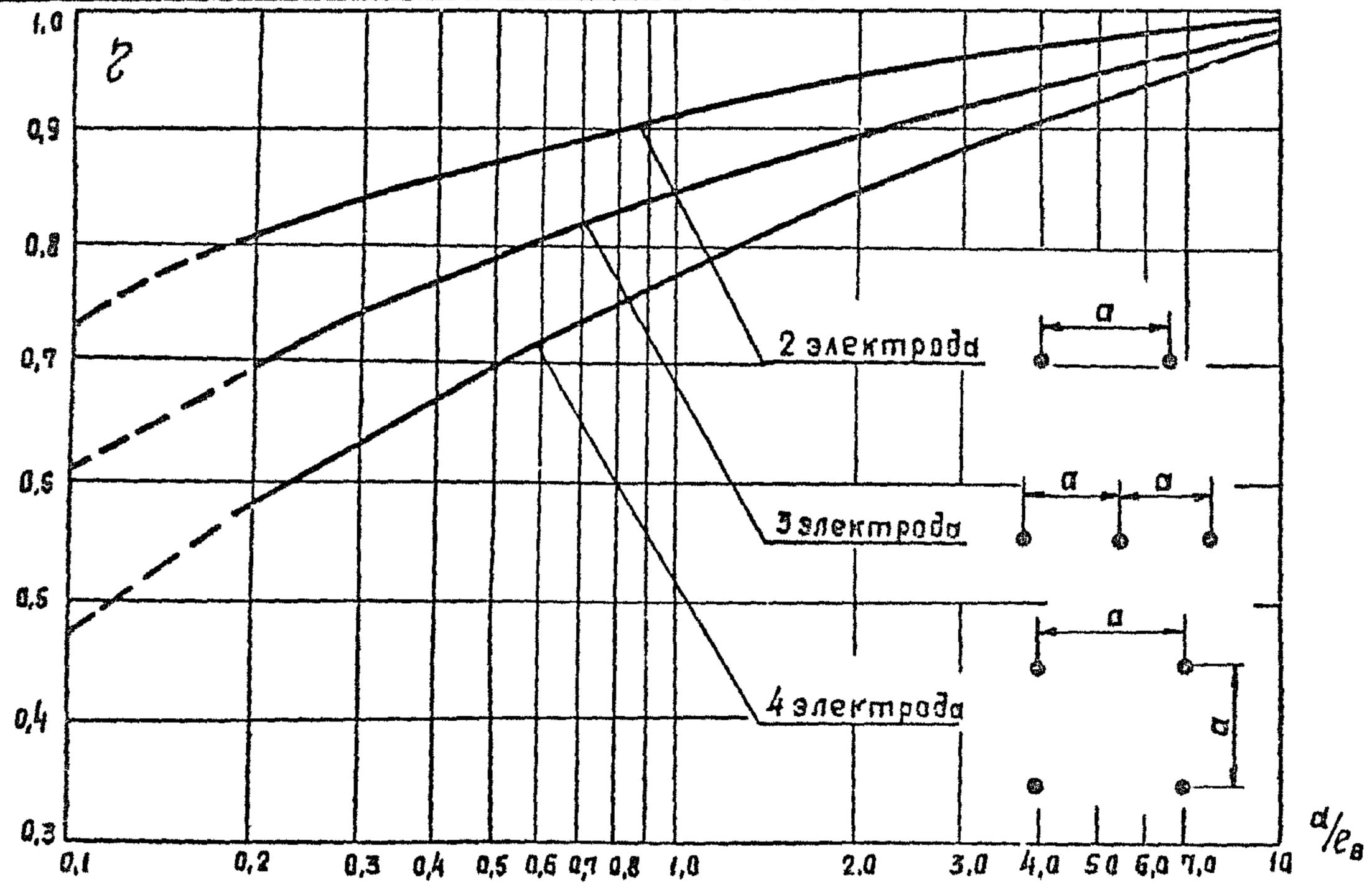
Рис 2 Зависимость  $\zeta = f(a/e_B)$  для вертикальных электродов
