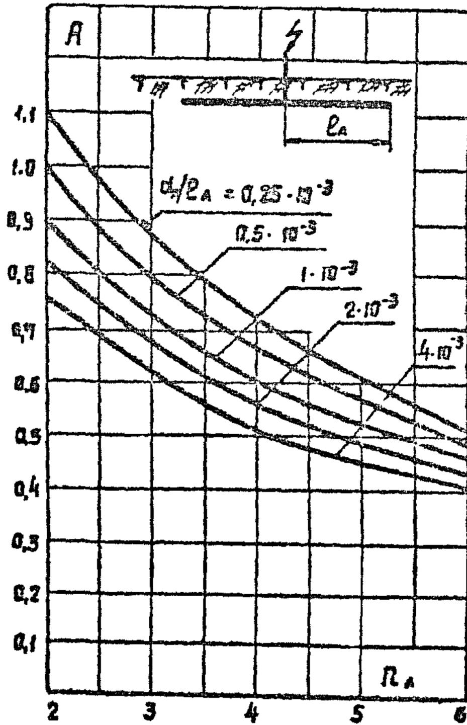
Рис 3. Коэффициент  $A$  для расчета сопротивления протяженных заземлителей.
