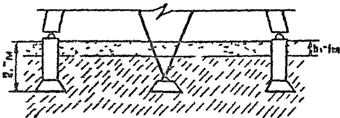
Опора ВЛ500 кВ, порталная, металлическая с стяжками, тип ПС-1
