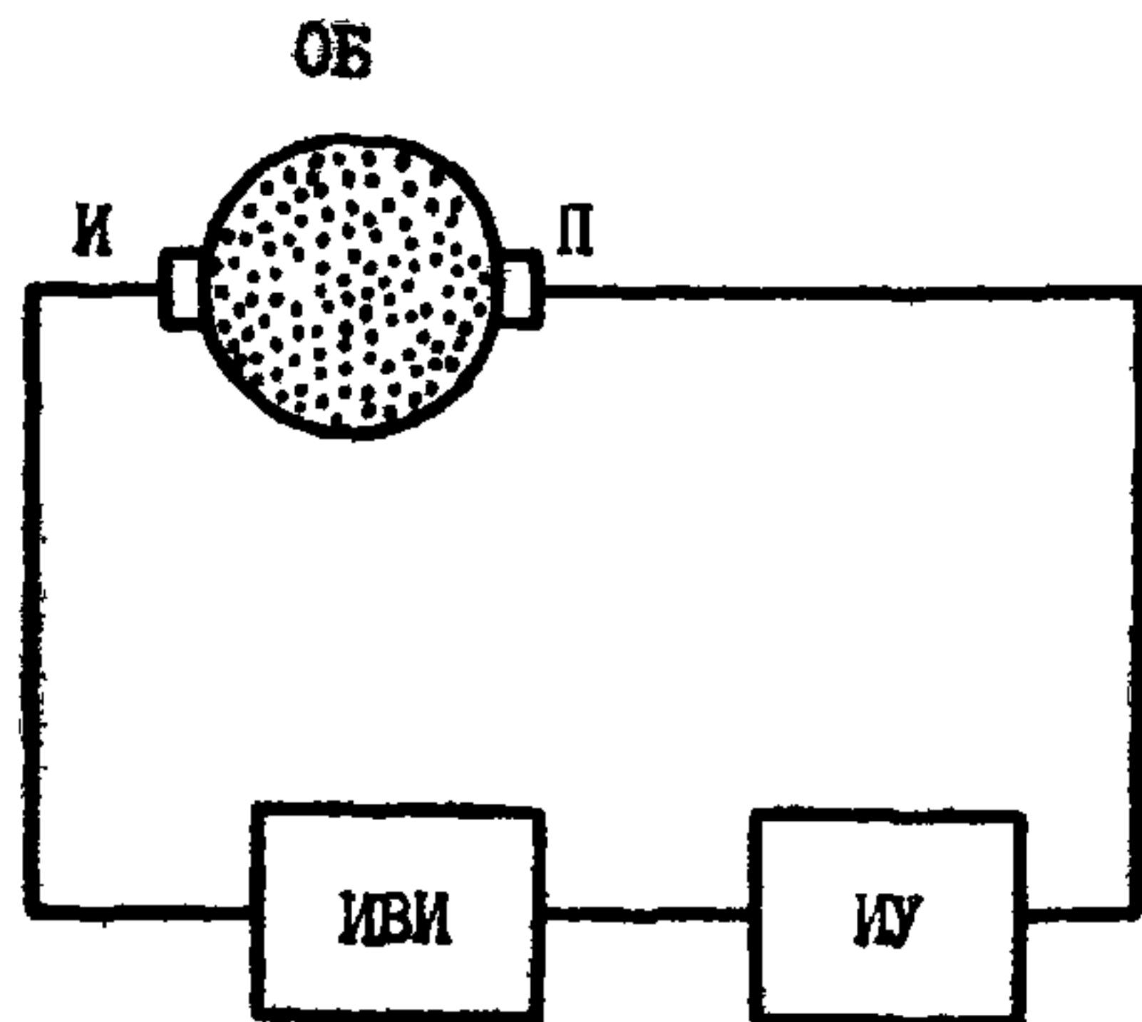
И, П - источник и приемник ультразвуковых колебаний;
