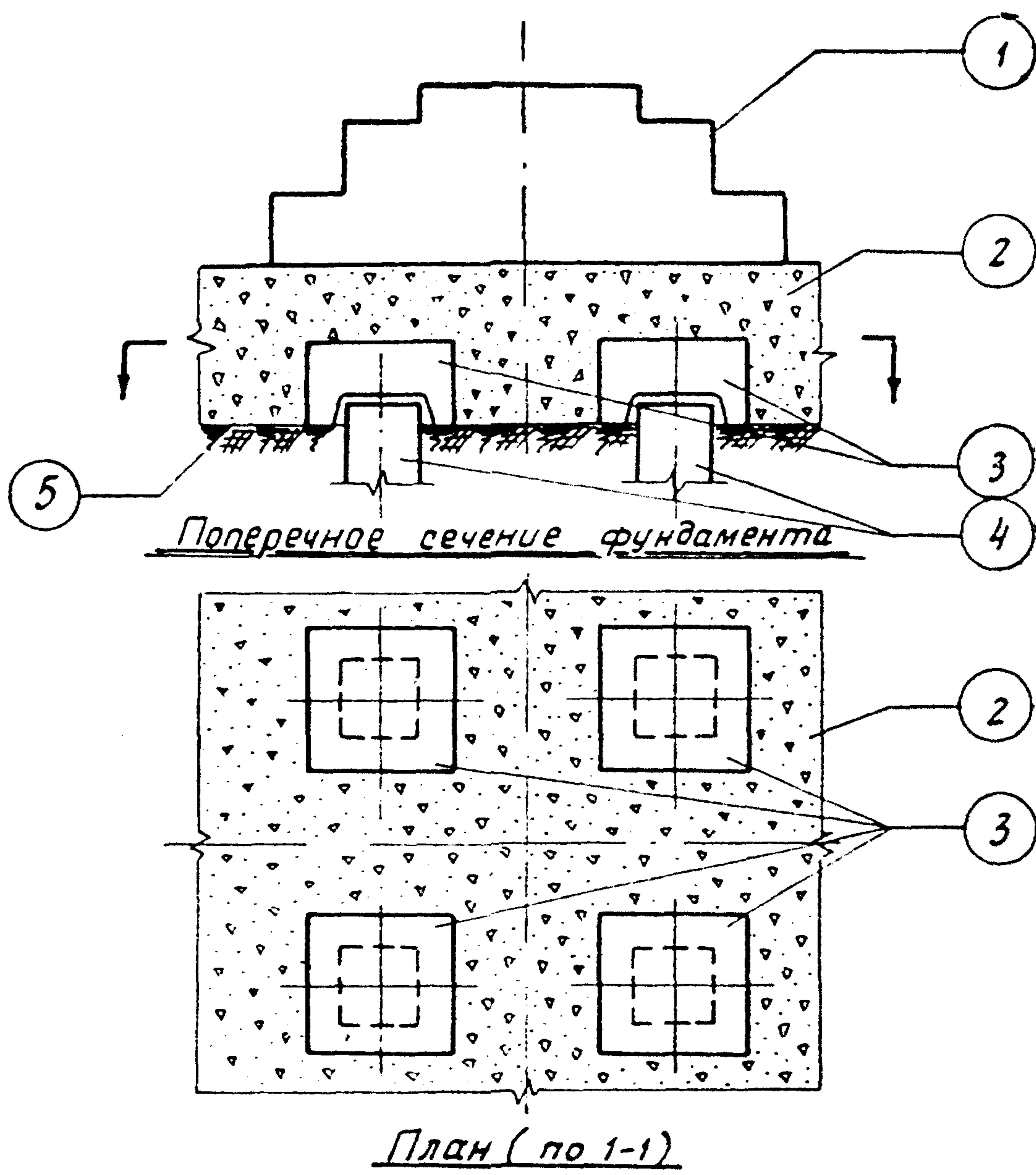
Рис 1. Схема фундамента с промежуточной подушкой
