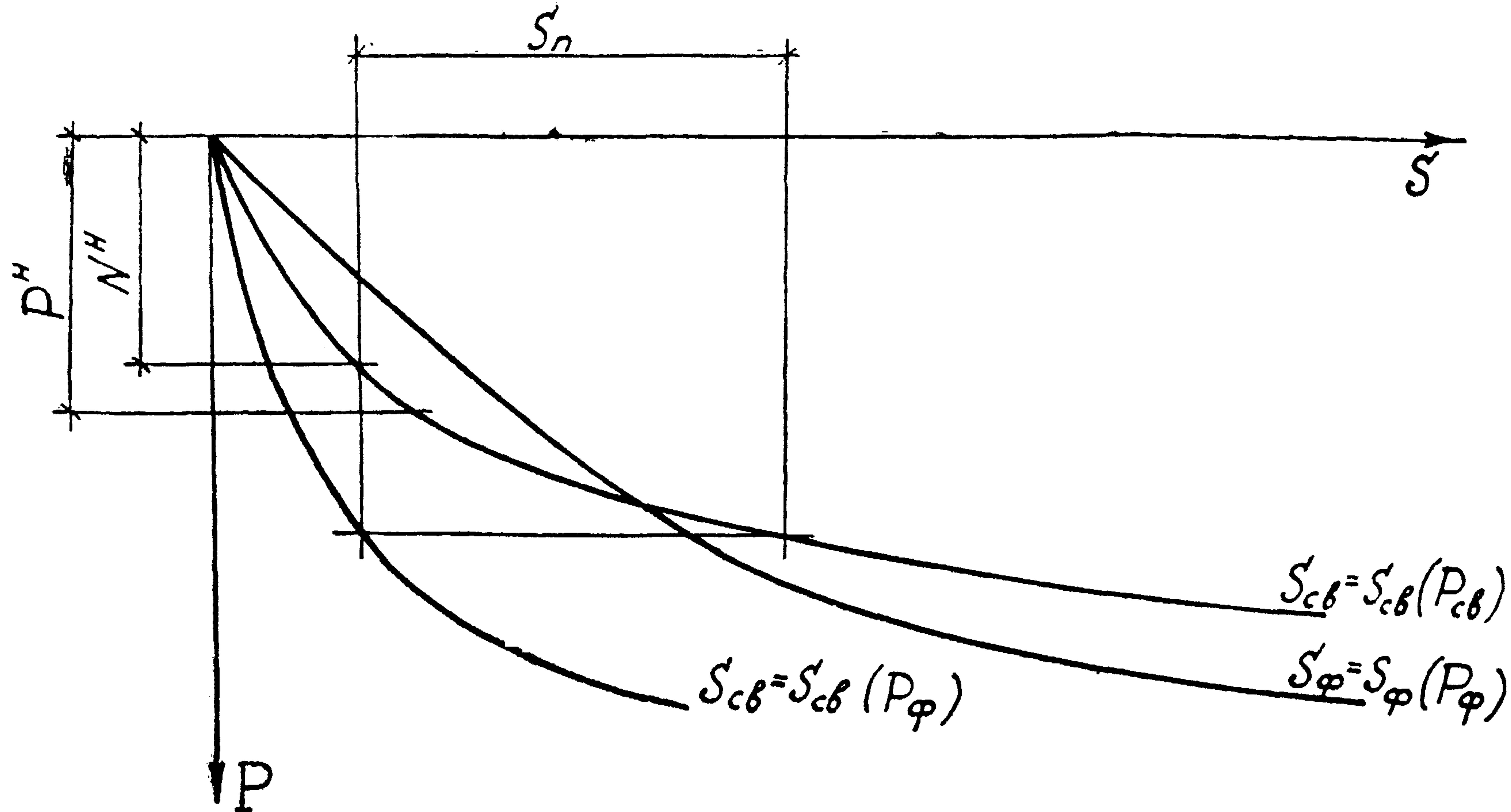
Рис. 4 Определение осадки промежуточной подушки по результатам испытаний.
