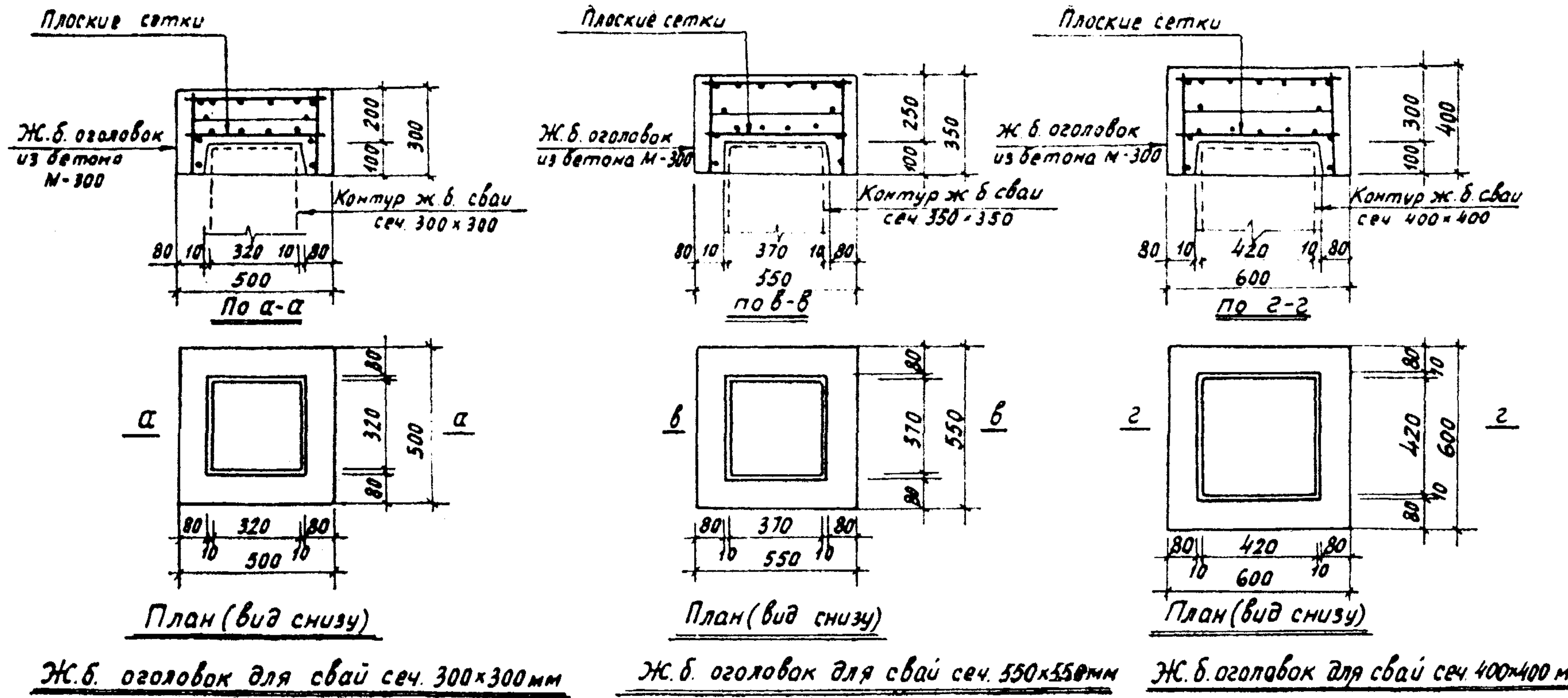
Рис.2. Конструктивные схемы ж.б. оголовков свай.
