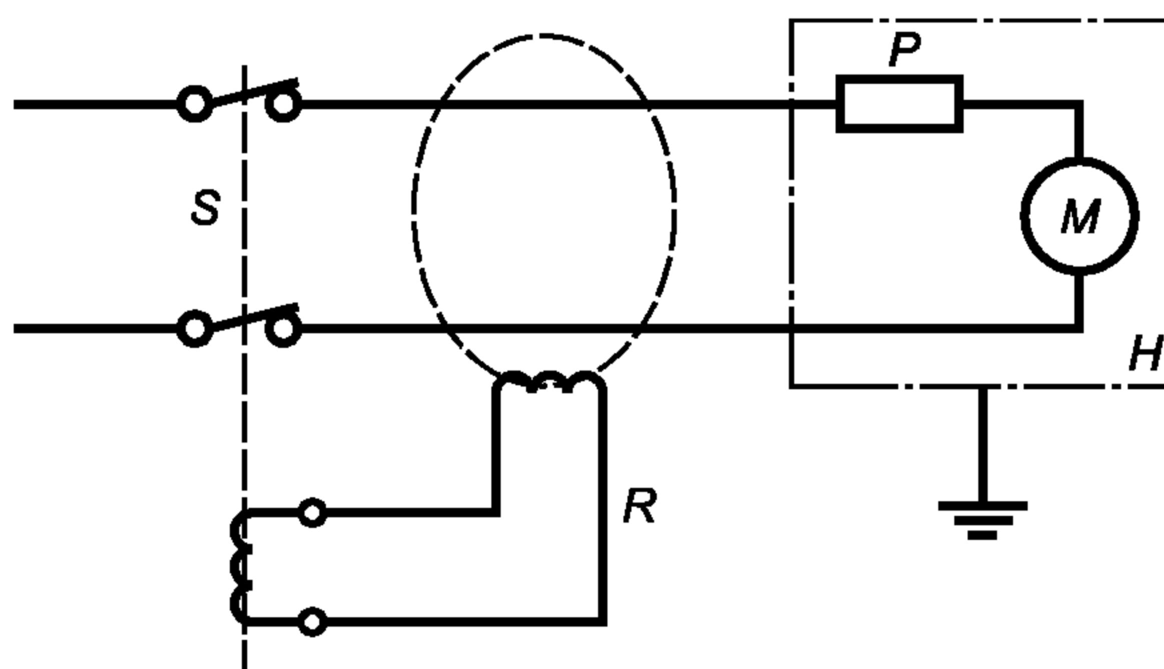
S — источник питания; H — корпус; R — устройство остаточного тока ( $I_{\Delta n} = 30 \text{ мА}$ ); P — устройство тепловой защиты двигателя (наружное или внутреннее), если имеется; M — двигатель
