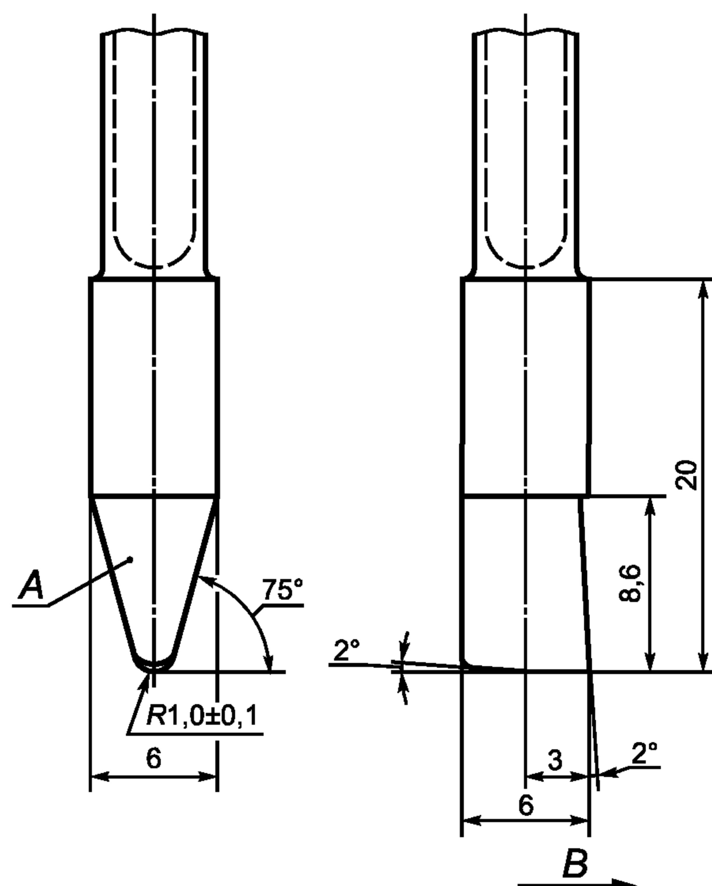
*A* — твердосплавный наконечник типа К10 по ГОСТ 3882; *B* — направление движения
