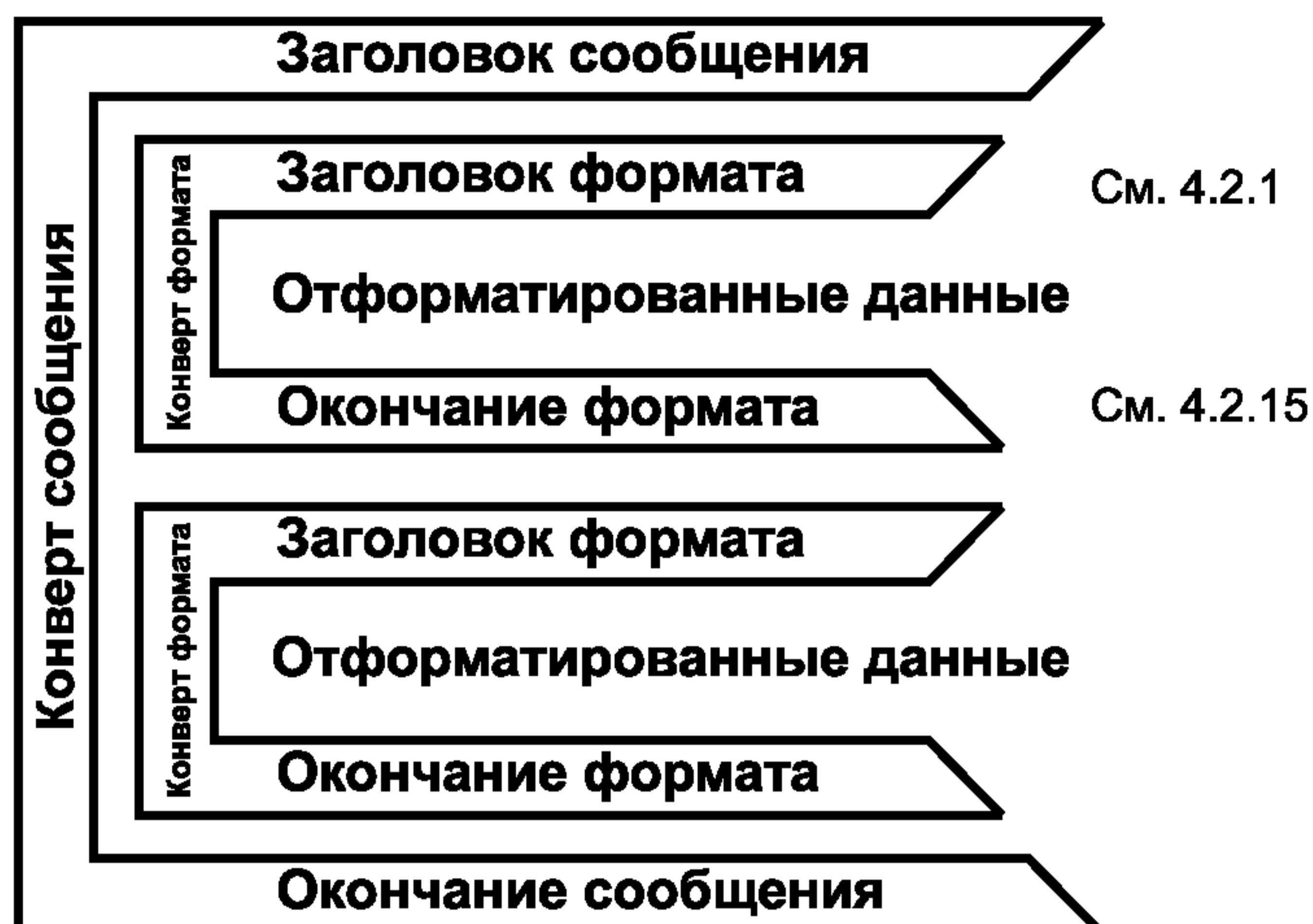
Рисунок 1 — Структура конвертов
