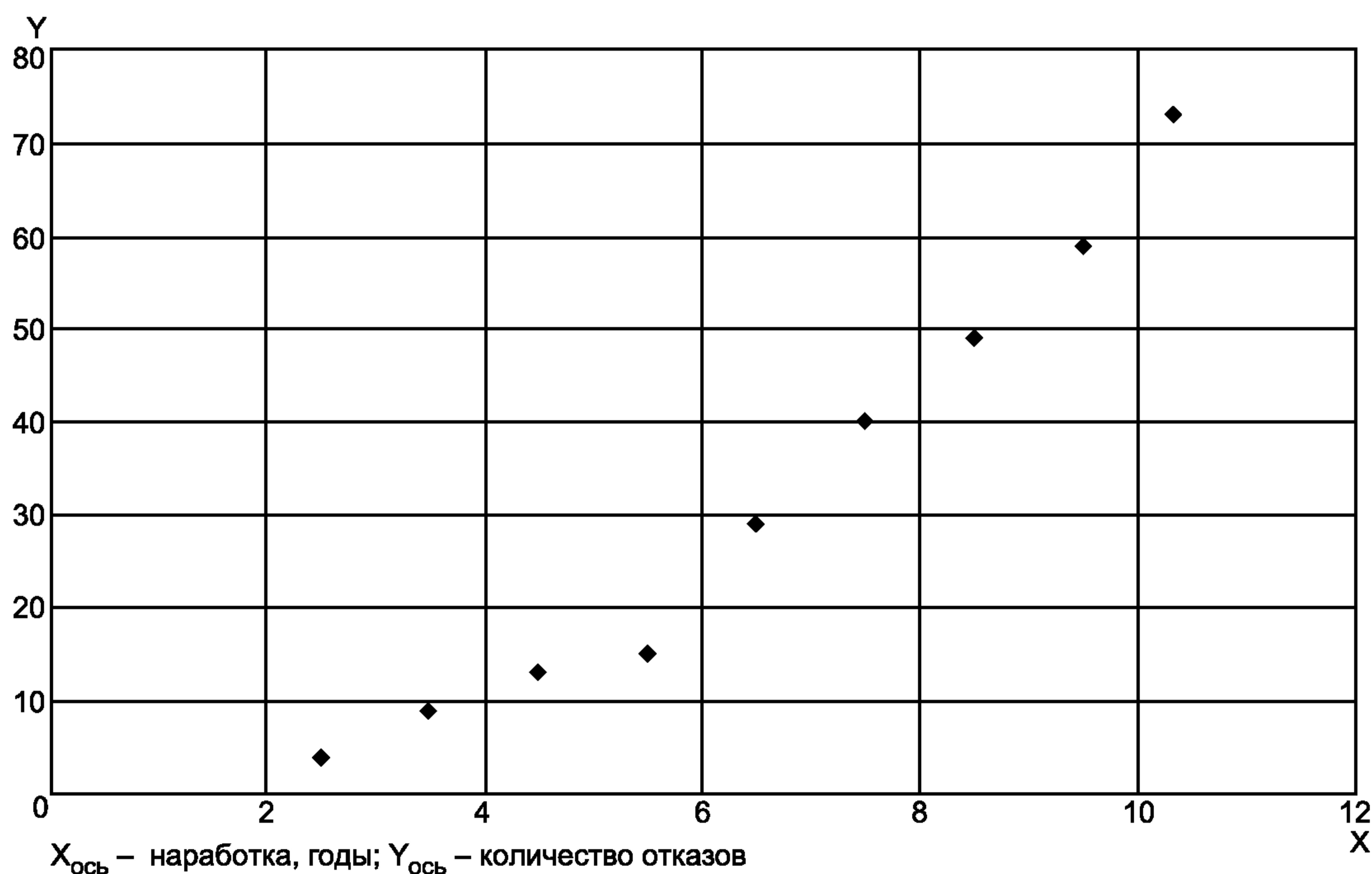
Рисунок B.6 — Суммарное количество отказов и наработка для системы генераторов морских судов
