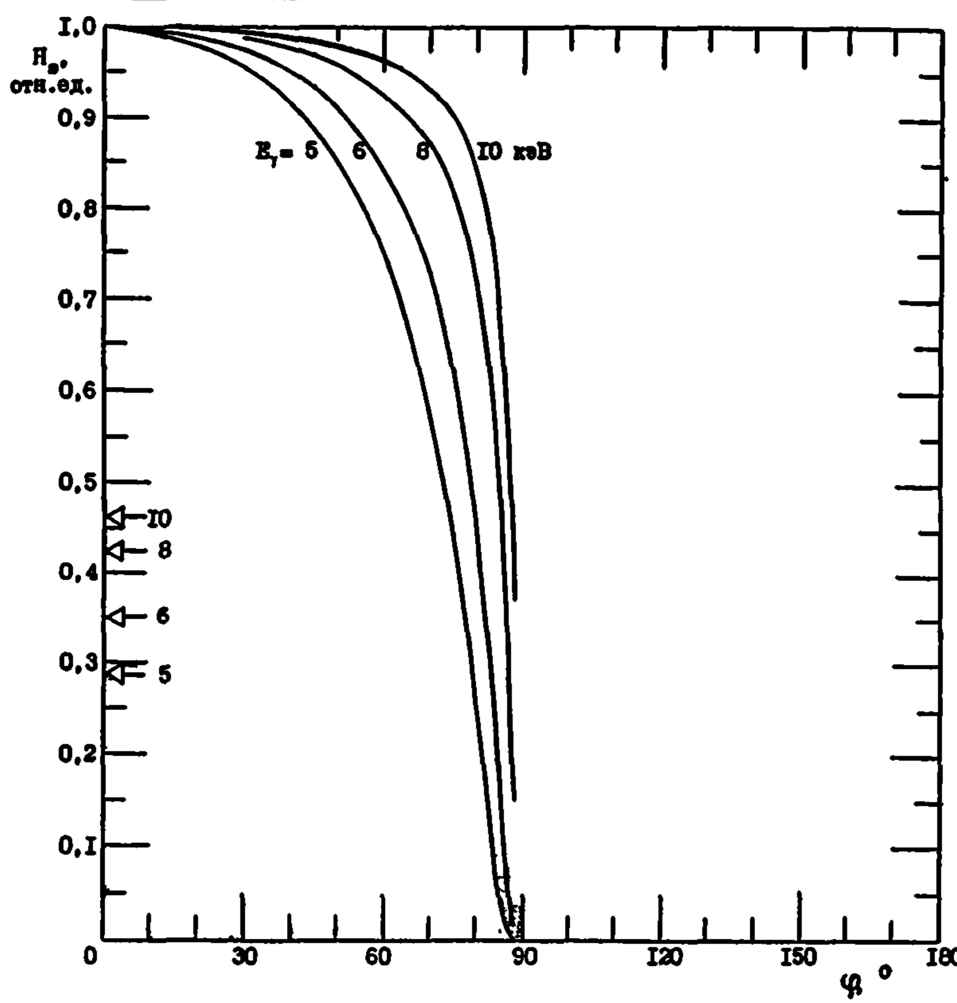
**Рис.7. Относительное угловое распределение эквивалентной дозы в коже. Относительное угловое распределение эквивалентной дозы в коже  $H_s(\phi)$ , нормированное на единицу при  $\phi = 0$ . Стрелками указаны средние значения  $H_s$  в угле  $2\pi$ . Цифры у стрелок и кривых – значения энергии фотонов  $E$ .**
