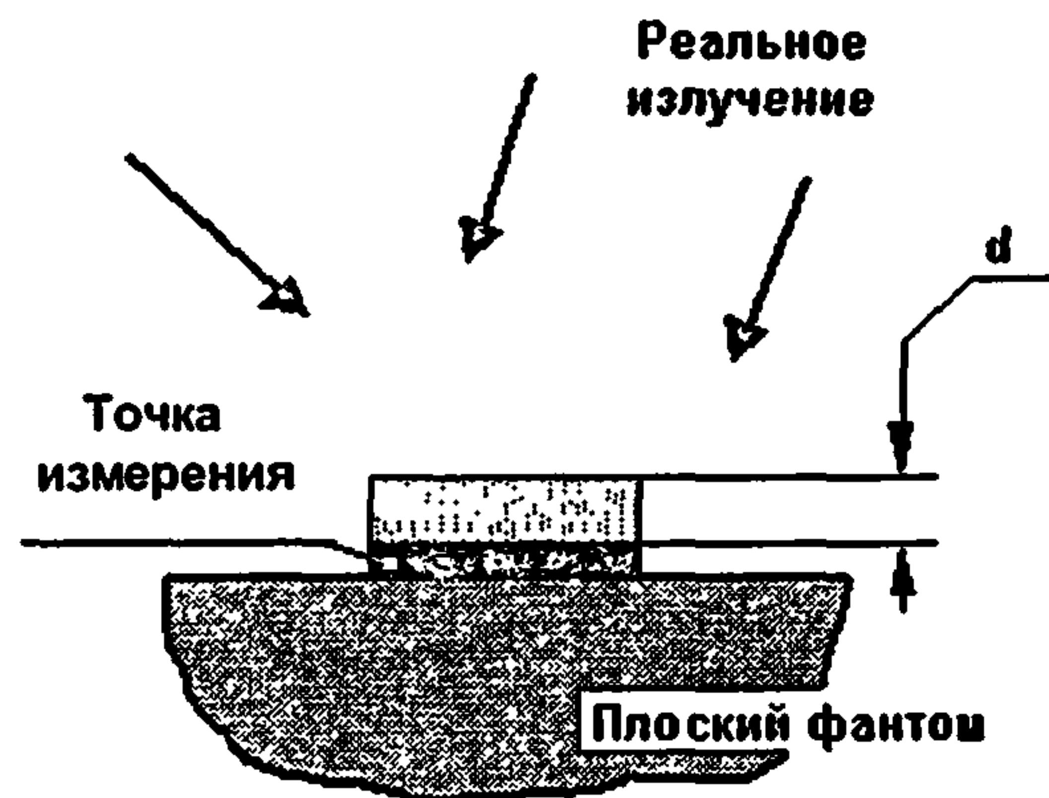
Рис.2. Схема определения  $H_p(d)$ .
