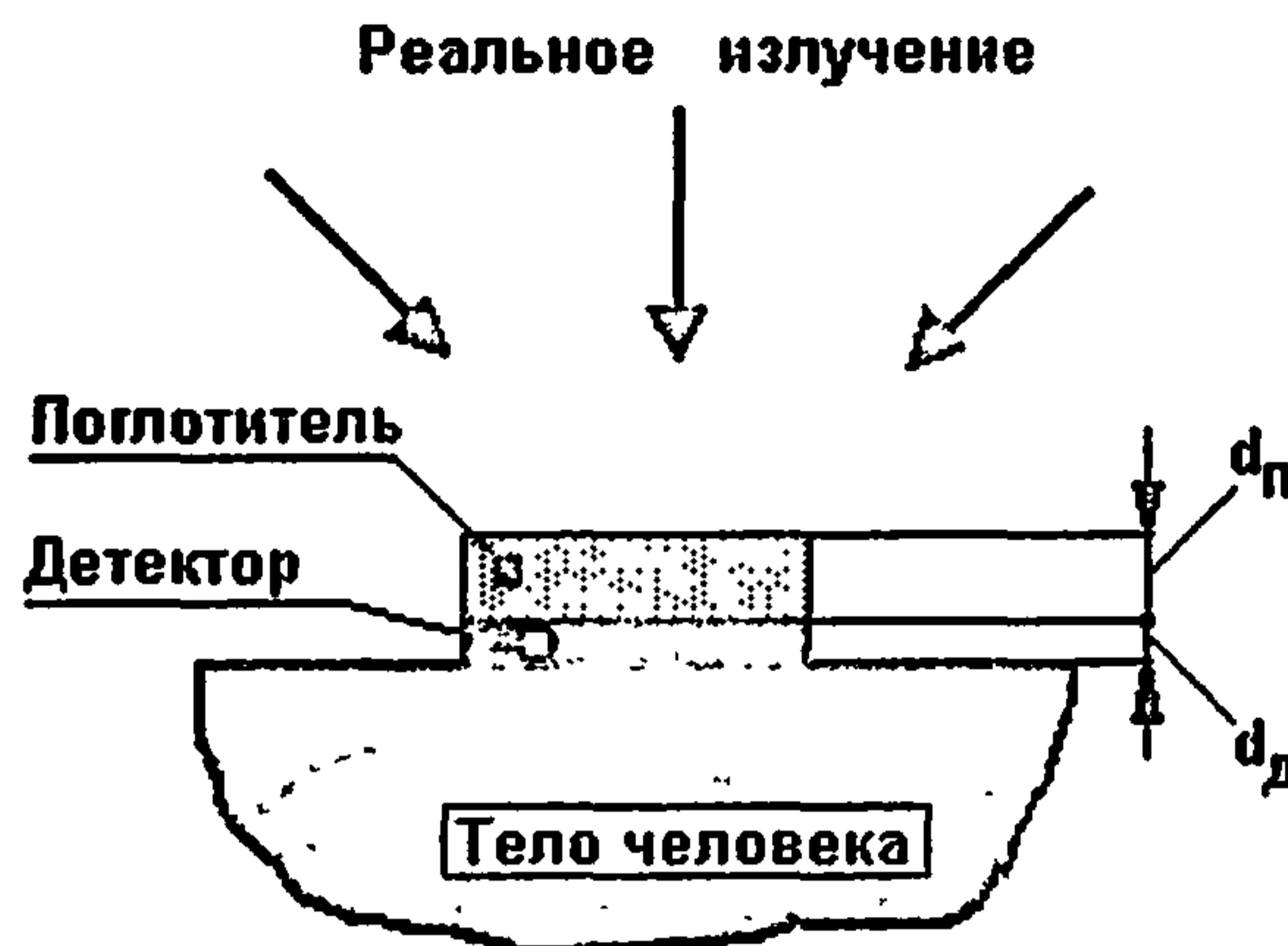
Рис.3. Принципиальная схема средства измерения, используемого для ИДК внешнего облучения;  $d_{\text{п}}$  – толщина поглотителя (кассеты дозиметра);  $d_{\text{д}}$  – толщина детектора.
