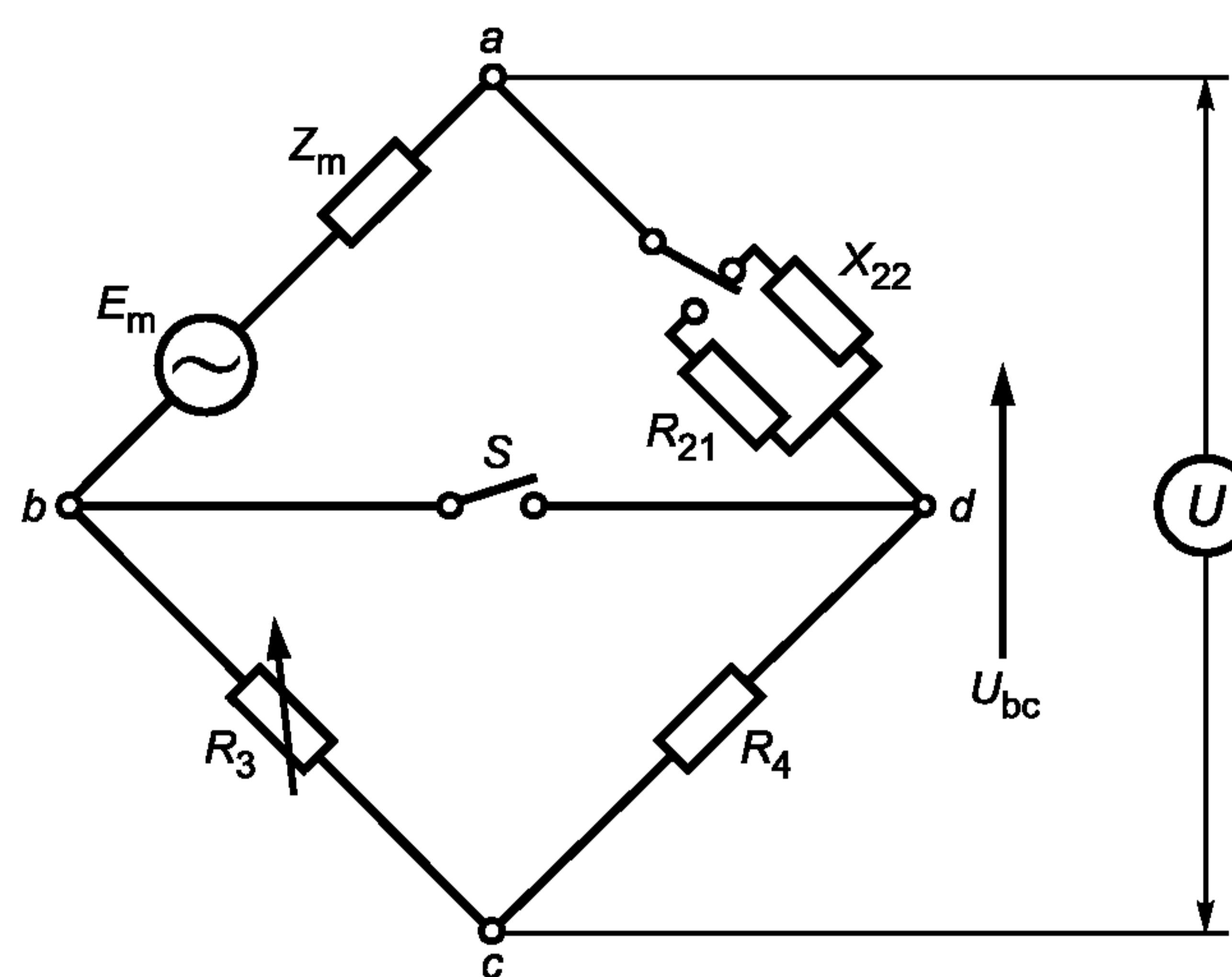
Рисунок G.1 — Мостовая схема
