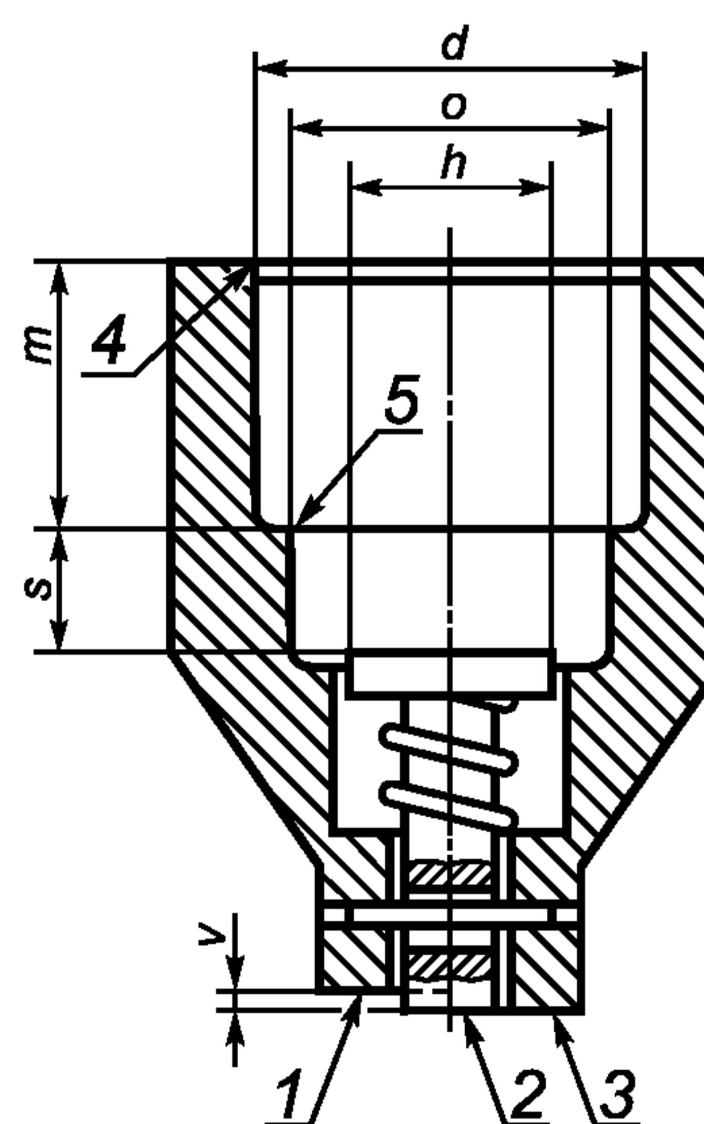
1 — поверхность X; 2 — поверхность W; 3 — поверхность Y; 4 — кромка слегка скошена; 5 — острая кромка
