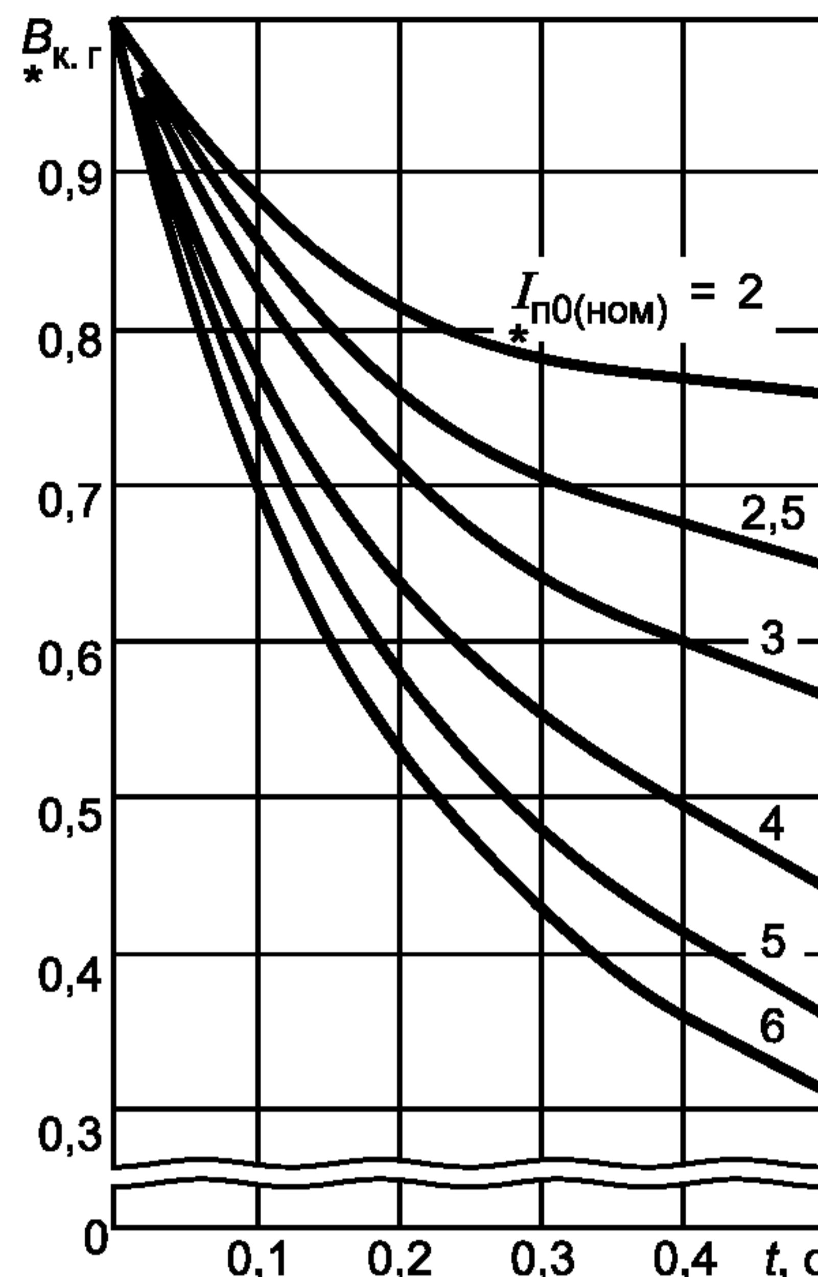
Рисунок 10 — Кривые для определения  $B_{k,g}$  от синхронных генераторов с тиристорной системой самовозбуждения
