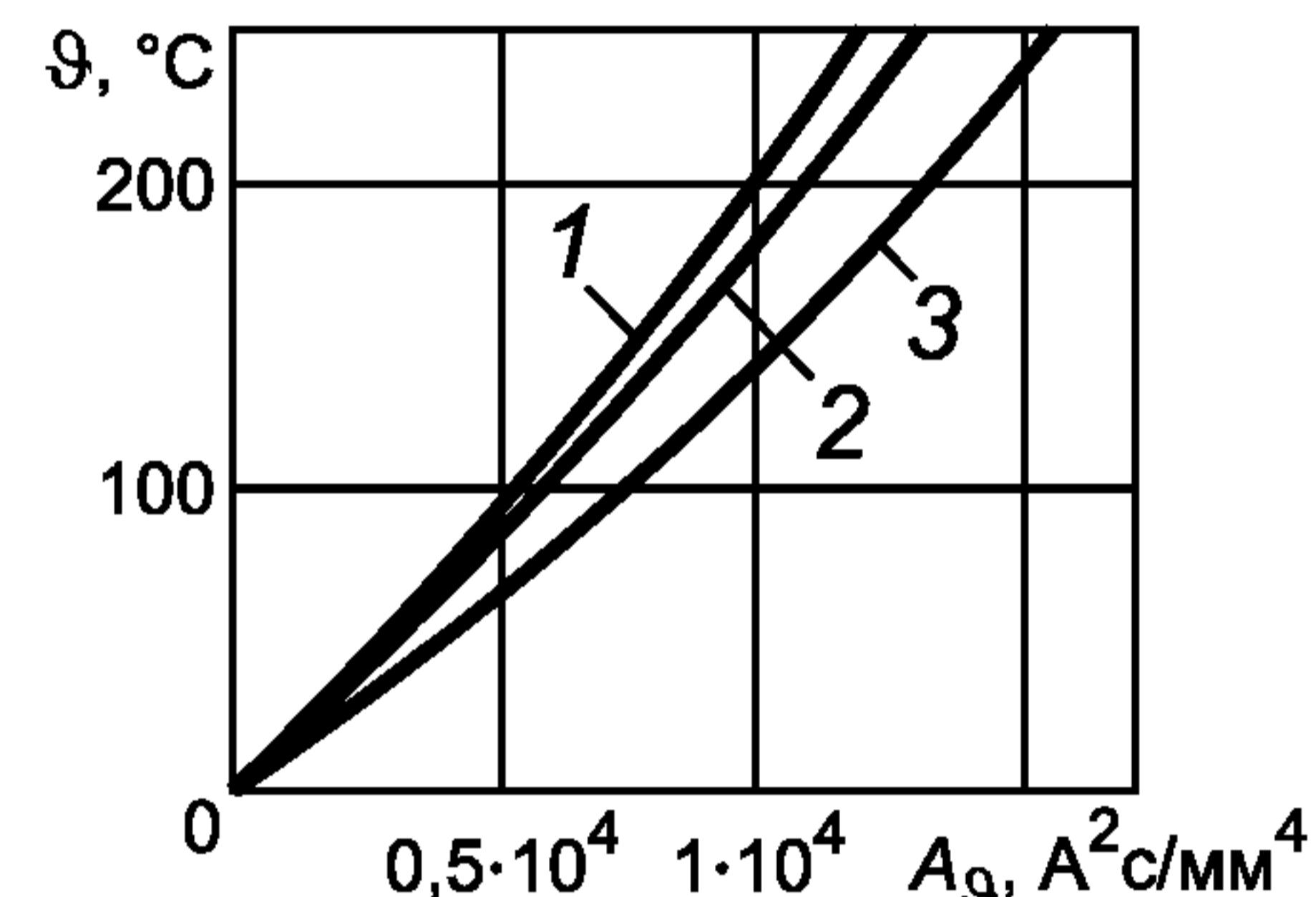
Материалы проводов: 1 — сплавы АЖ и АЖКП; 2 — сплавы АН и АНКП; 3 — алюминий марок А, АКП, АпКП и сталеалюминий марок АС, АСКП, АСКС, АСК, АпС, АпСКС, АпСК
