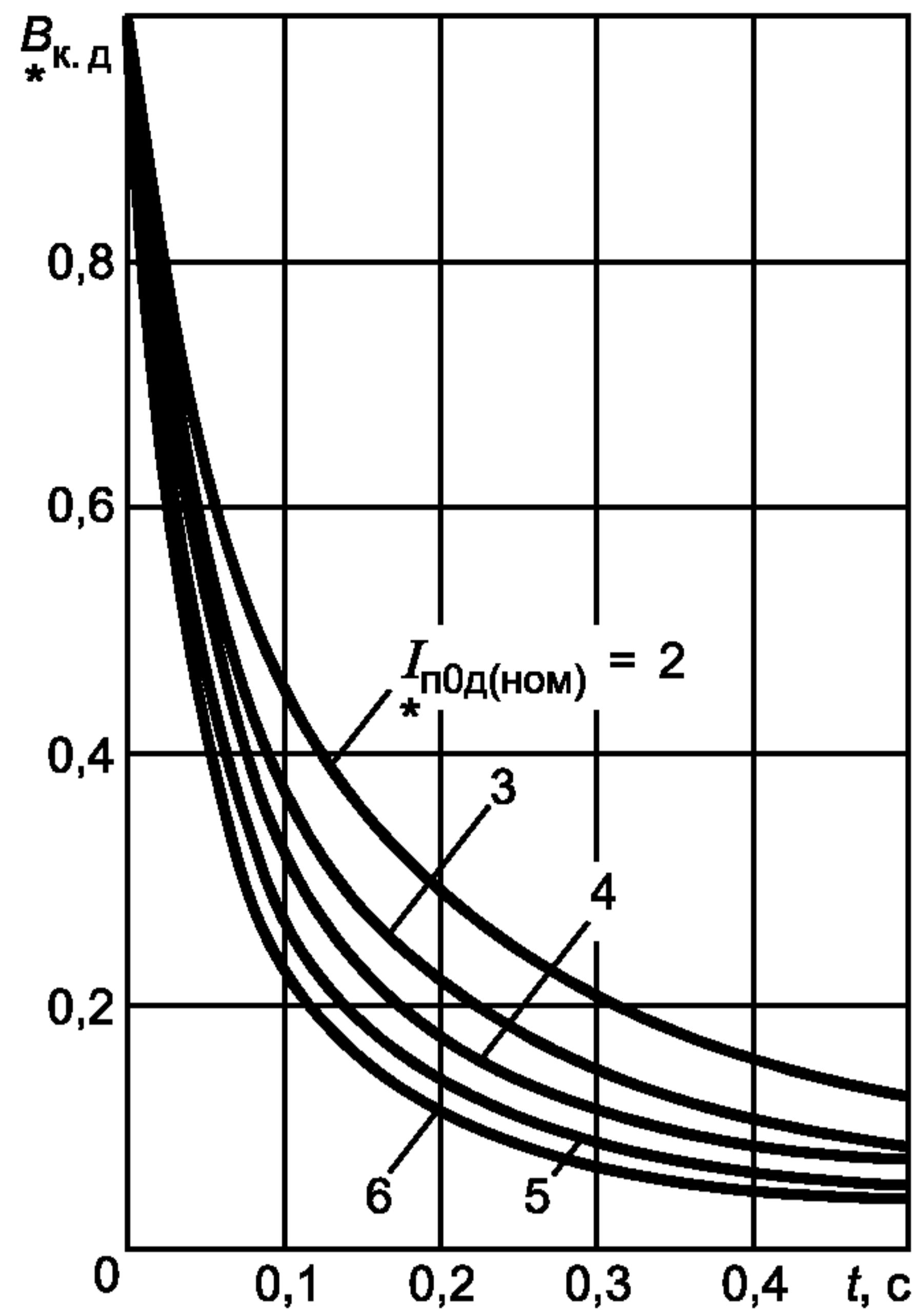
Рисунок 17 — Кривые для определения  $B_{\text{k.d}}$  от асинхронного электродвигателя
