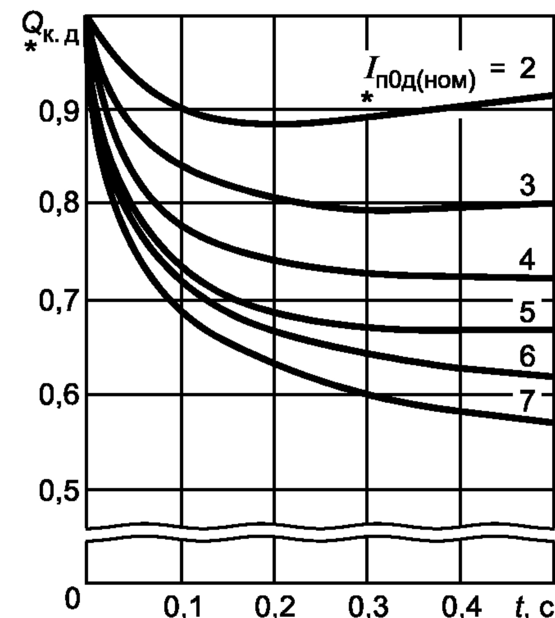
Рисунок 16 — Кривые для определения  $Q_{\text{k},\text{д}}$  от синхронного электродвигателя
