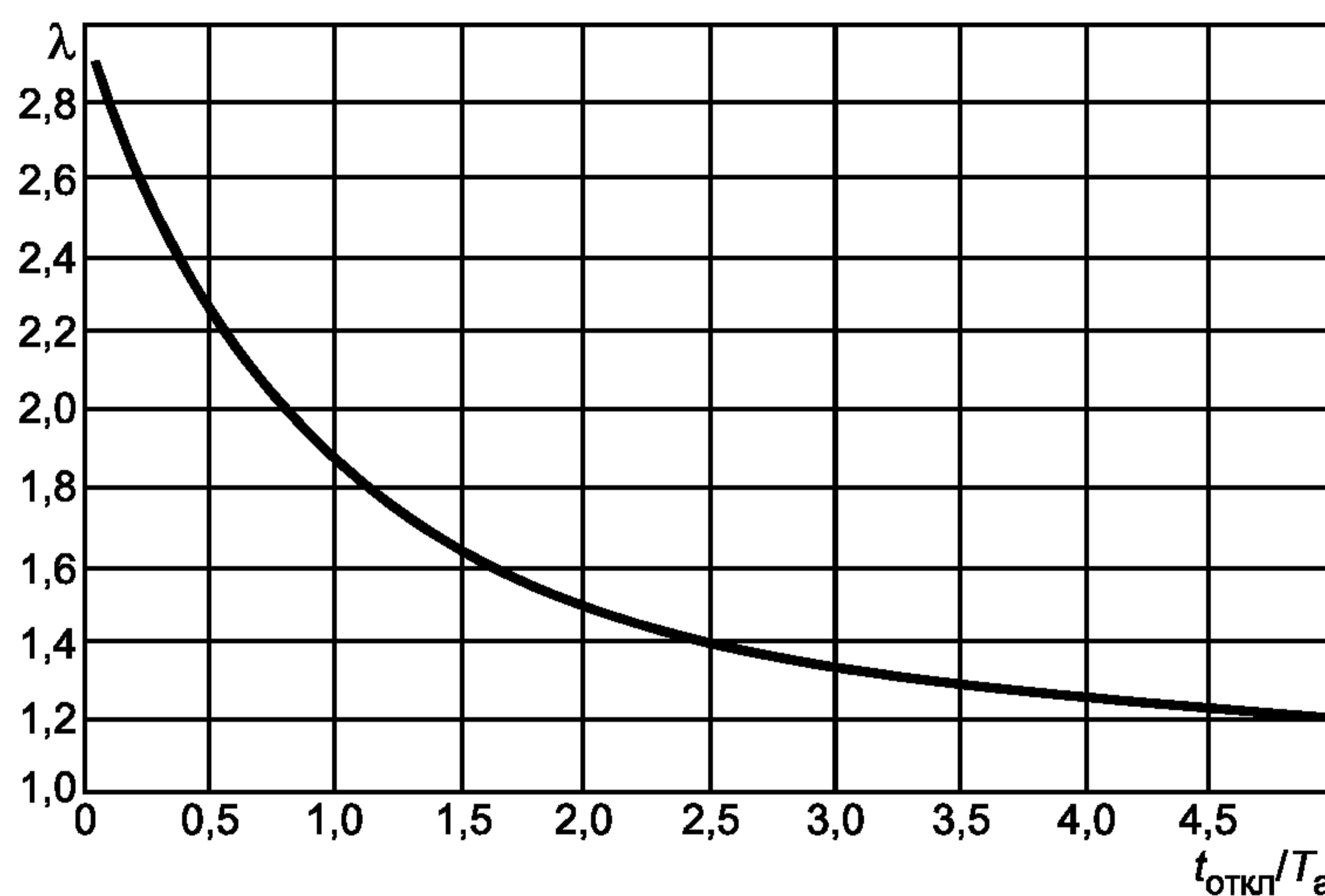
Рисунок В.1 — Зависимость коэффициента  $\lambda$  от  $t_{\text{откл}}/T_a$
