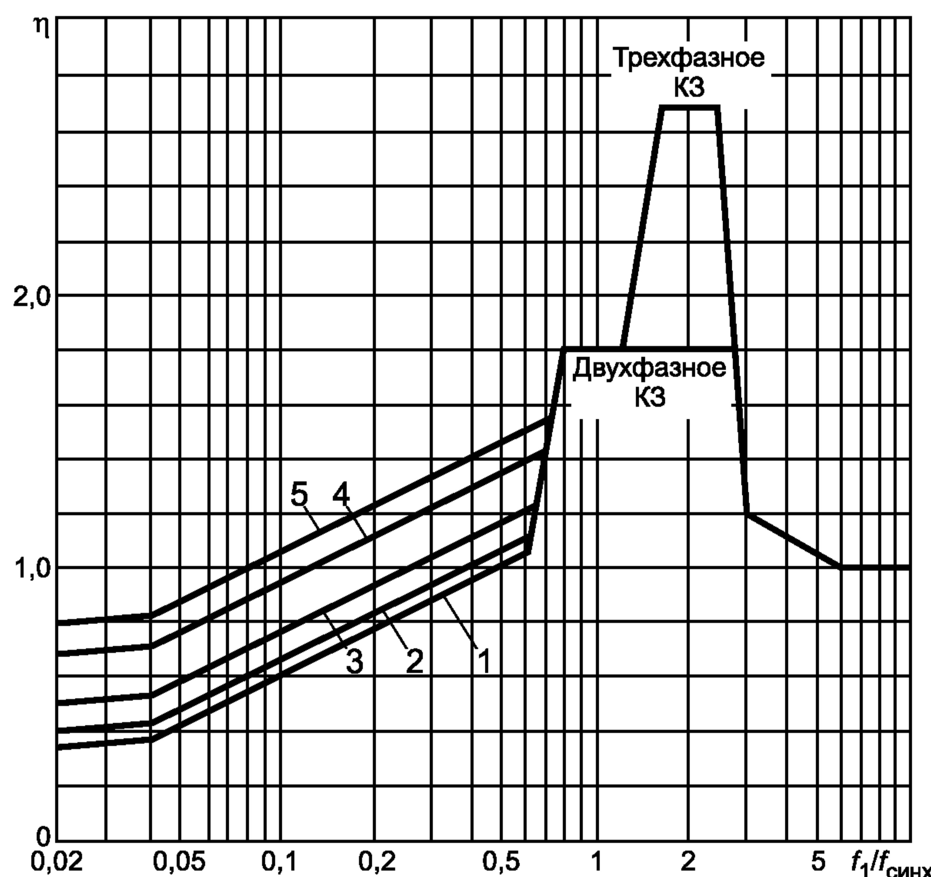
Рисунок 5 — Зависимость коэффициента динамической нагрузки для изоляторов и шин от частоты собственных колебаний шины при различных ударных коэффициентах  $\chi$ : 1 —  $\chi \geq 1,6$ ; 2 —  $\chi = 1,4$ ; 3 —  $\chi = 1,25$ ; 4 —  $\chi = 1,1$ ; 5 —  $\chi = 1,0$
