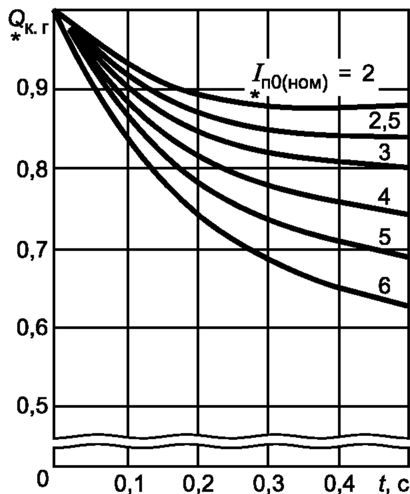
Рисунок 12 — Кривые для определения  $Q_{\text{k},\text{г}}$  от синхронных генераторов с тиристорной независимой системой возбуждения
