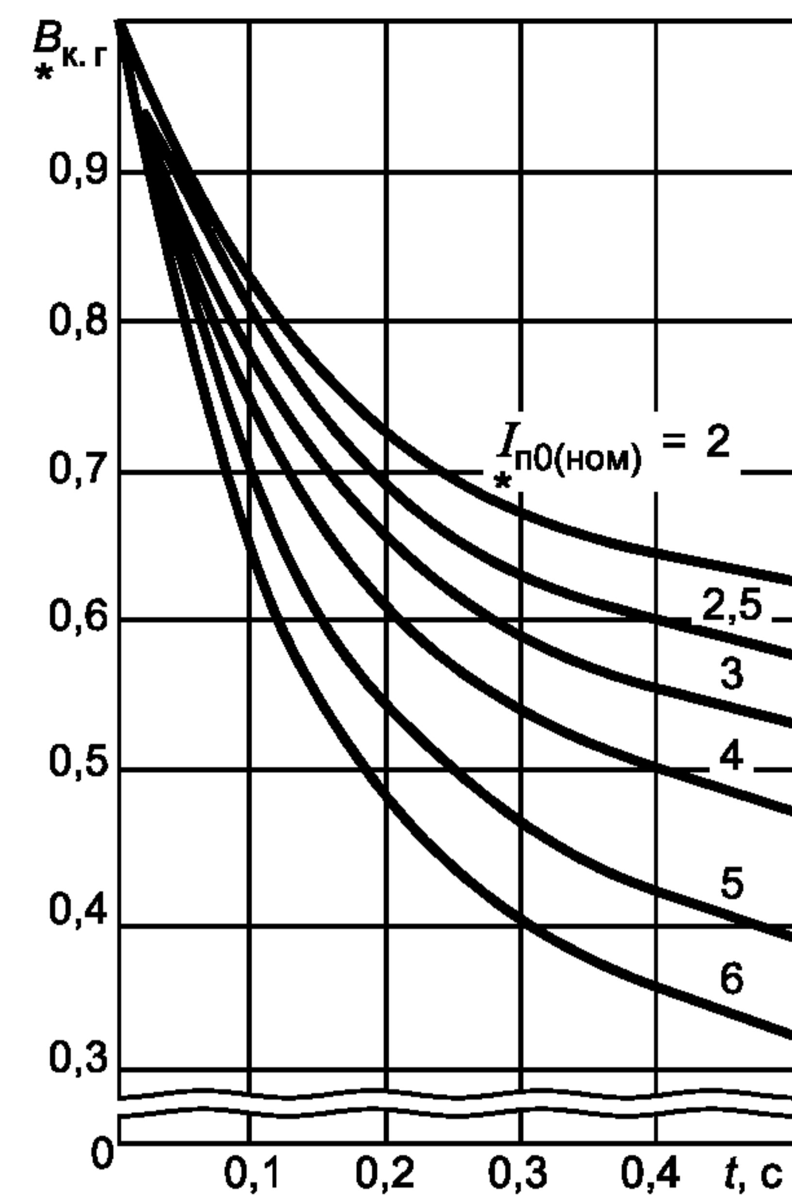
Рисунок 11 — Кривые для определения  $B_{k,g}$  от синхронных генераторов с диодной бесщеточной системой самовозбуждения
