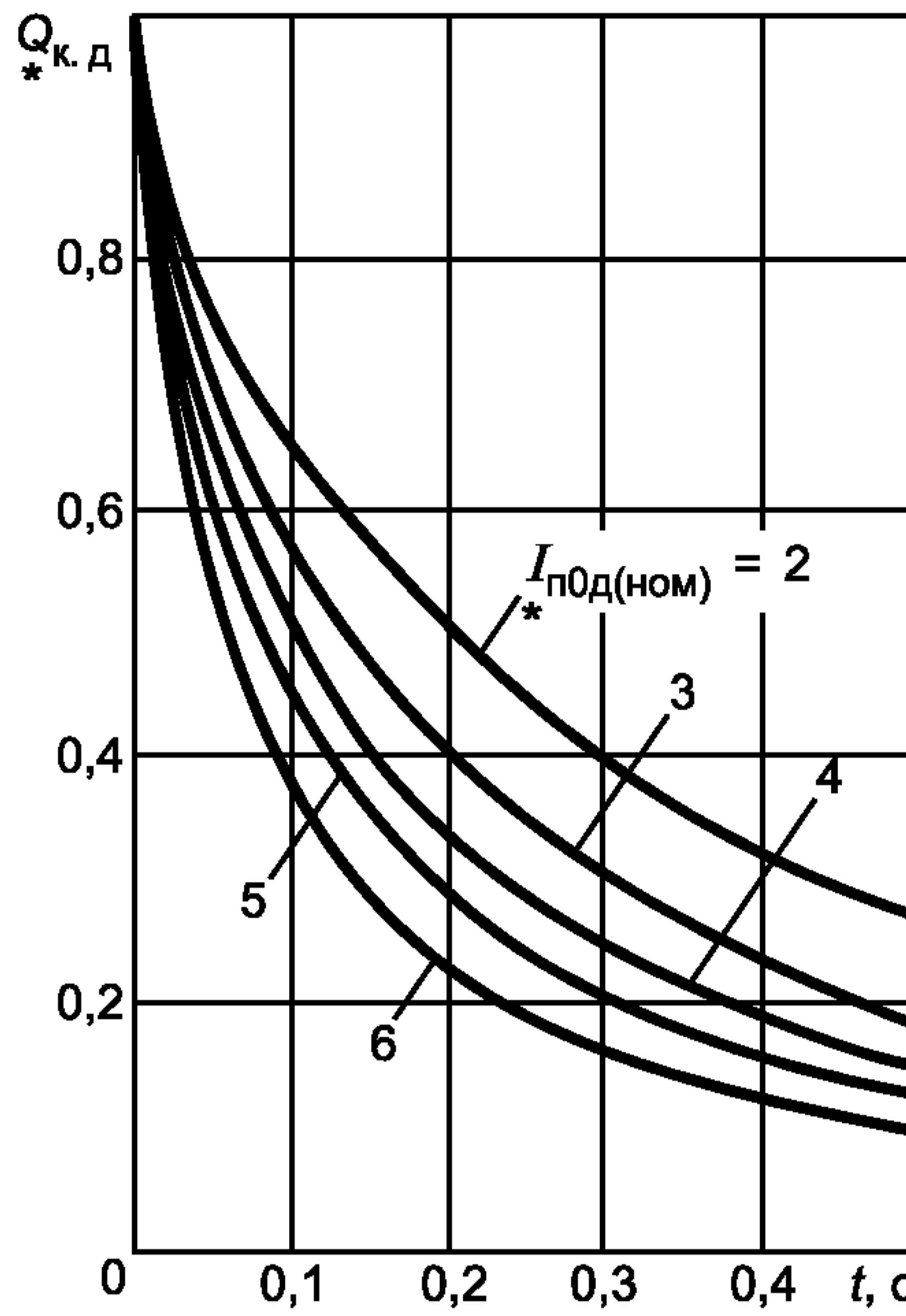
Рисунок 18 — Кривые для определения  $Q_{\text{k.d}}$  от асинхронного электродвигателя
