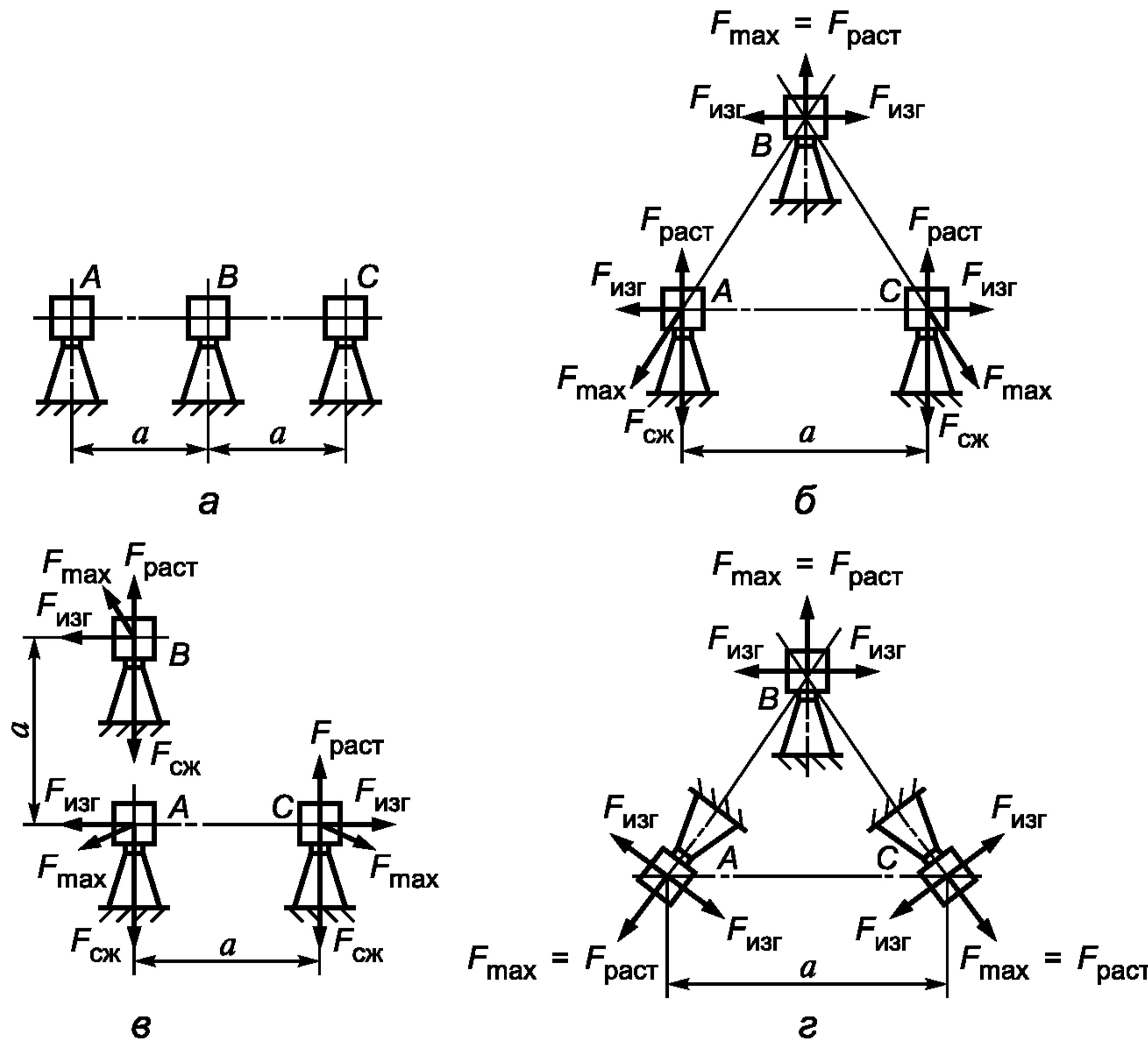
Рисунок 2 — Схемы взаимного расположения шинных конструкций
