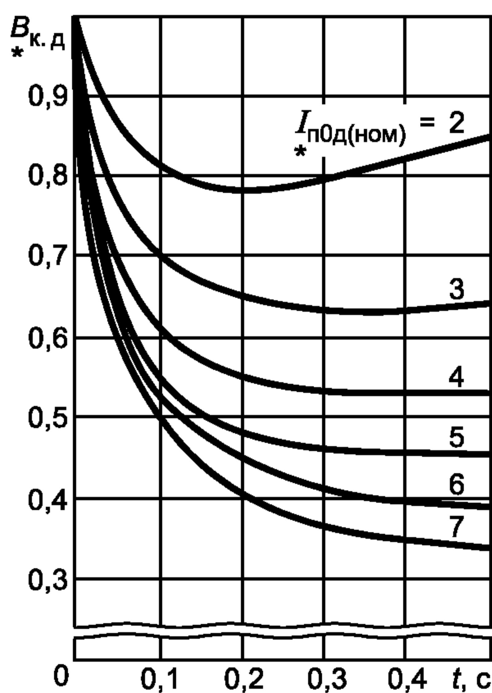
Рисунок 15 — Кривые для определения  $B_{\text{k},\text{д}}$  от синхронного электродвигателя
