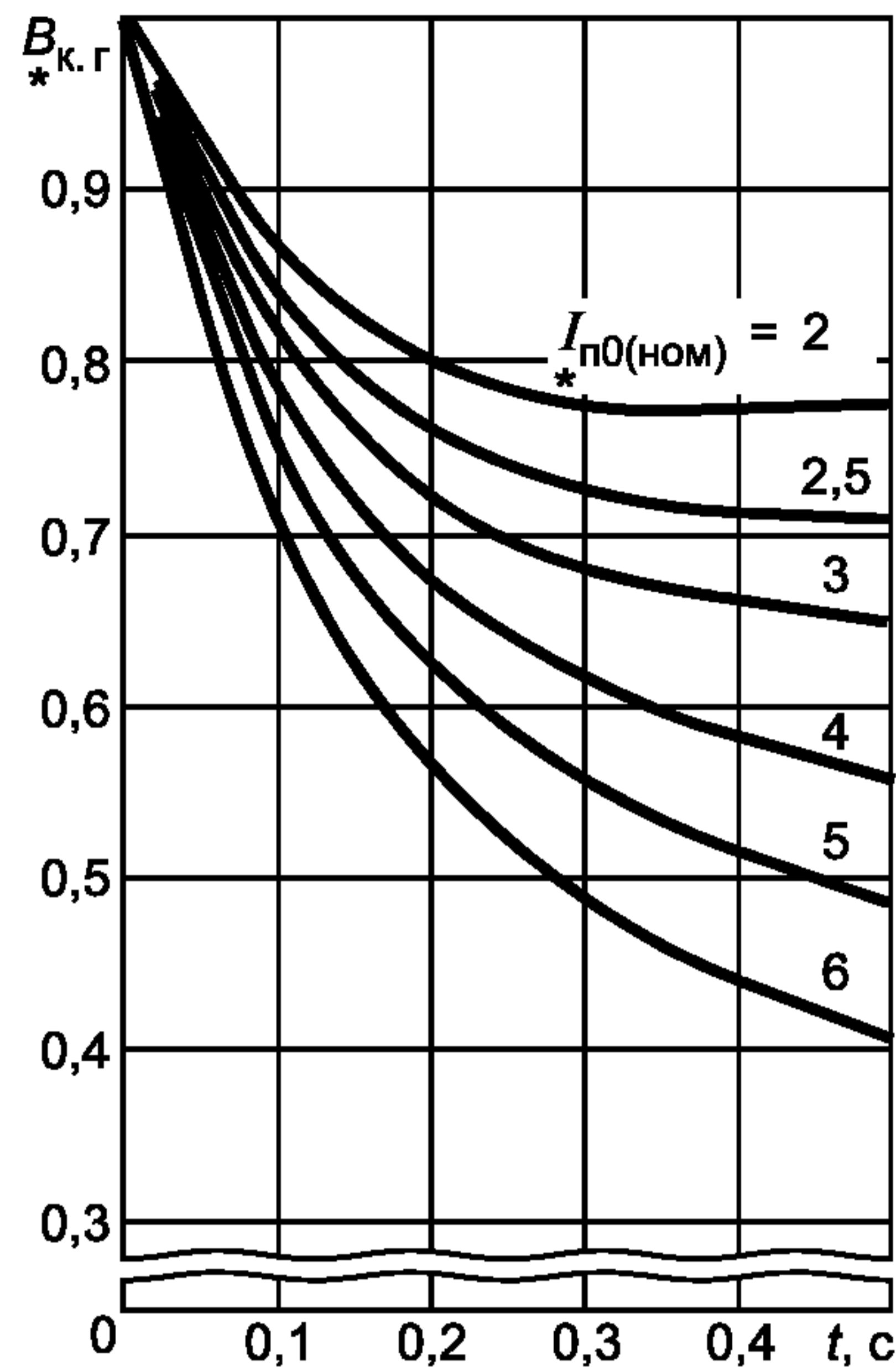
Рисунок 9 — Кривые для определения  $B_{k,g}$  от синхронных генераторов с тиристорной независимой системой возбуждения
