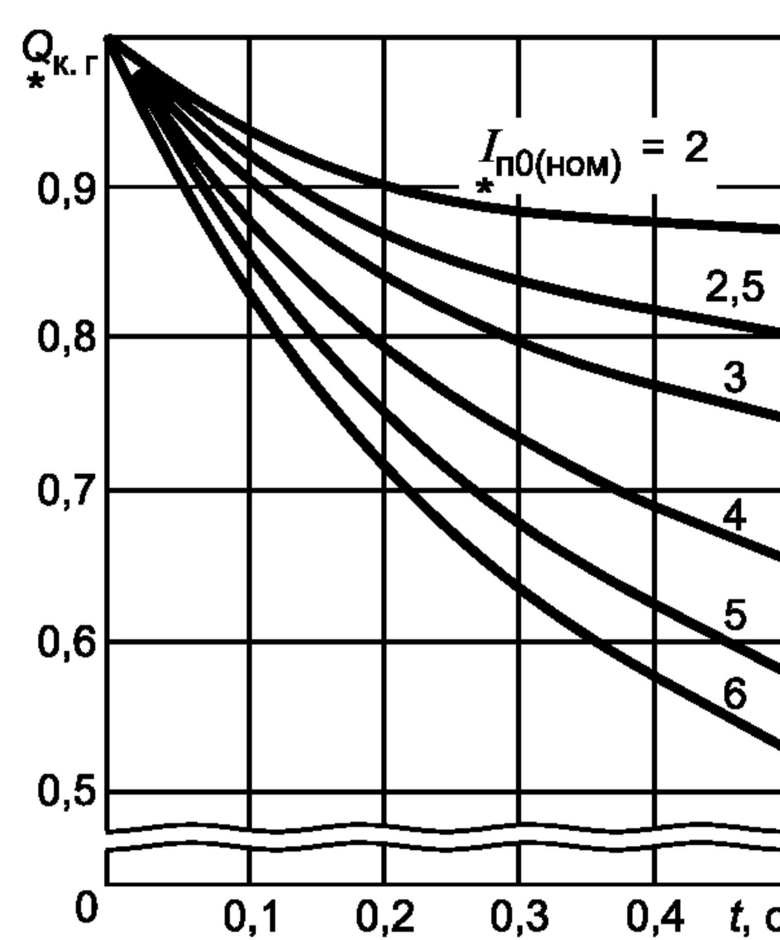
Рисунок 13 — Кривые для определения  $Q_{\text{k},\text{г}}$  от синхронных генераторов с тиристорной системой самовозбуждения
