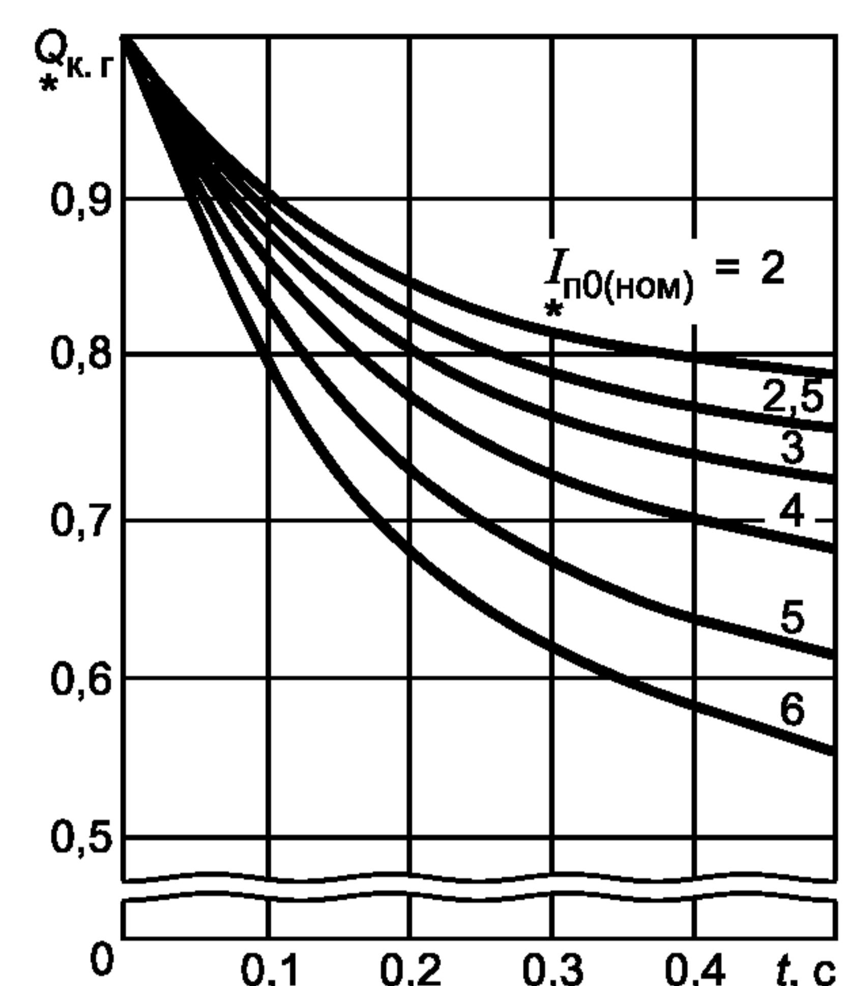
Рисунок 14 — Кривые для определения  $Q_{\text{k},\text{г}}$  от синхронных генераторов с диодной бесщеточной системой самовозбуждения
