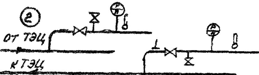
Черт. 2 Узлы подключения систем обогрева импульсных линий СА
