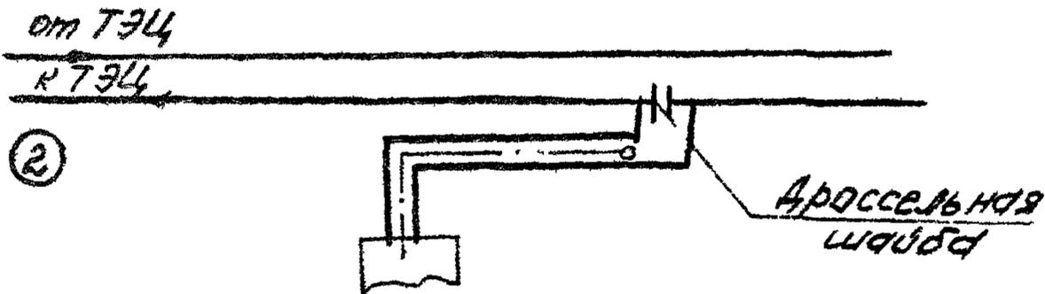
Черт. 1 Схемы обогрева импульсных линий СА
