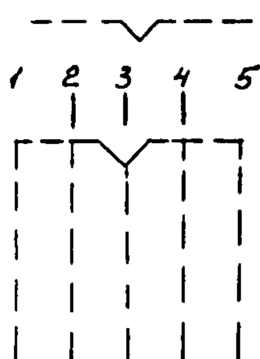
обозначение фиксирующего механизма по ГОСТ 2.721-74;
