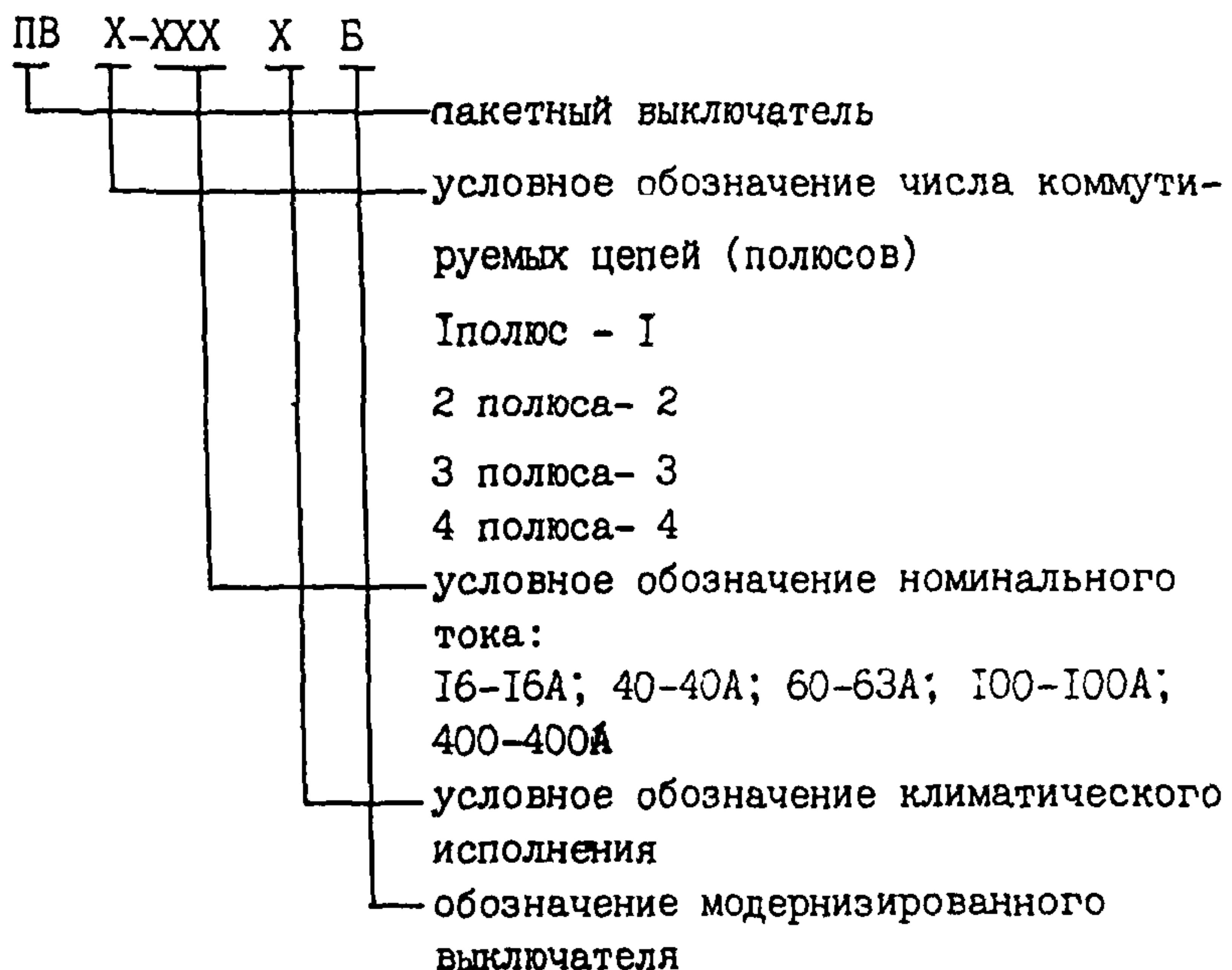
Пример условного обозначения выключателя
