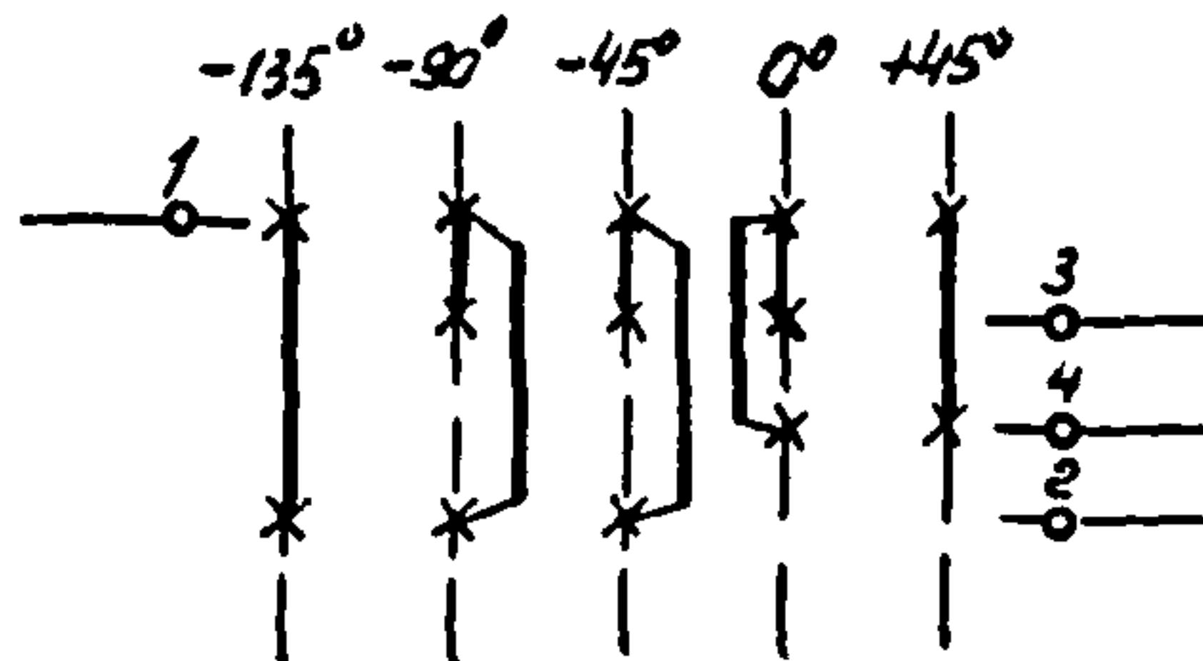
Вертикальные и горизонтальные линии, цифры, кружочки и (x) в приведенном условном графическом обозначении переключателя имеют то же назначение, что и в примере п. I.3.
