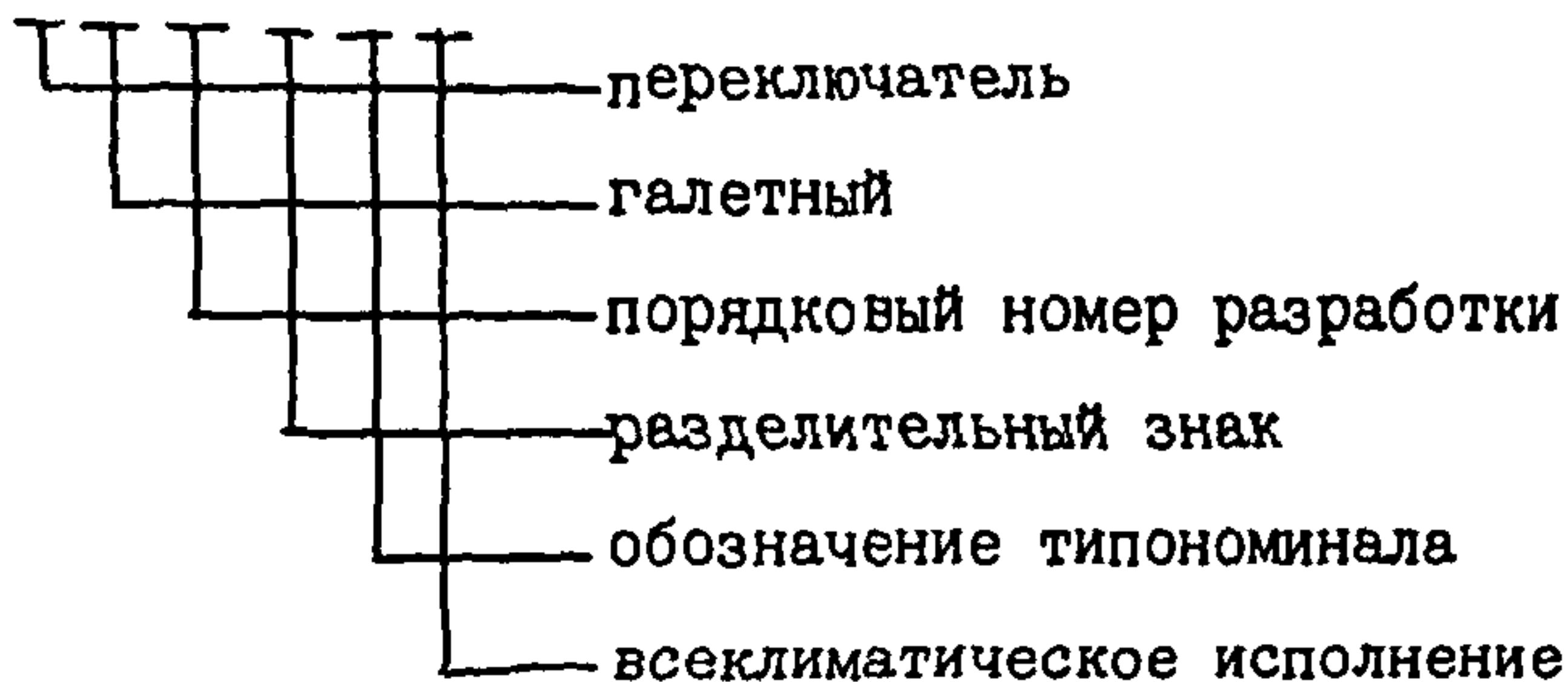
Соответствие обозначений типономиналов и электрических схем переключателей приведено в табл. 21.
