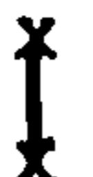
на штриховой линии (положении рукоятки переключателей), где  $x$  — функция выключателя — позиция замыкания соответствующих контактов;
