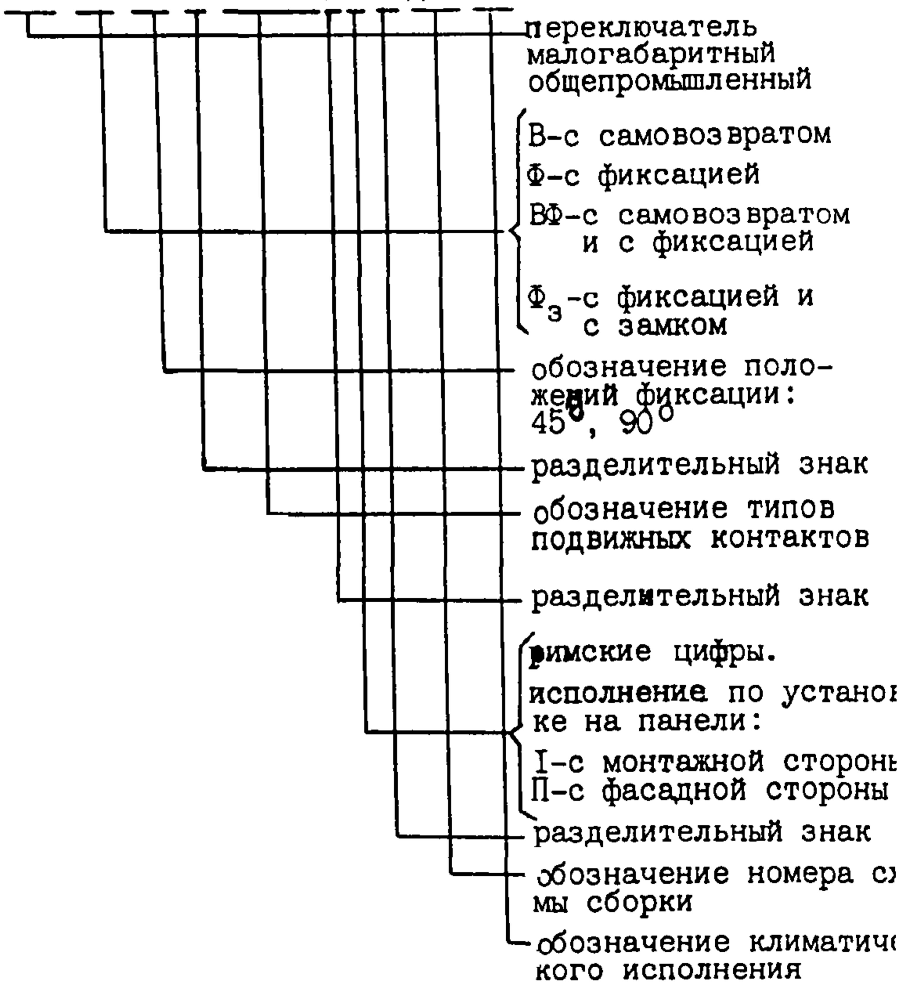
Пример условного обозначения переключателя ПМОФ с фиксацией рукоятки через 90°, предназначенного для установки с фасадной стороны панели при заказе:
