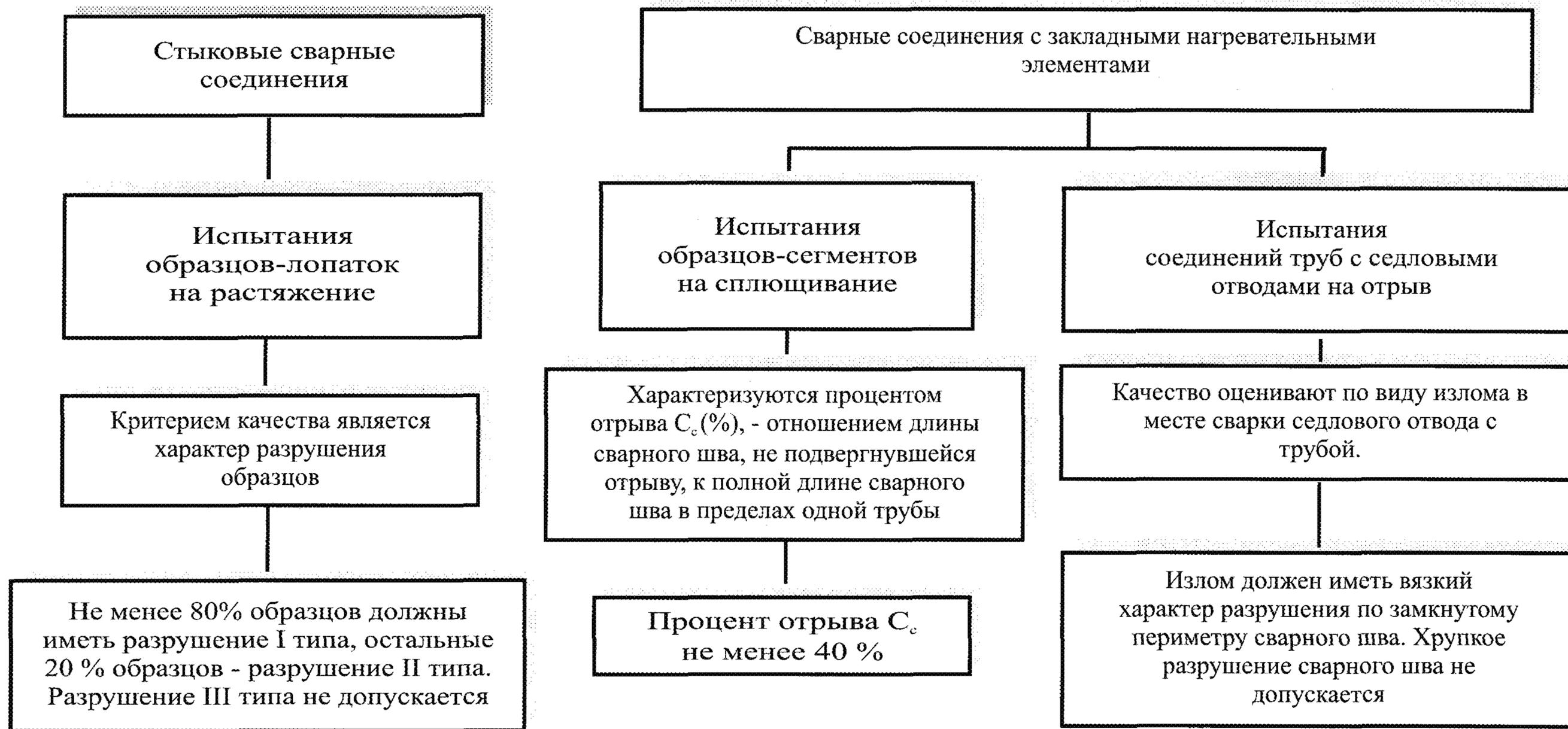
Иллюстрации к процессу механических испытаний
