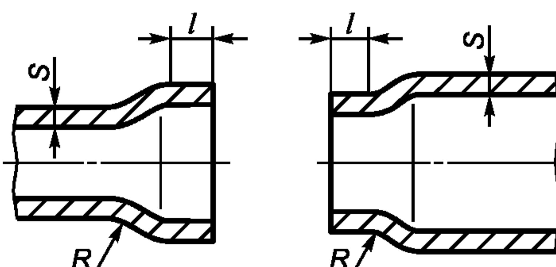
Рисунок 5 — Отбортованный и переходный элемент
