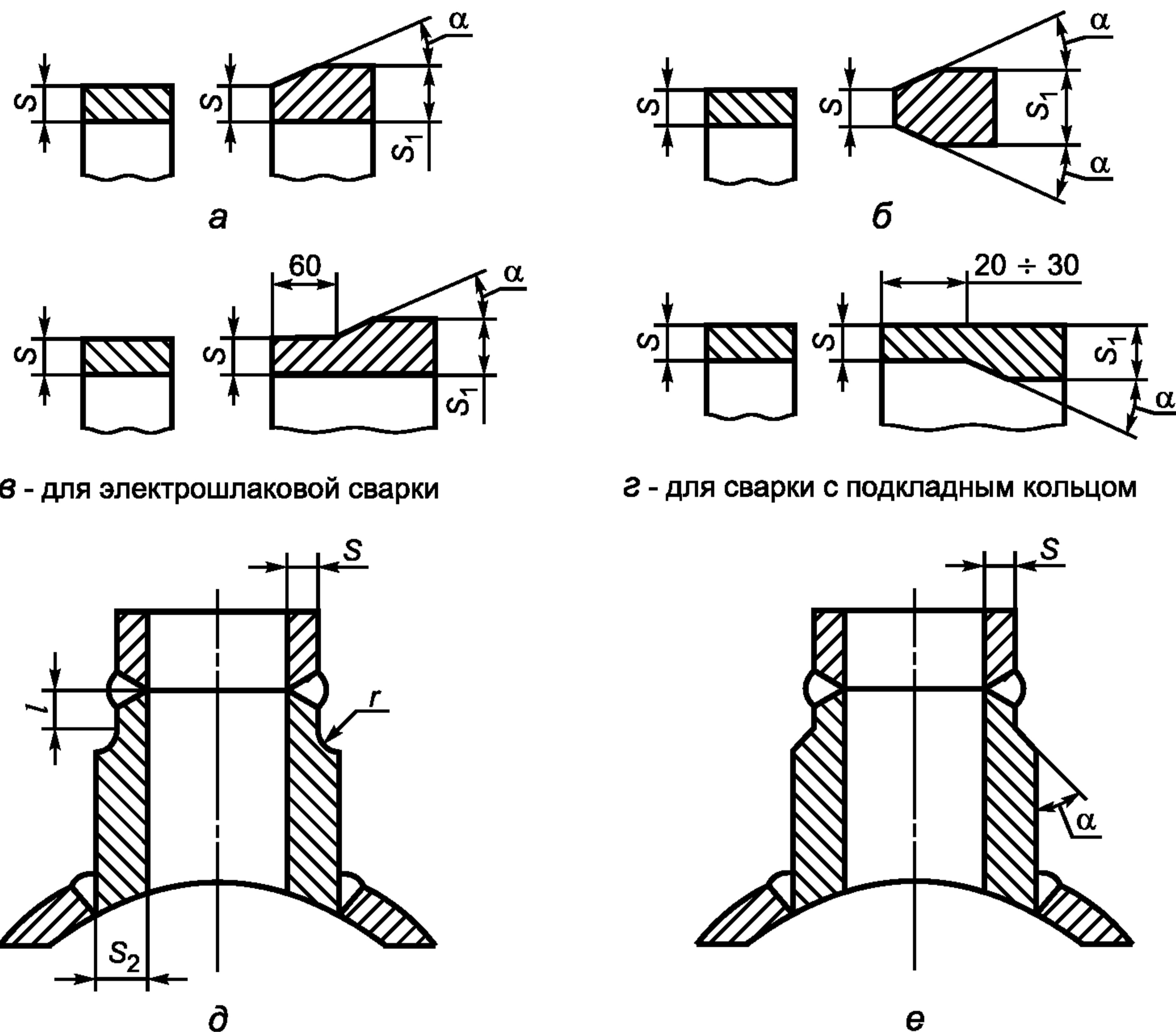
Рисунок 14 — Стыковка элементов разной толщины
