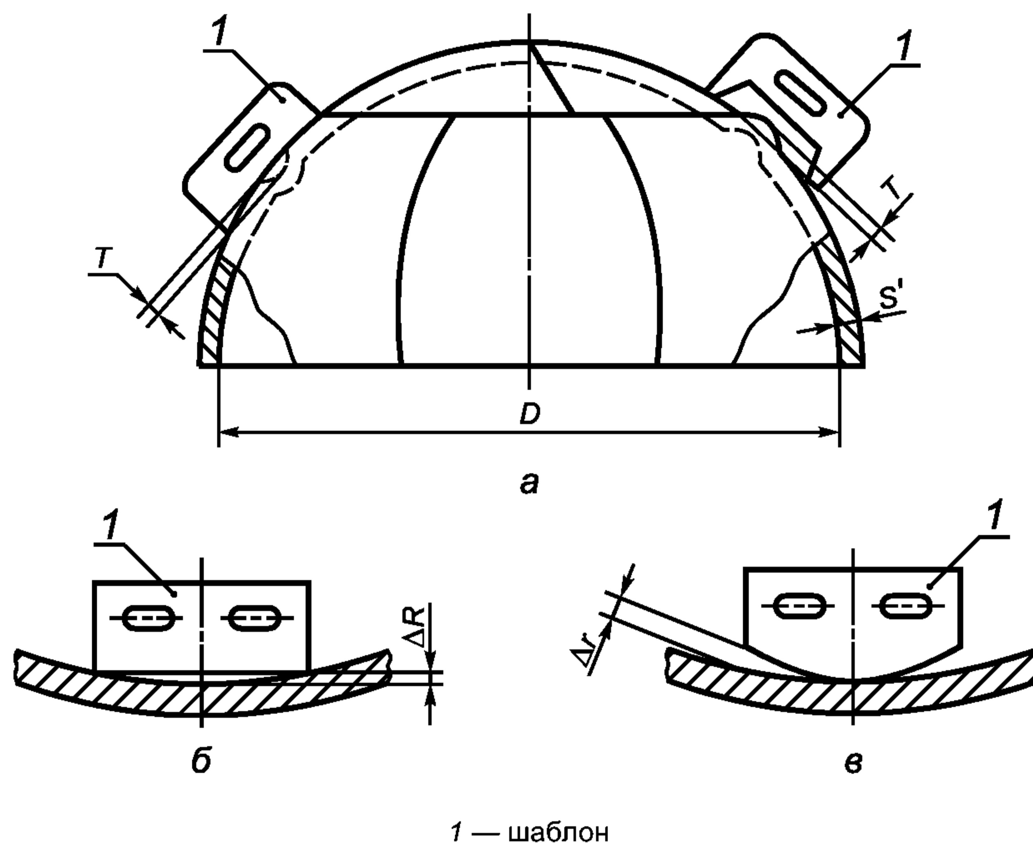
Рисунок 7 — Отклонение формы полусферического днища
