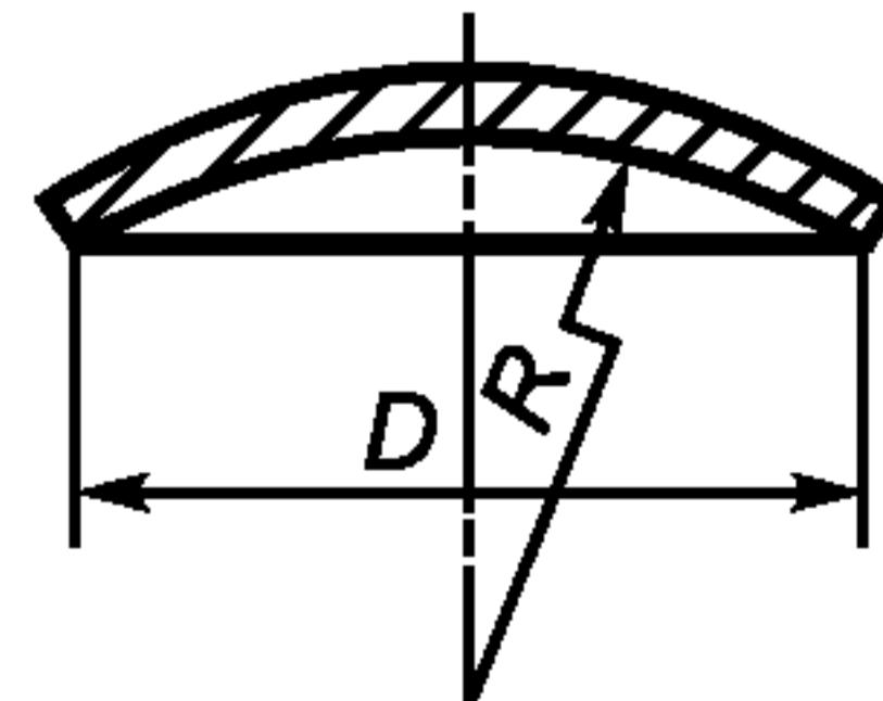
Рисунок 3 — Сферическое неотбортованное днище
