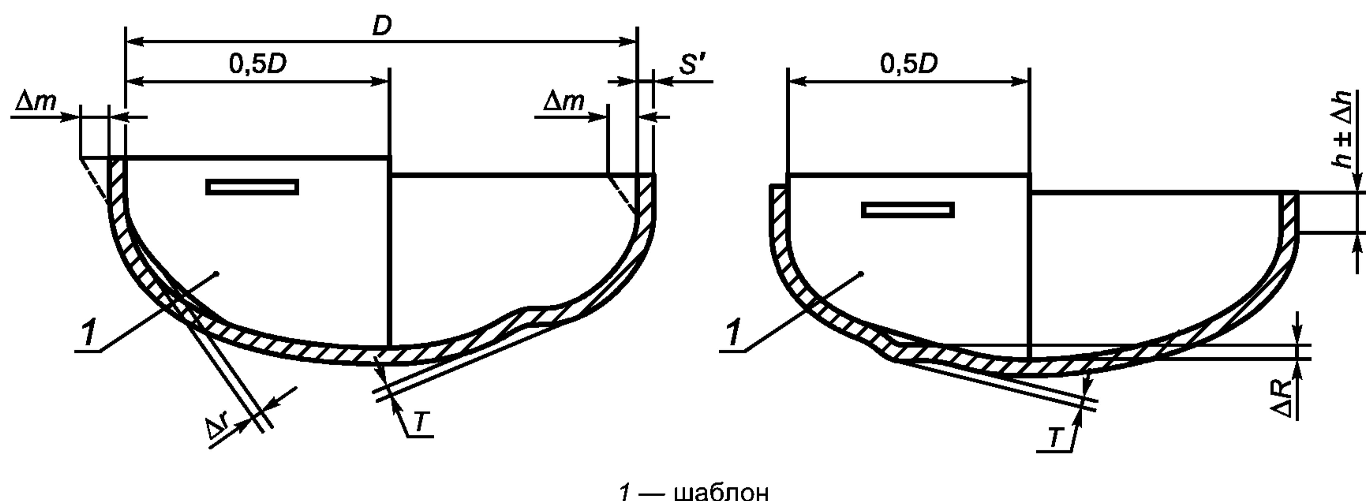
Рисунок 6 — Отклонение размеров и формы эллиптического днища
