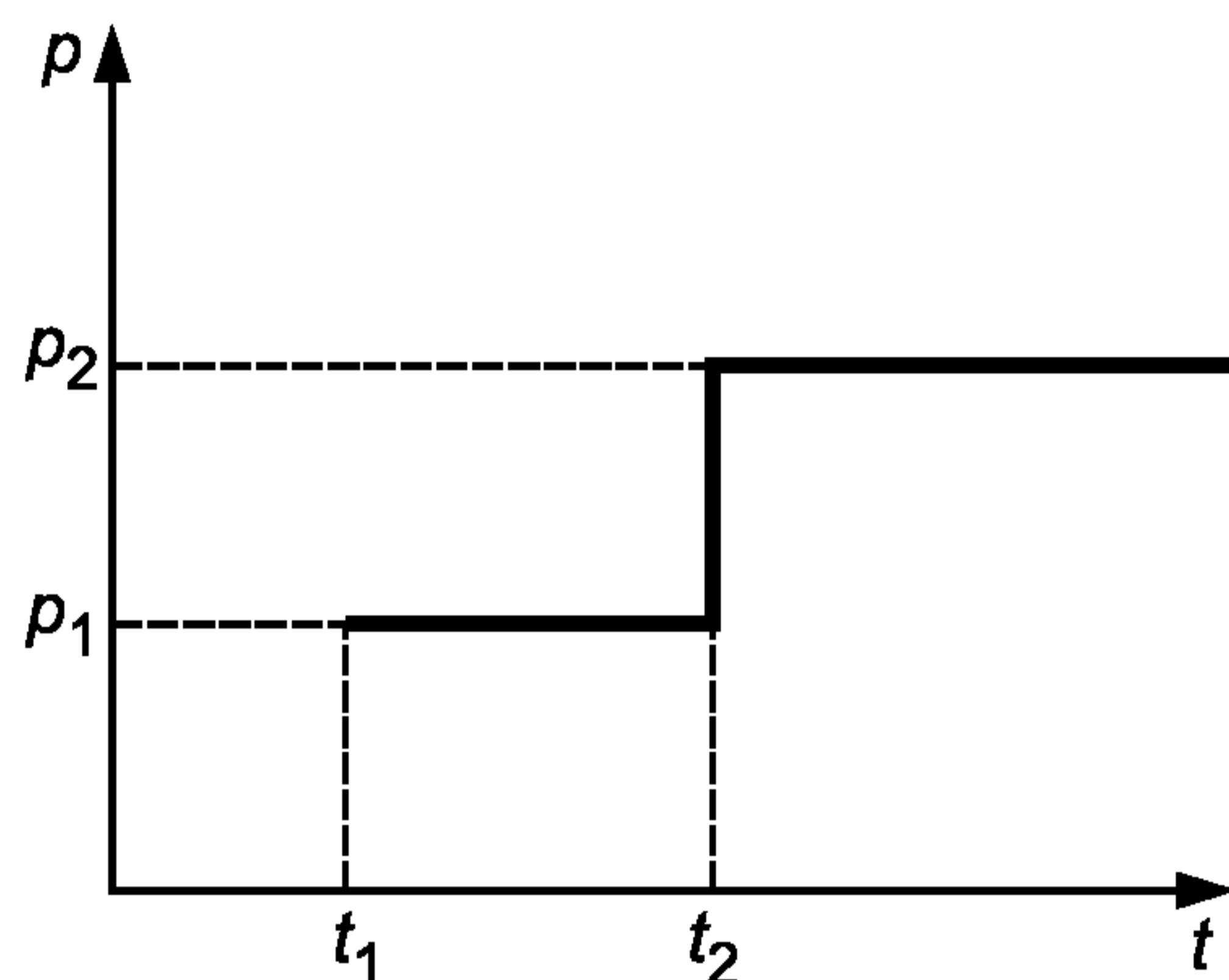
$p_1$  — давление пуска;  $p_2$  — рабочее давление;  $t_1$  — наименьшая температура воздуха, при которой допускается пуск сосуда под давлением  $p_1$ ;  $t_2$  — минимальная температура, при которой сталь и ее сварные соединения допускаются для работы под давлением в соответствии с требованиями приложений А—Д.
