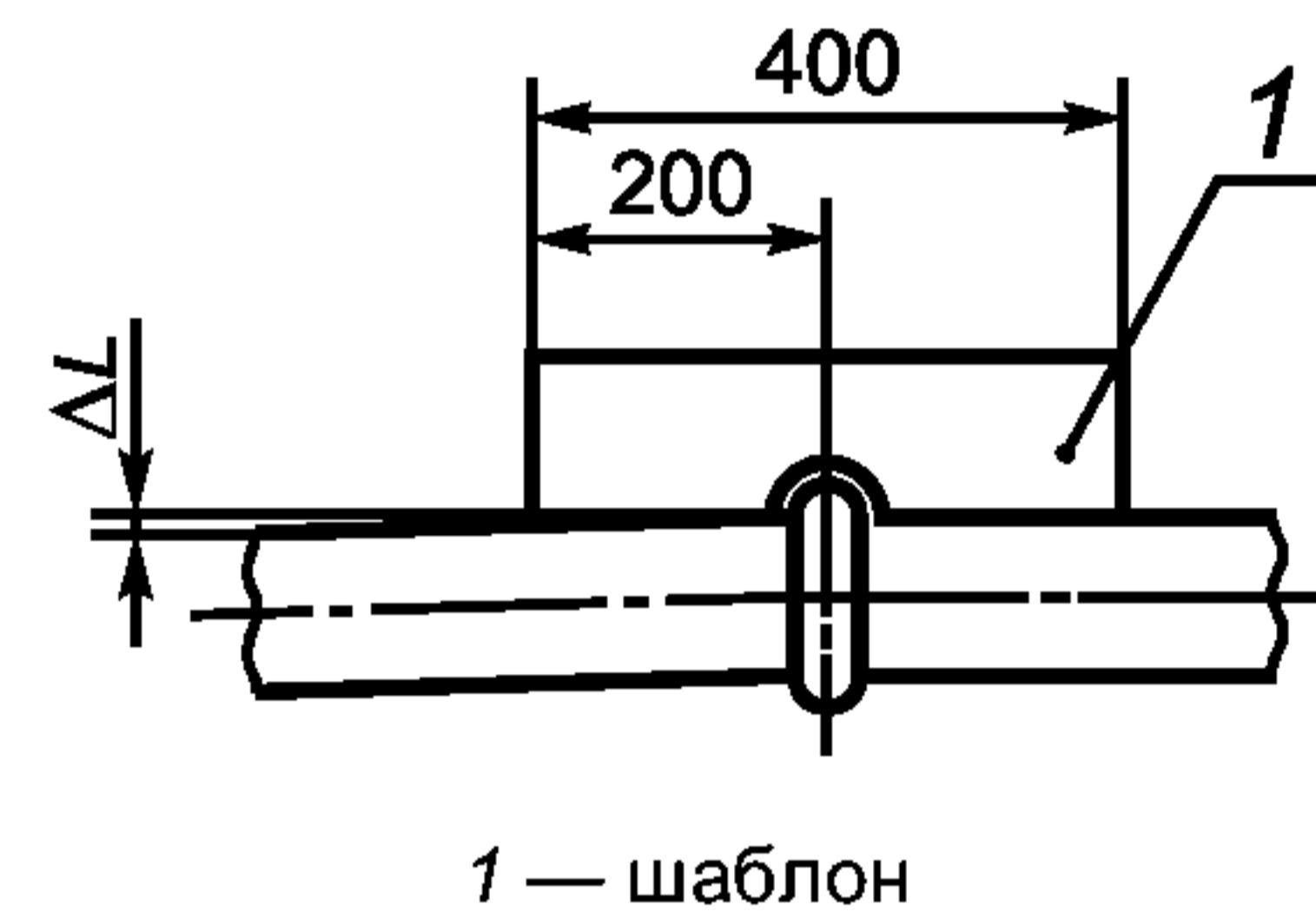
Рисунок 11 — Схема определения отклонения от прямолинейности оси трубы
