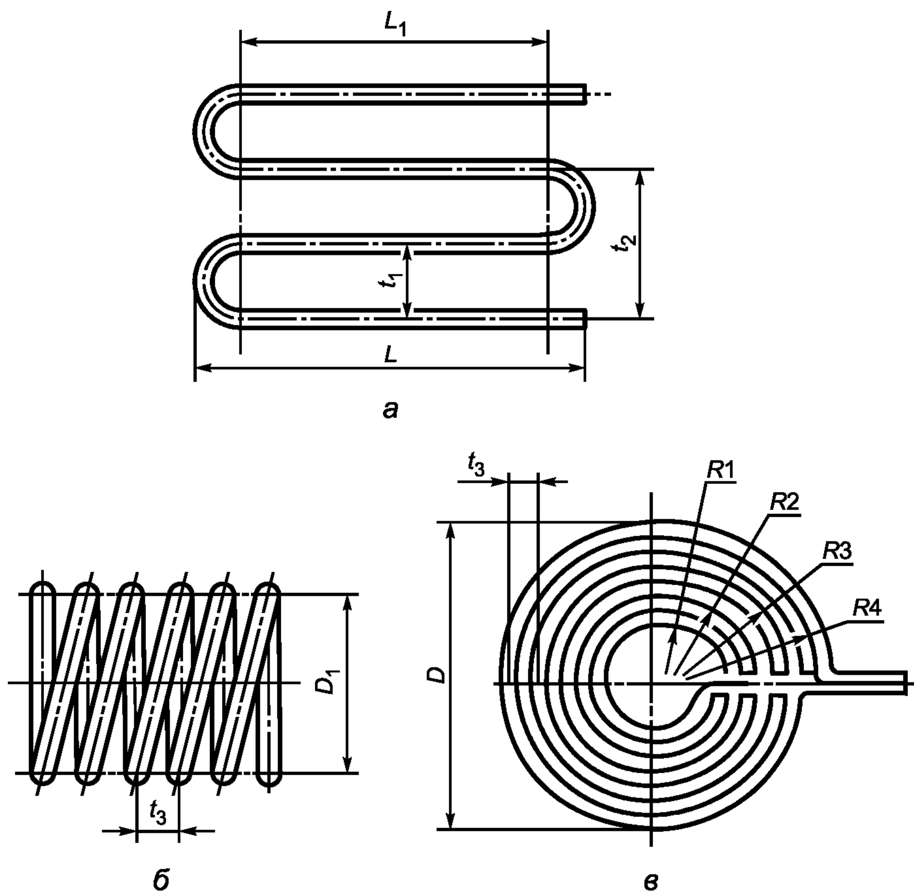
Рисунок 12 — Размеры гнутых змеевиков
