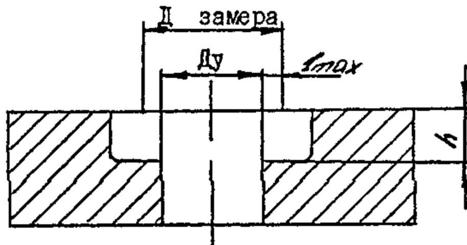
В. Коническое уплотнение с фаской глубиной более 2 мм
