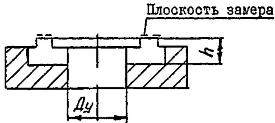
Б. Коническое уплотнение с фаской глубиной до 2 мм
