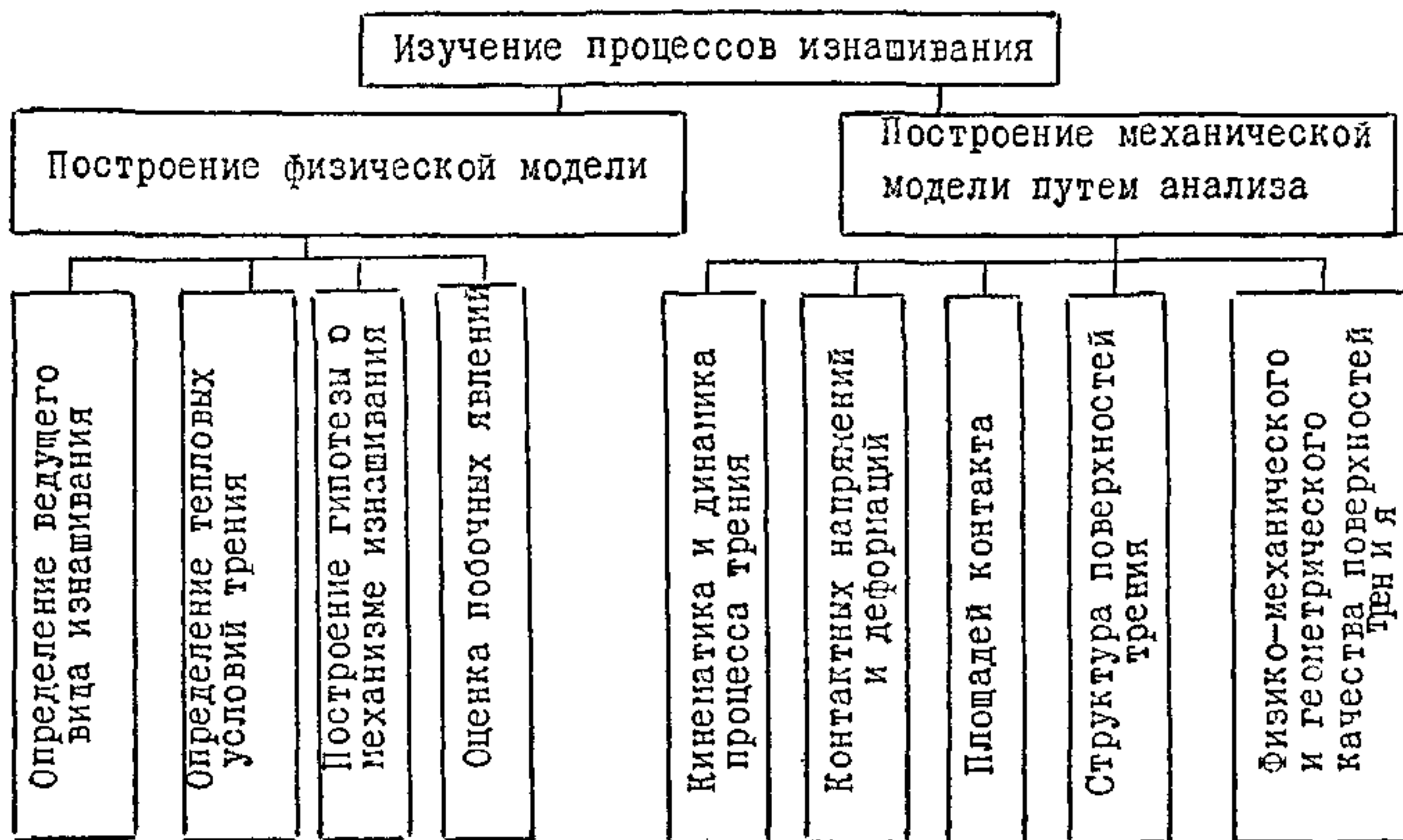
Рис. I. Основные вопросы методики ускоренных испытаний при доминирующем влиянии процессов изнашивания.
