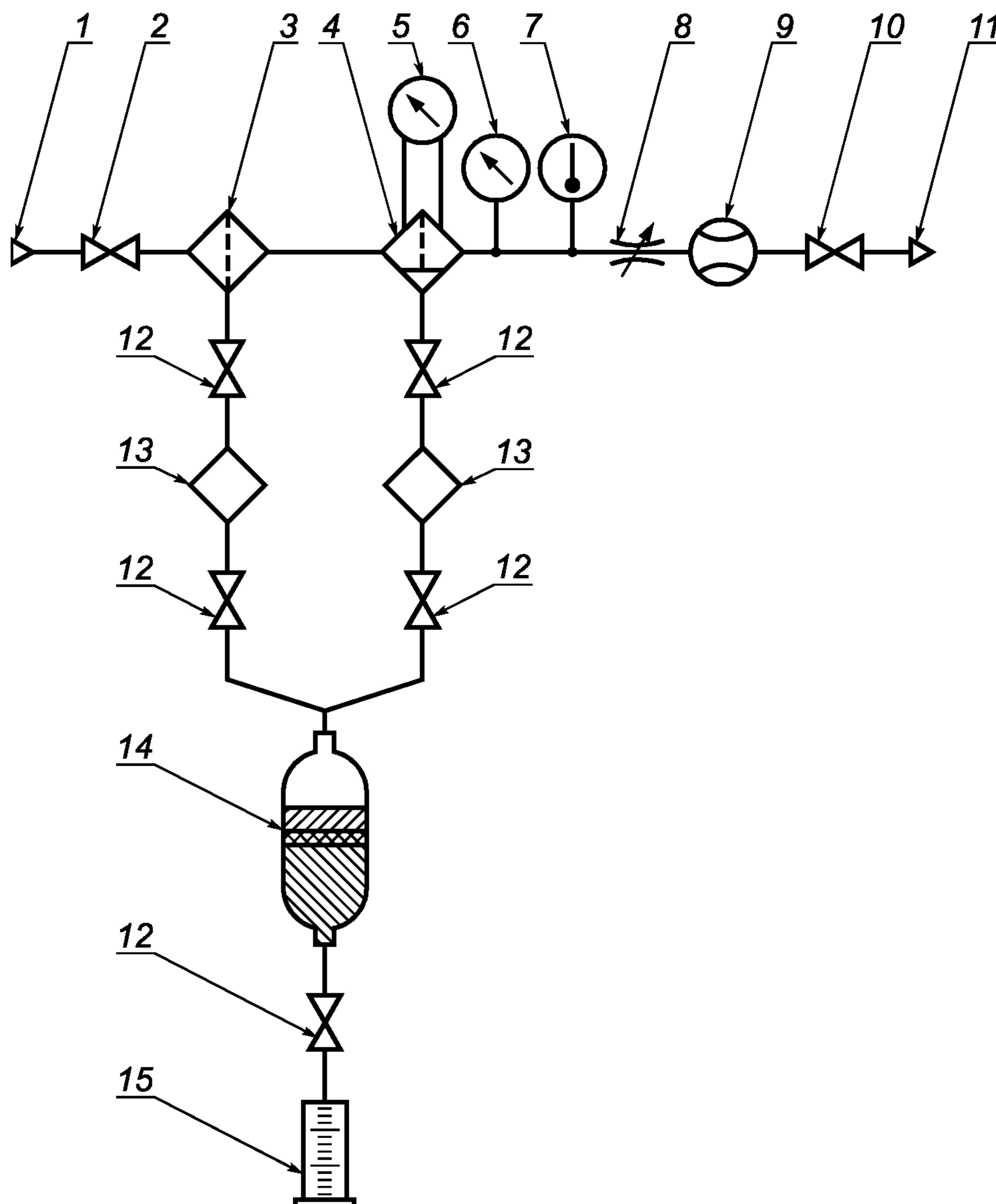
1 — место отбора пробы; 2 — запорный клапан; 3 — сепаратор воды; 4 — высокоэффективный фильтр; 5 — дифференциальный манометр; 6 — манометр; 7 — датчик температуры; 8 — вентиль регулирования расхода; 9 — расходомер воздуха; 10 — запорный клапан; 11 — выход воздуха; 12 — сливной клапан; 13 — накопительная емкость; 14 — сепаратор масла/воды; 15 — измерительная колонка
