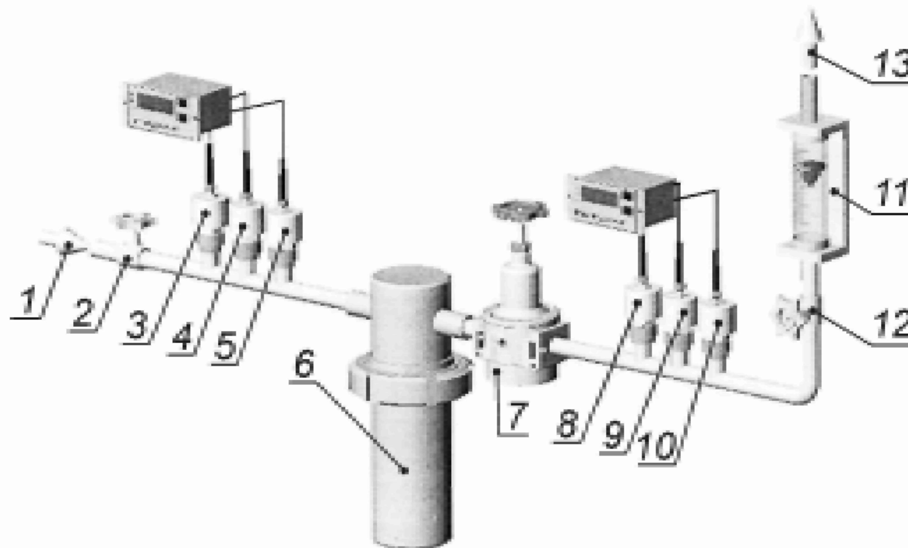
1 — место отбора пробы; 2 — запорный клапан; 3 — манометр; 4 — датчик температуры; 5 — датчик влажности; 6 — нагреватель; 7 — вентиль регулирования давления; 8 — манометр; 9 — датчик температуры; 10 — датчик влажности; 11 — расходомер или индикатор расхода; 12 — вентиль регулирования расхода; 13 — выход воздуха
