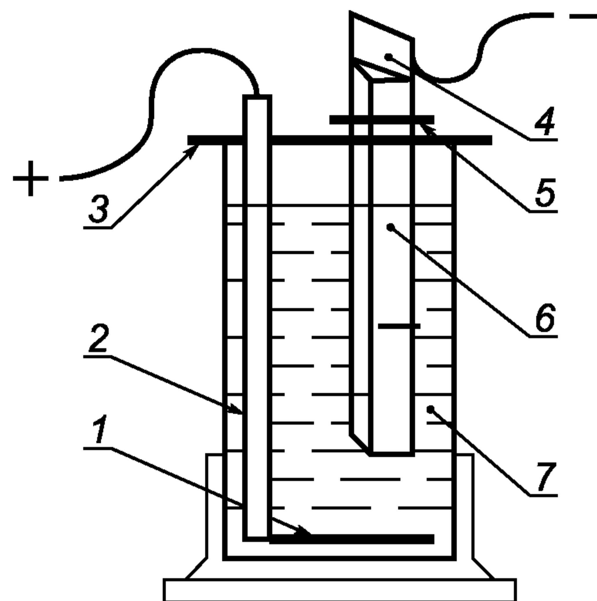
1 — круглая металлическая пластина; 2 — изолированный провод; 3 — держатель; 4 — металлическая полоса (линейка);
