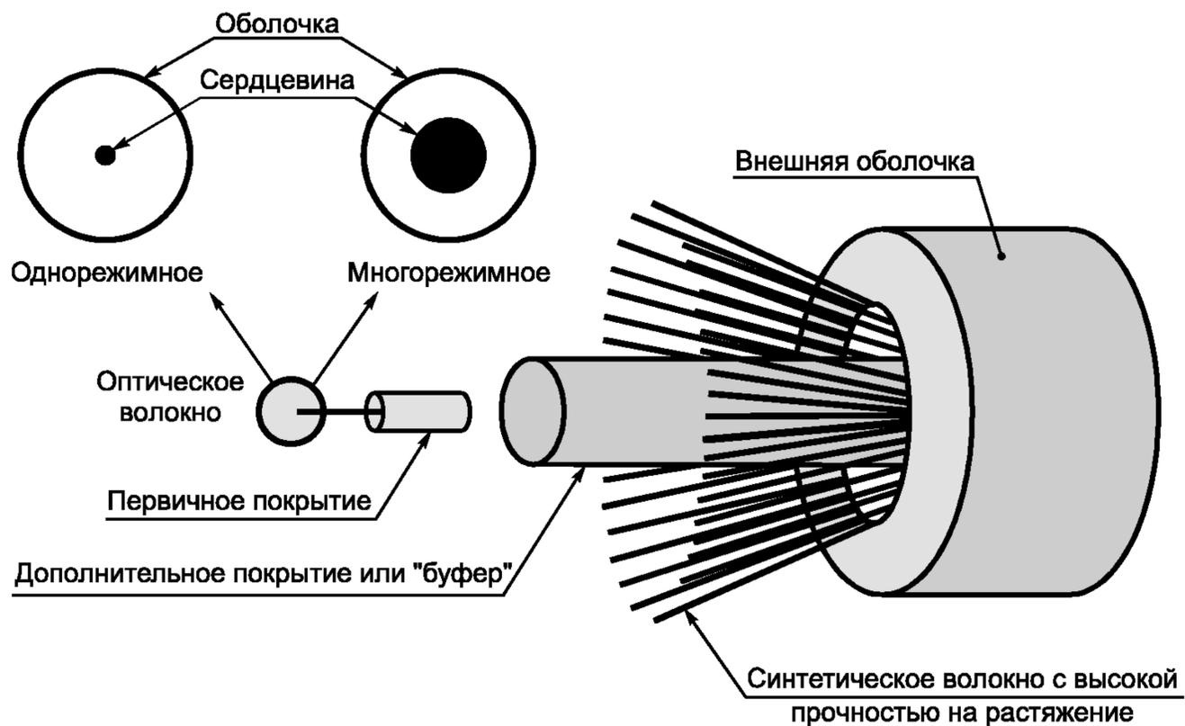
Рисунок D.2 — Типовая конструкция одноволоконного оптического волокна
