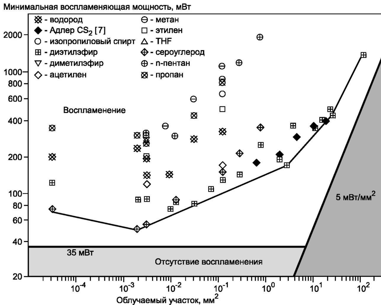
Рисунок В.1 — Минимальная воспламеняющая мощность излучения с инертным поглотителем в качестве облучаемого материала ( $\alpha_{1064 \text{ нм}} = 83 \%$ ,  $\alpha_{805 \text{ нм}} = 93$ ) при непрерывном облучении в волновом диапазоне 1064 нм
