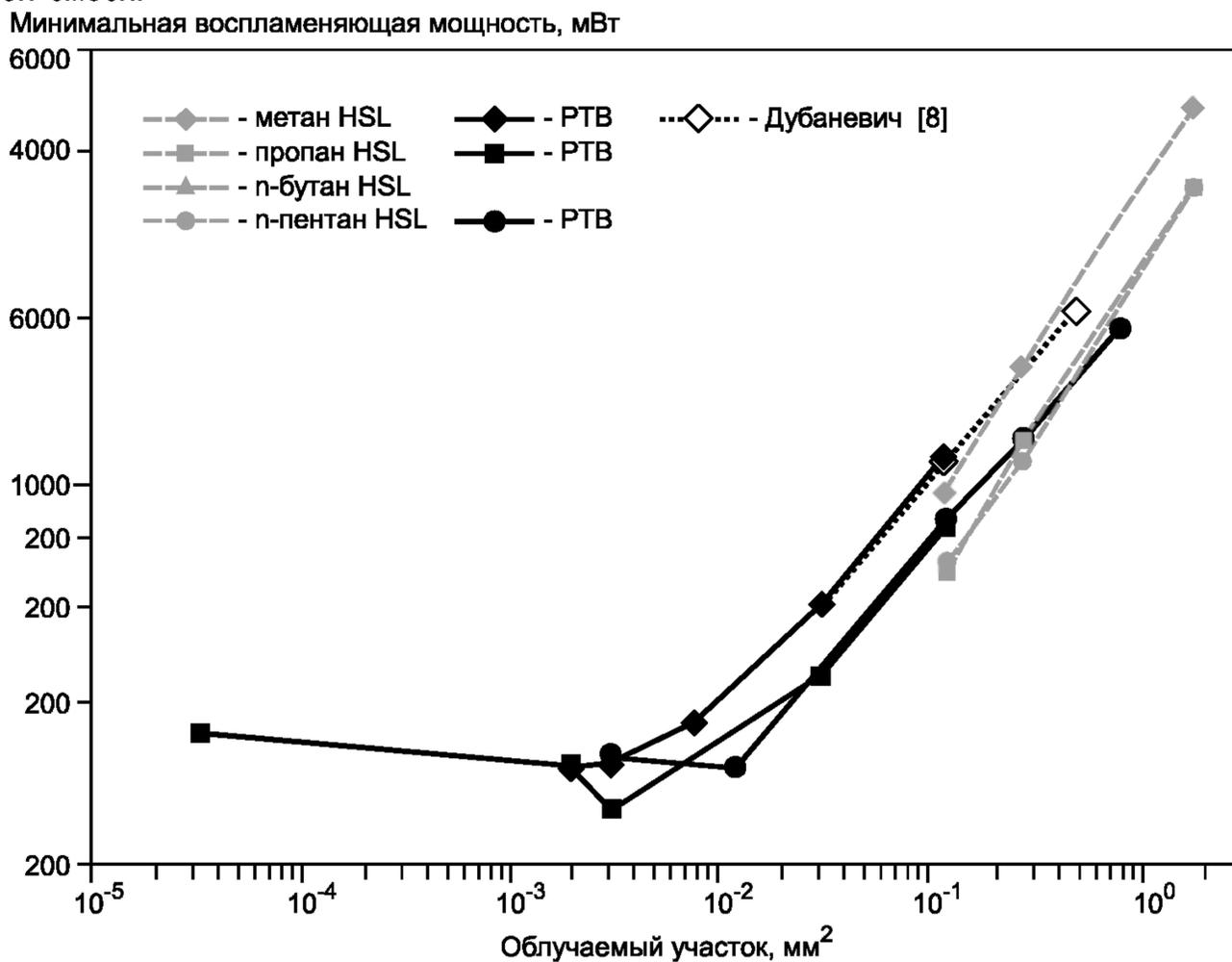
Рисунок В.2 — Минимальная воспламеняющая мощность излучения с инертным поглотителем в качестве облучаемого материала ( $\alpha_{1064 \text{ нм}} = 83 \%$ ,  $\alpha_{805 \text{ нм}} = 93$ ) при непрерывном облучении (PTB: 1064 нм, HSL: 805 нм, [24]: 803 нм) для некоторых n-алканов
