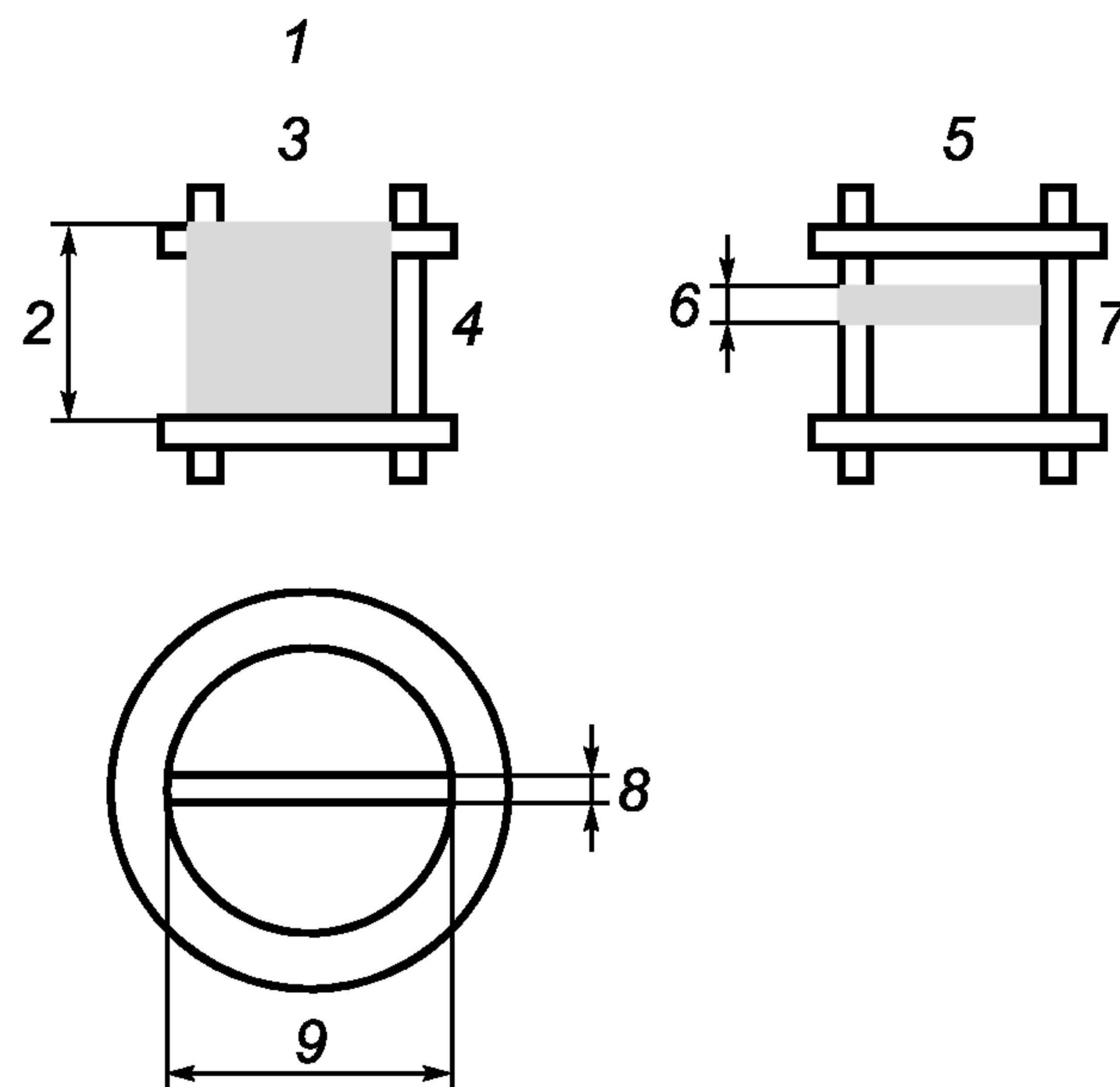
1 — координатный квадрат; 2 — ширина координатного квадрата, мм; 3 — длина координатного квадрата, мм; 4 — заполненный координатный квадрат; 5 — единичная зона на градуированной мемbrane; 6 — высота сетки для определения единичной зоны, мкм; 7 — единичная зона; 8 — круговая единичная зона на неградуированной мемbrane; 9 — диаметр рабочей зоны фильтрования мембранный фильтра
