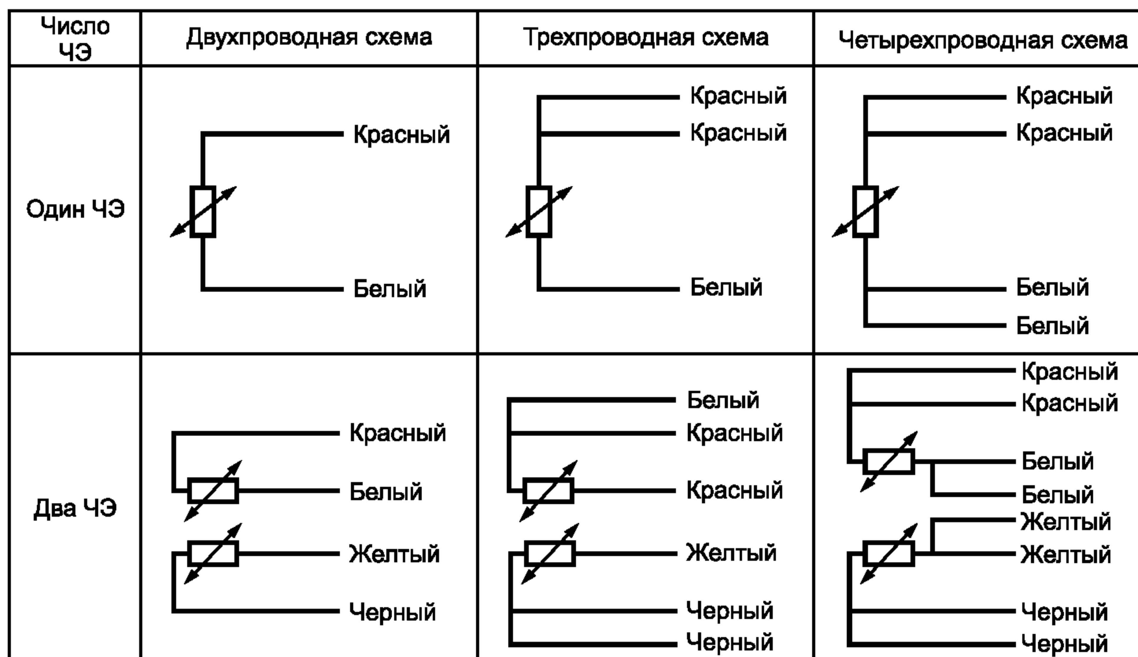
Рисунок 1 — Схемы соединения внутренних проводов
