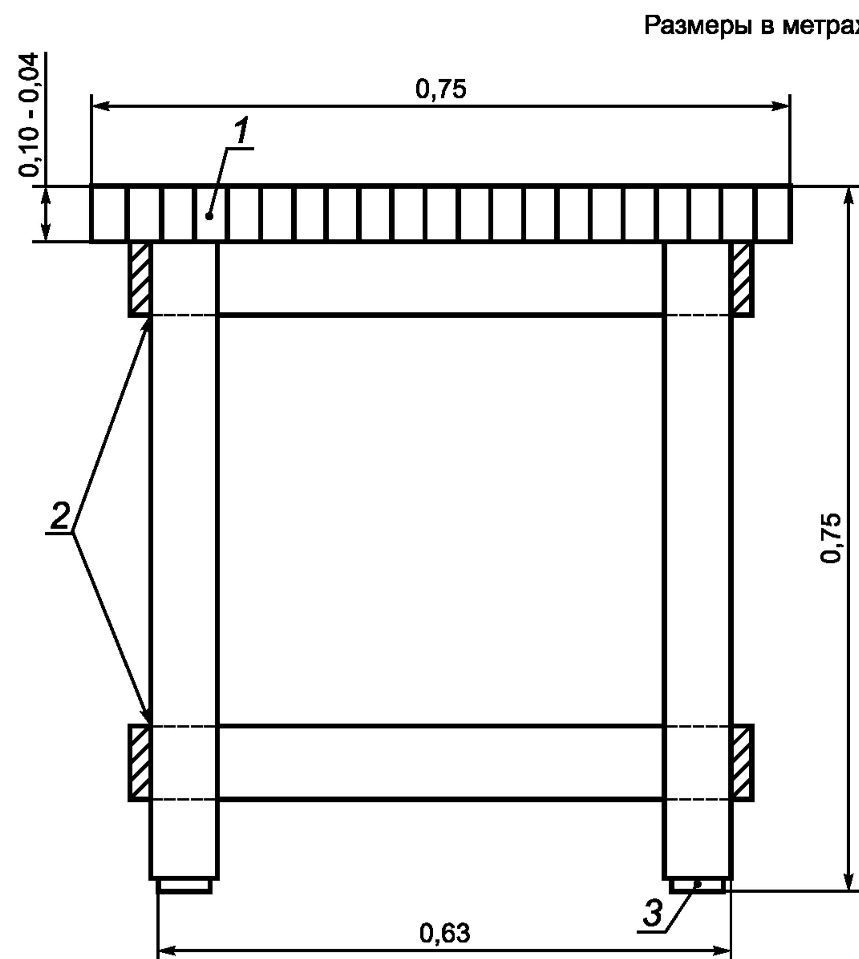
1 — верхняя поверхность стола, склеенная из деревянных брусков; 2 — ножки и стяжки, склеенные и скрепленные шурупами;
