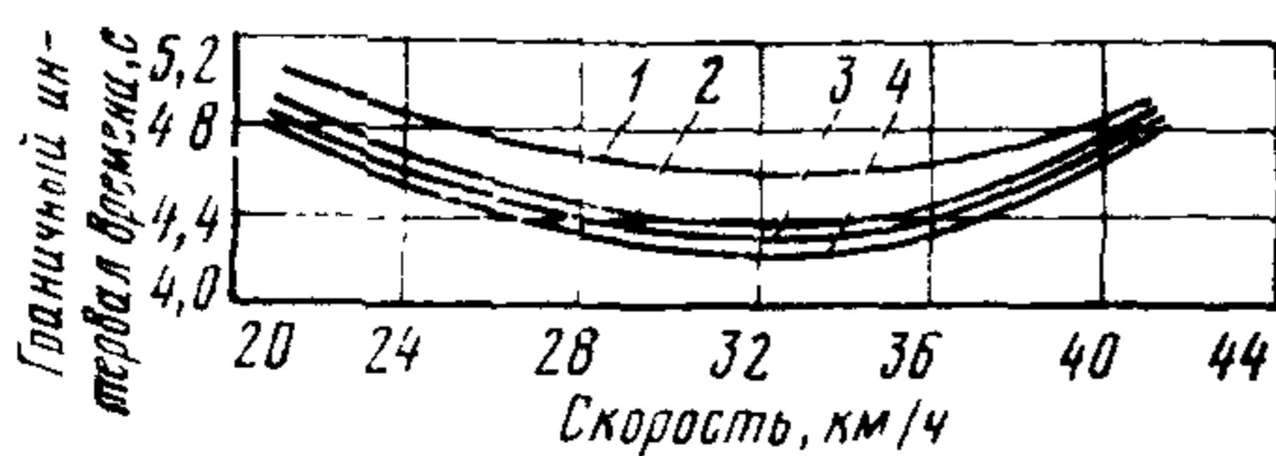
Рис 38. Зависимость величины граничных интервалов на кольцевых пересечениях от скорости движения приоритетного потока и угла слияния потоков
