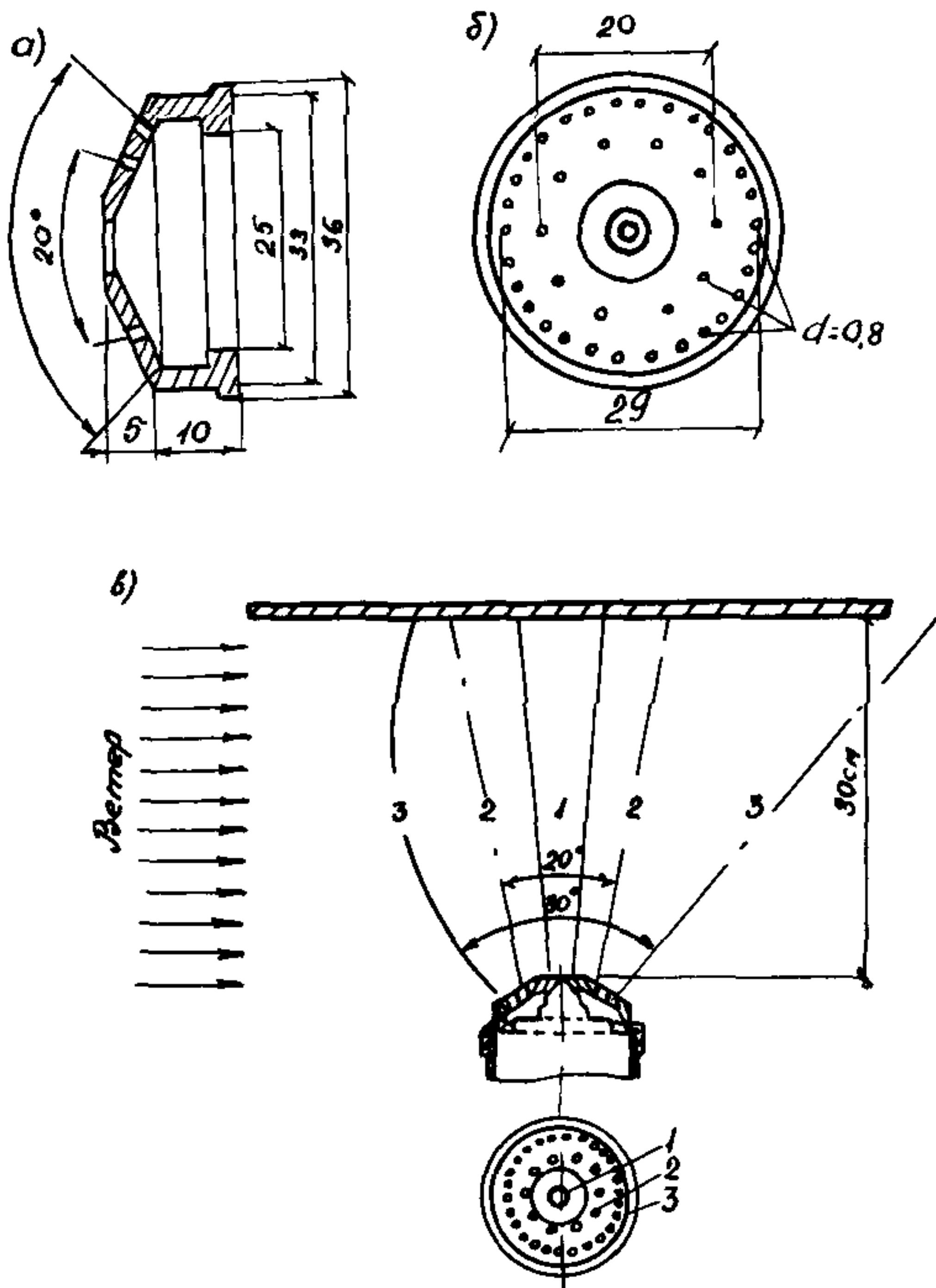
Распылительная головка (сопло) конструкции
