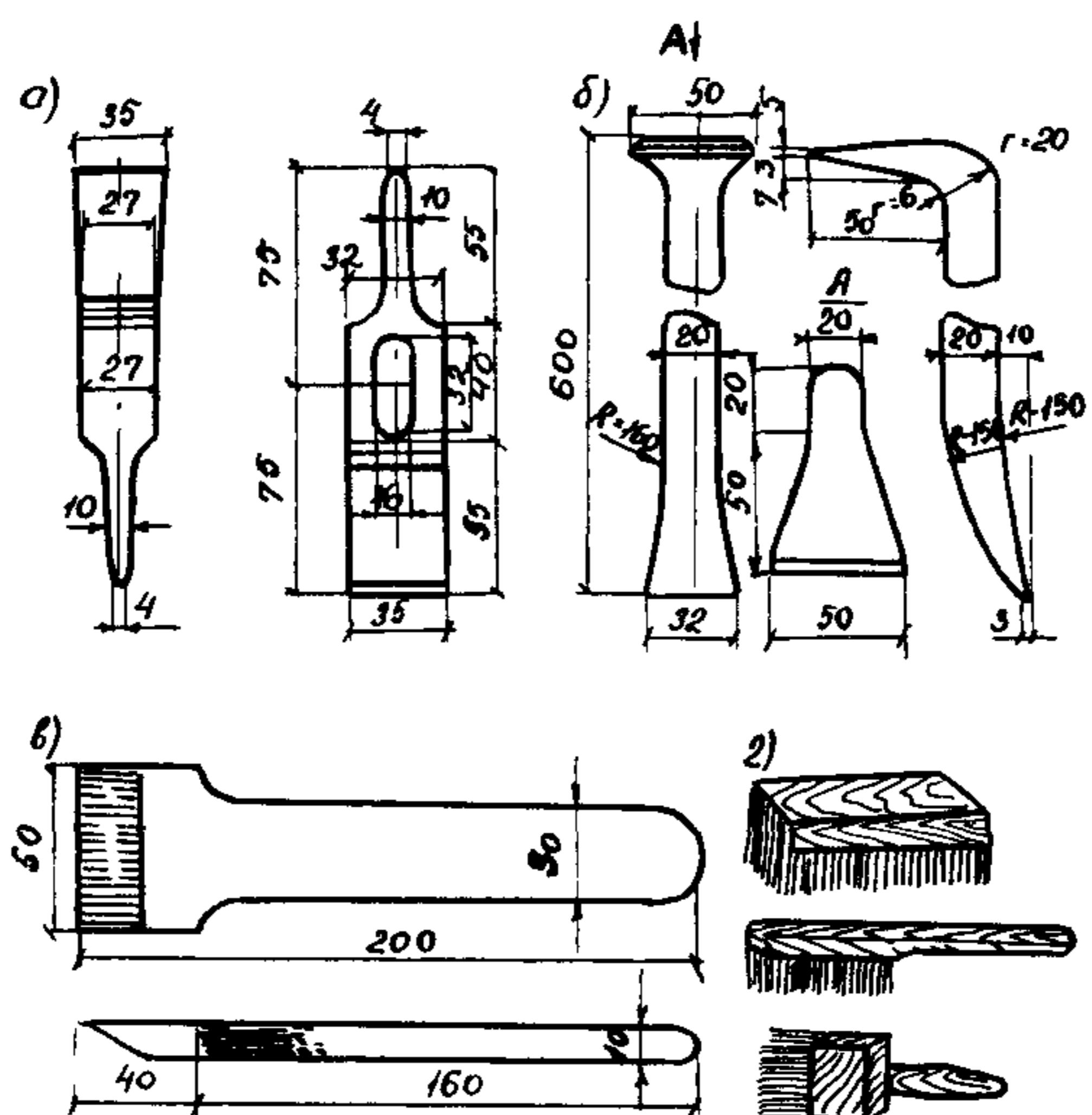
Рис. I. Ручной инструмент для очистки:
