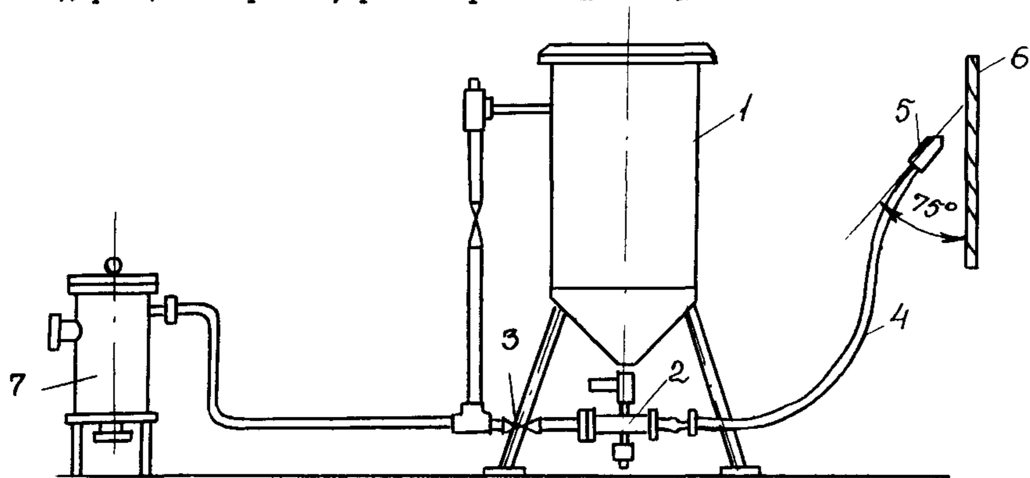
Рис.2. Схема установки пескоструйного аппарата
