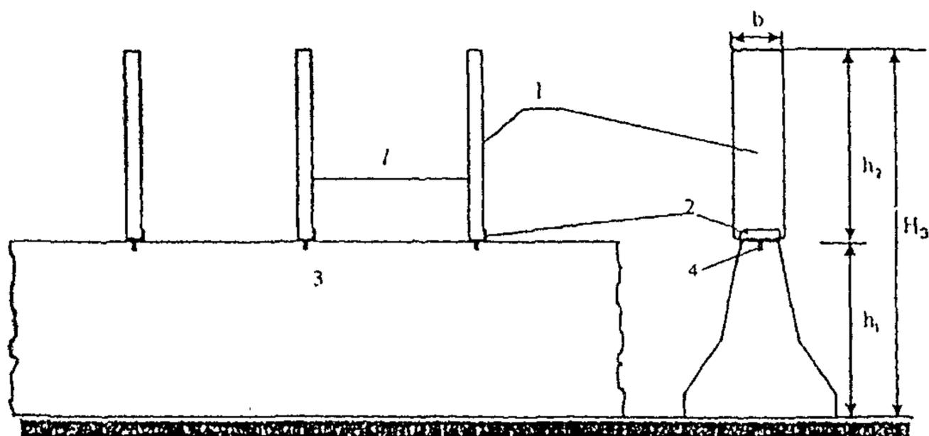
Рисунок А3-Общий вид экрана пластинчатого на ограждениях парапетного типа. 1 - пластины; 2 - опорная часть; 3 - парапетное ограждение; 4 - металлический штырь;  $h_1$  - высота установки сетки;  $H_3$  - высота экрана;  $h_2$  - высота пластины.
