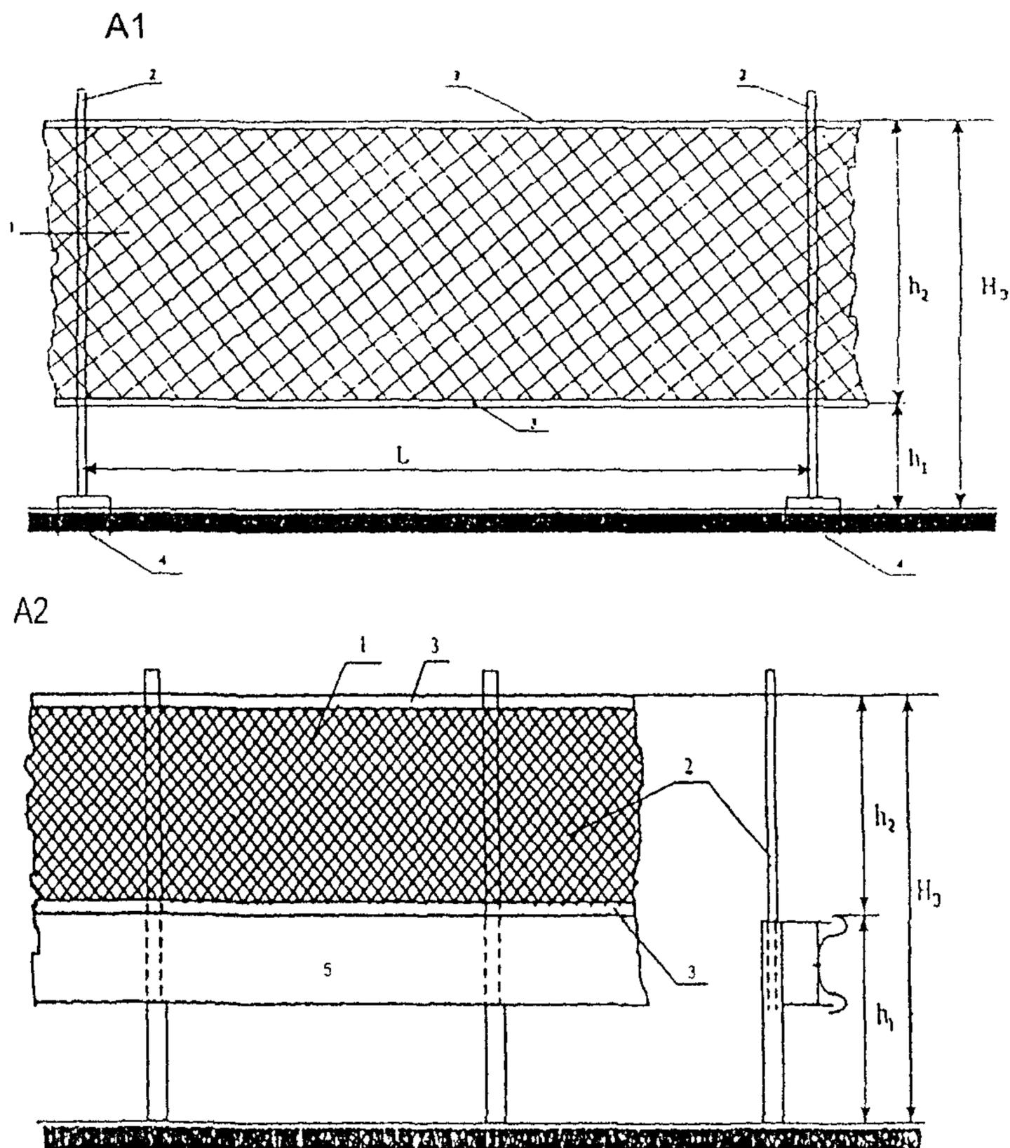
Рисунок А - Общий вид экрана сетчатого на стойках (А1) и на металлическом ограждении барьерного типа (А2). 1 - сетка; 2 - стойки опорной части; 3 - продольные рейки; 4 - фундамент опорной части; 5 -барьерное ограждение;  $h_1$  - высота установки сетки;  $H_3$  - высота экрана;  $h_2$  - высота сетки.
