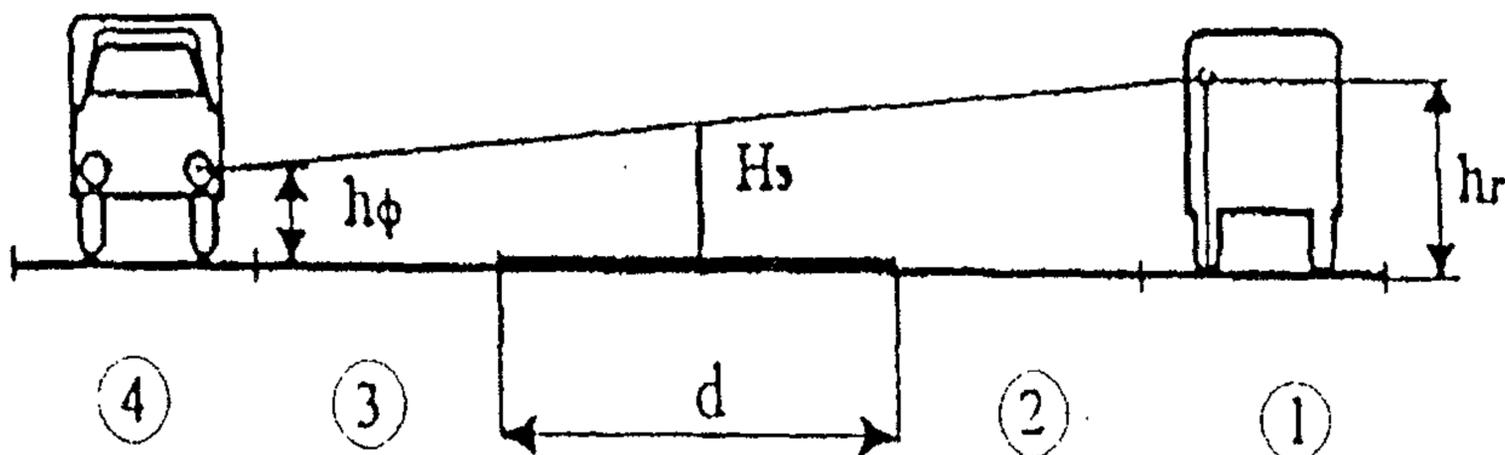
Рисунок А4 - Схемы для расчета требуемой высоты экрана ( $H_s$ ). 1 - проезжая часть; 2 - разделительная полоса; 3 - ось экрана;  $l_r$  - расстояние от глаз водителя до оси экрана;  $l_{\phi}$  - расстояние от фары до оси экрана;  $h_r$  - высота расположения глаз водителя грузового автомобиля над поверхностью покрытия.  $h_{\phi}$  - высота расположения фары автомобиля;  $d$  - ширина разделительной полосы; (1) (4) номера полос движения.
