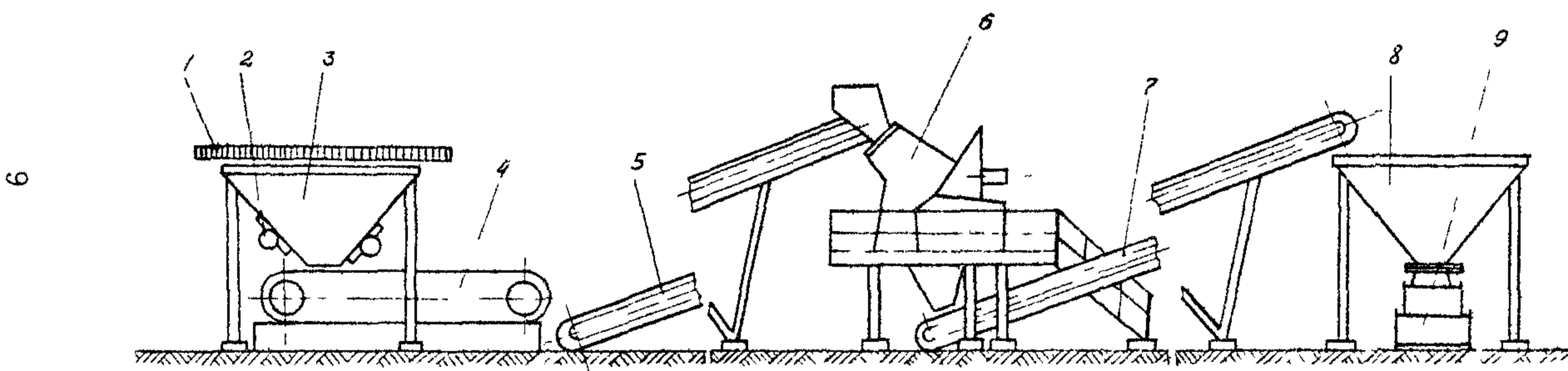
Рис.2. Технологическая линия дробления асфальтобетонного лома:
