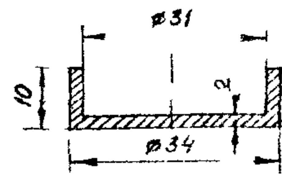
Рис.1. Блок металлический. Покрытие - гальваническое цинковое или никелевое ( $\delta = 40-60$  мкм)
