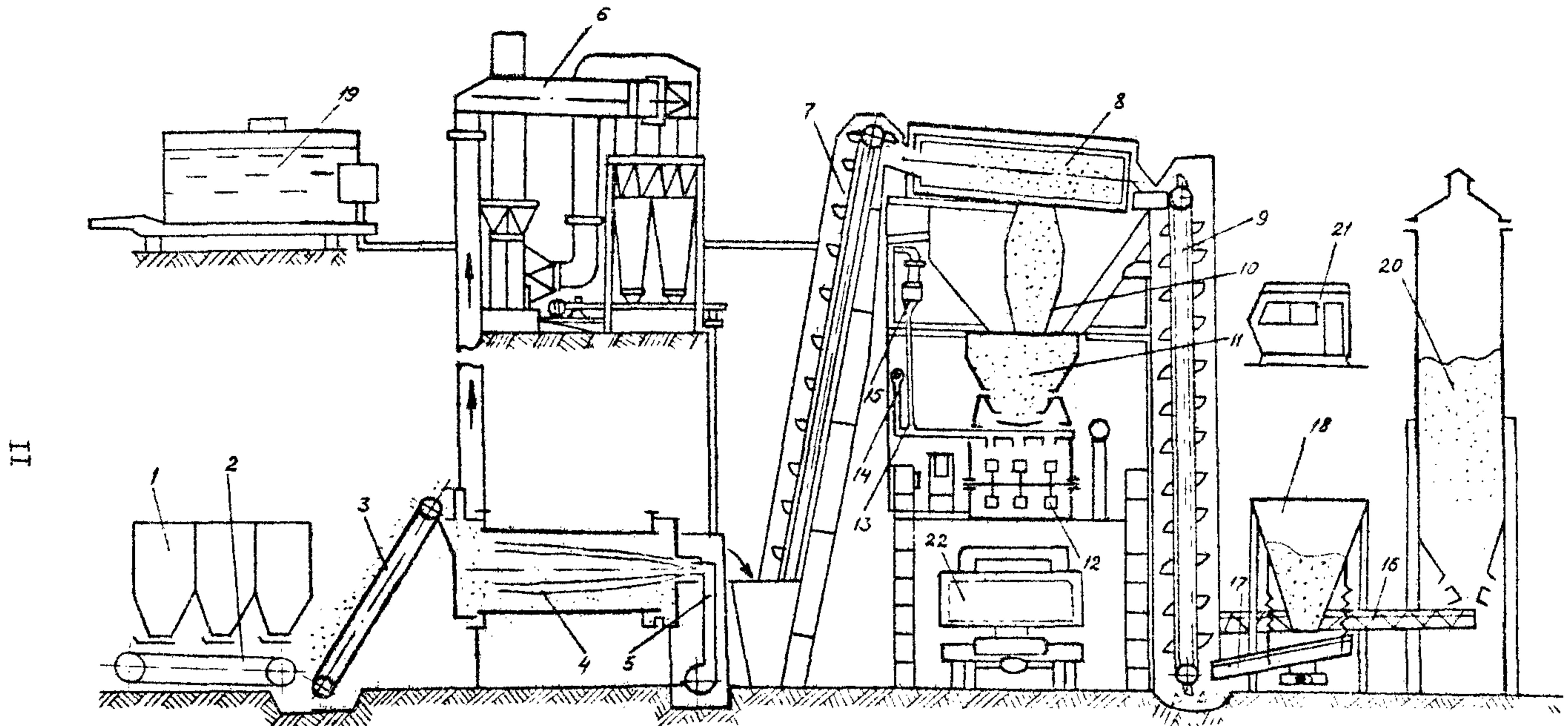
Рис.3. Технологическая схема приготовления в установке Д-508-2А горячих асфальтобетонных смесей с добавлением старого асфальтобетона:
