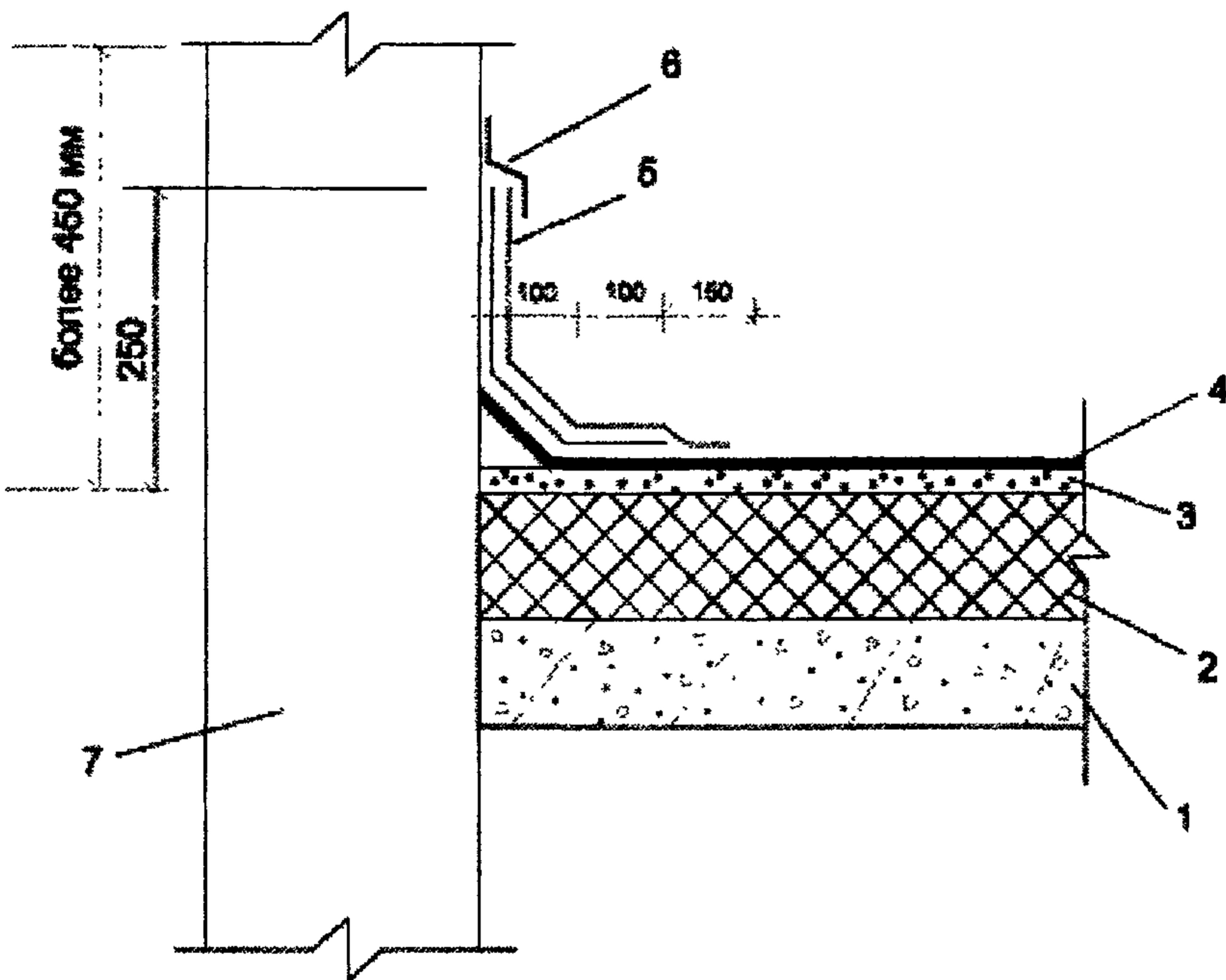
1 — железобетонная плита, 2 — утеплитель;
