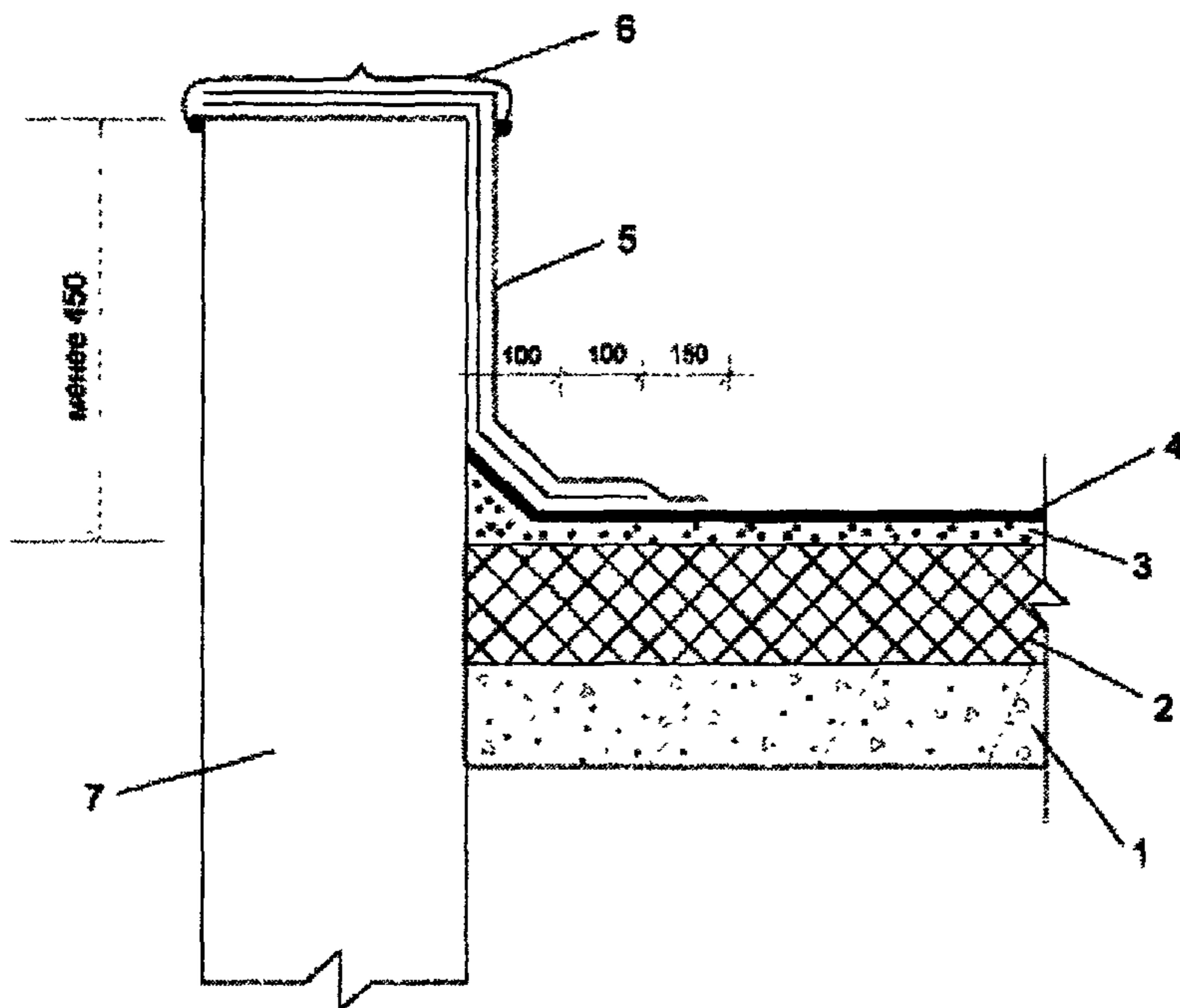
1 — железобетонная плита; 2 — утеплитель;
