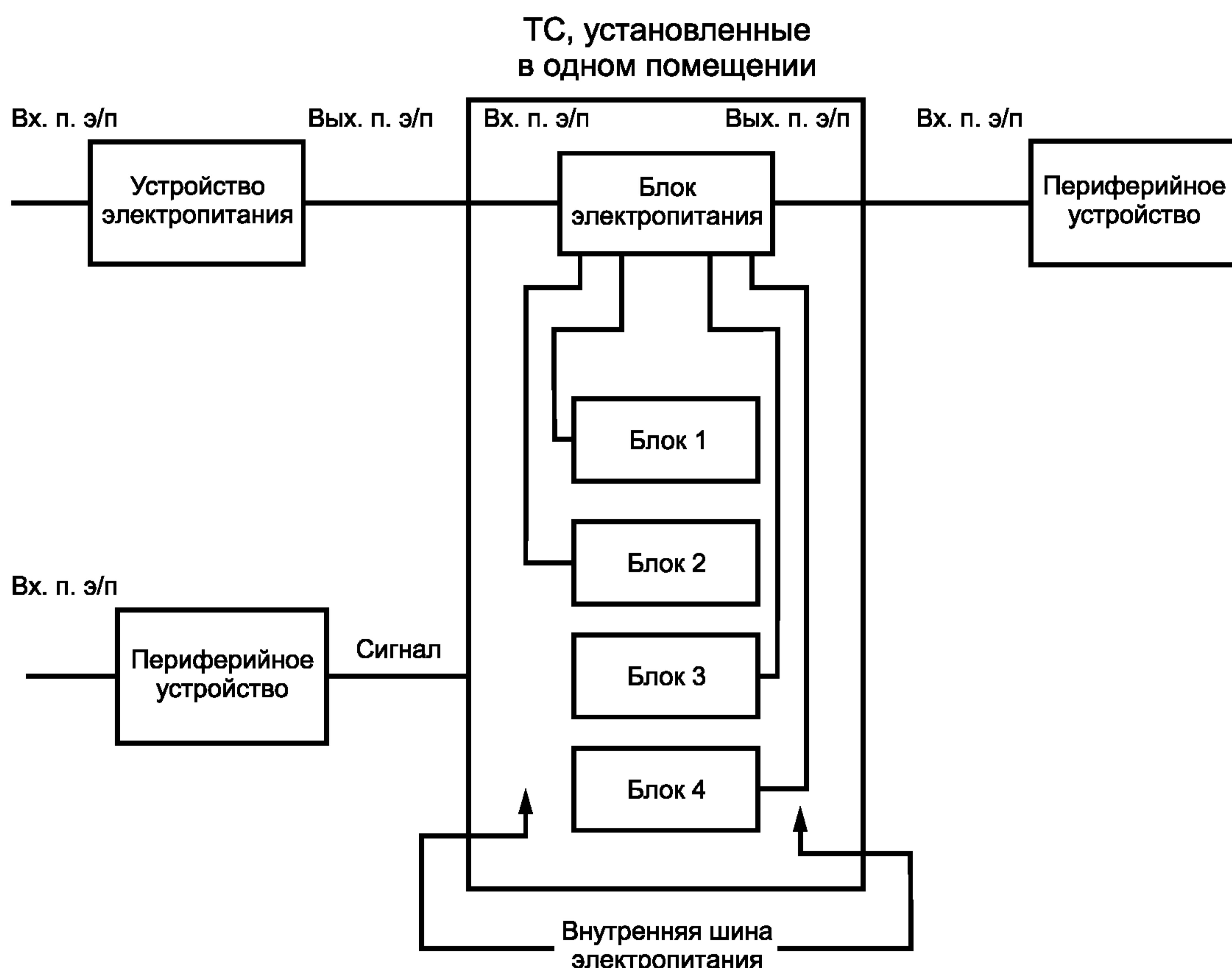
Рисунок 2 — Примеры портов электропитания
