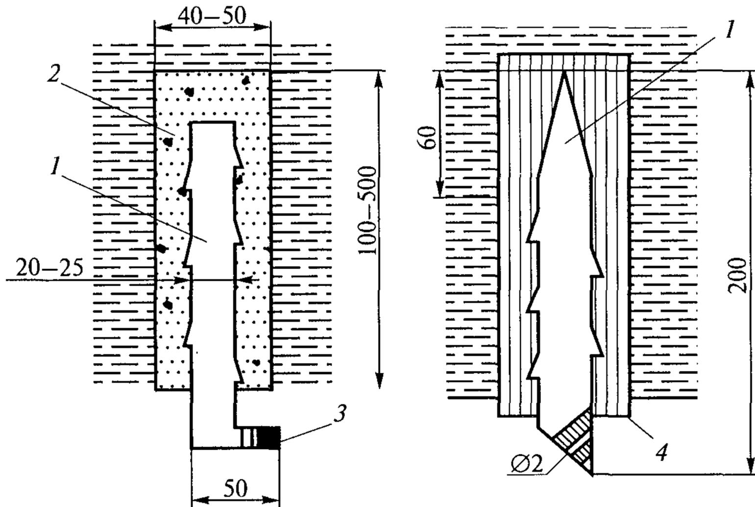
**Рис. 2.** Центры пунктов в кровле выработки:
