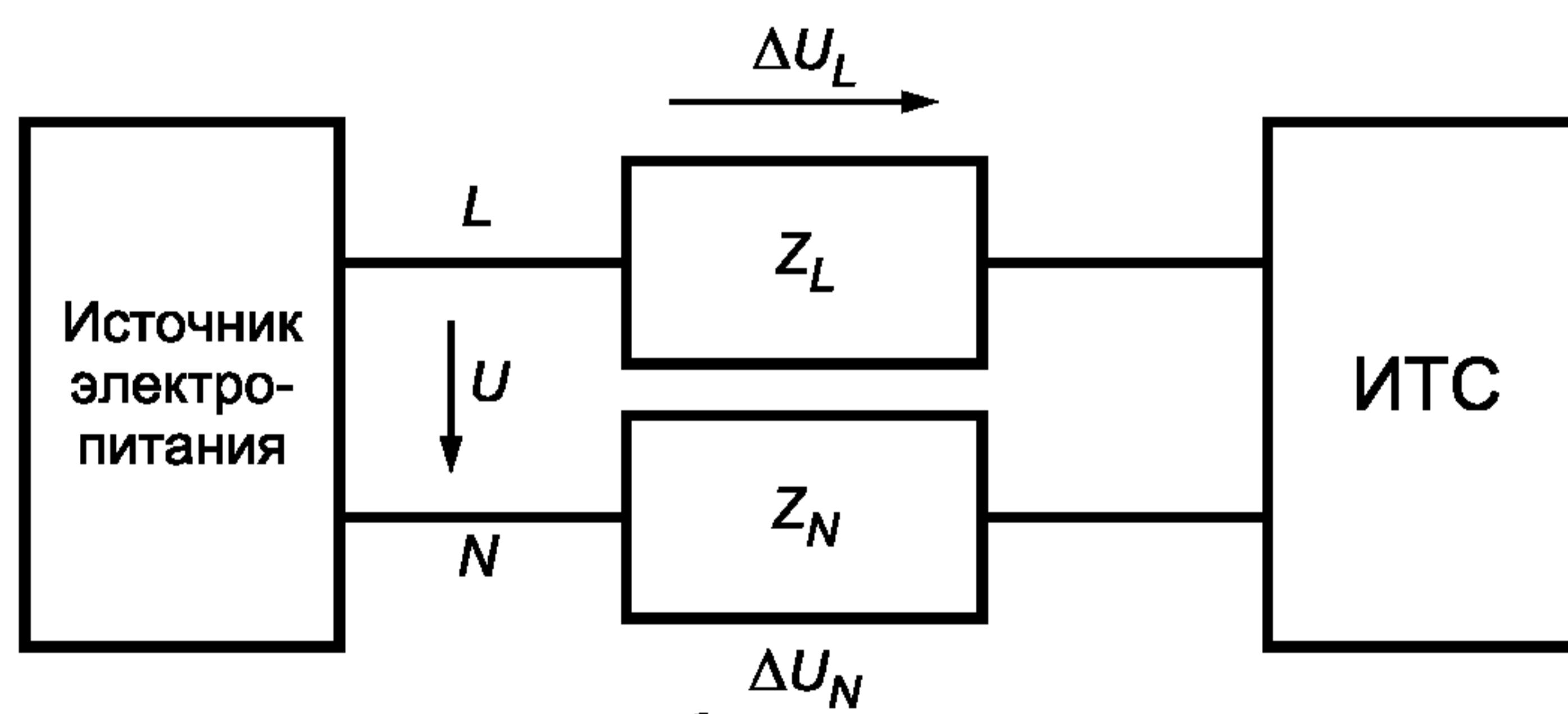
$U$  — напряжение «фаза — нейтраль» источника электропитания;  $Z_{L, N}$  — полное сопротивление проводников и устройств измерения тока; ИТС — испытуемое ТС;  $\Delta U_L$ ,  $\Delta U_N$  — падение напряжения на полном сопротивлении  $Z_L$  и  $Z_N$ ;  $L$  — фазный проводник;  $N$  — нейтральный проводник
