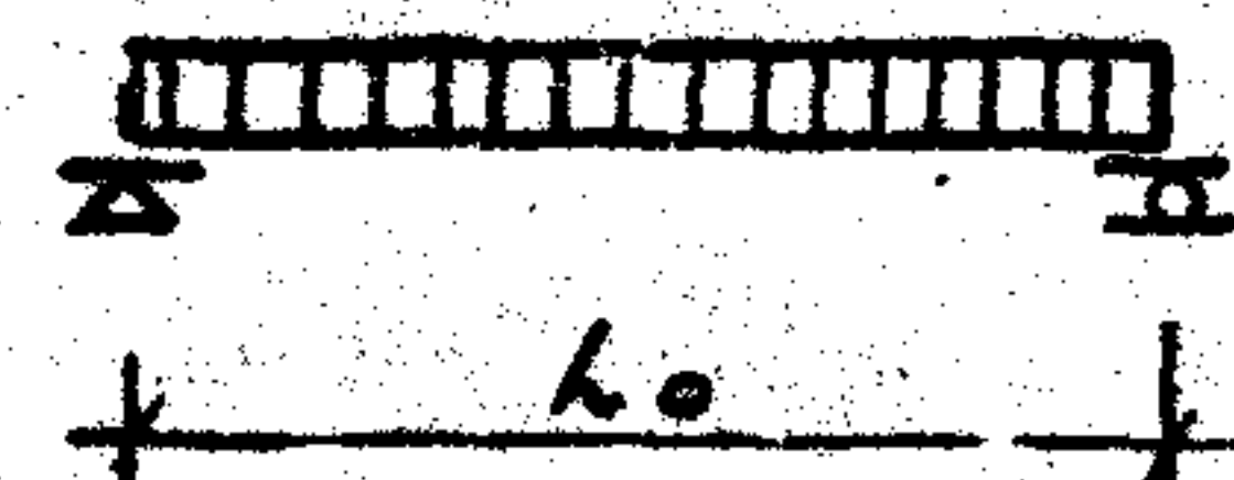
Схема опирания и загрузки при испытании плит
