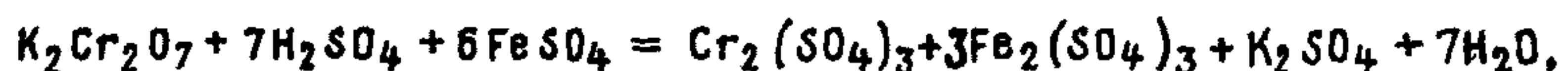
Для лучшего окисления органических веществ в пробе добавляют в качестве катализатора сульфат серебра. Сточные воды от свинооткормочных комплексов, поступающие на очистные сооружения, окисляются без катализатора в среднем на 56% [10]. По-
