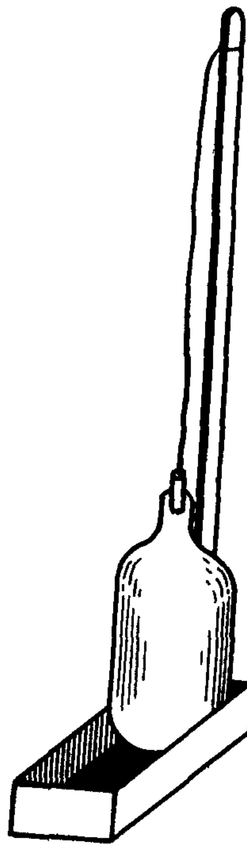
Рис.4. Прибор для взятия проб на растворенный кислород.
