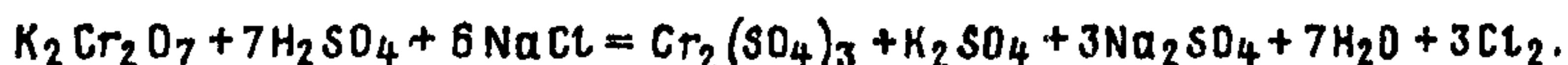
Влияние хлоридов устраняют добавлением соли сернокислой ртути. Если концентрация хлорид-ионов превышает 1 г/л, то следует добавить в пробу на каждый миллиграмм хлорид-иона 15 мг ртути (22,5 мг сернокислой ртути) и 5 мл концентрированной серной кислоты для лучшего растворения сульфата ртути.
