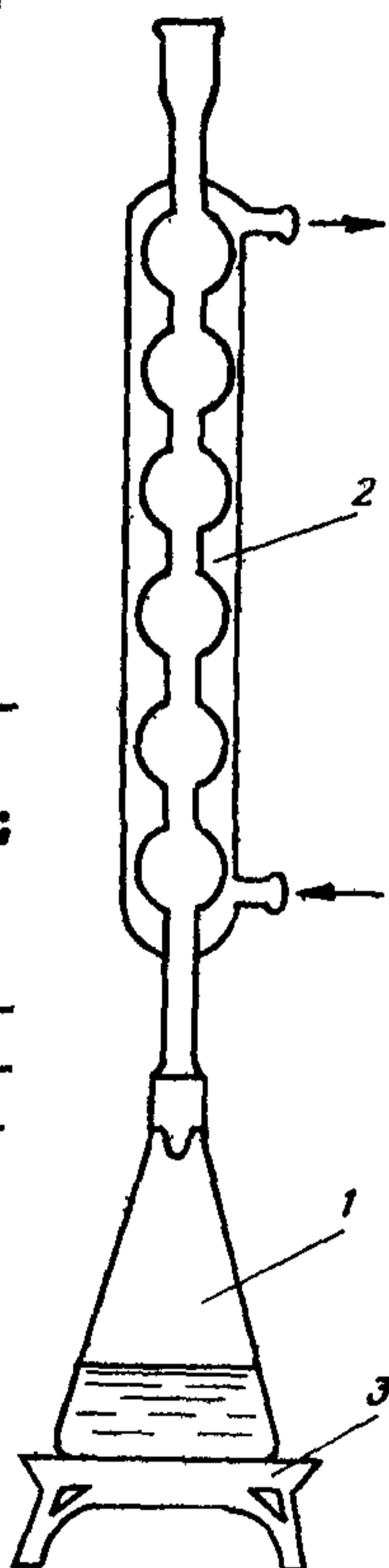
Рис.3. Установка для определения ХПК:
