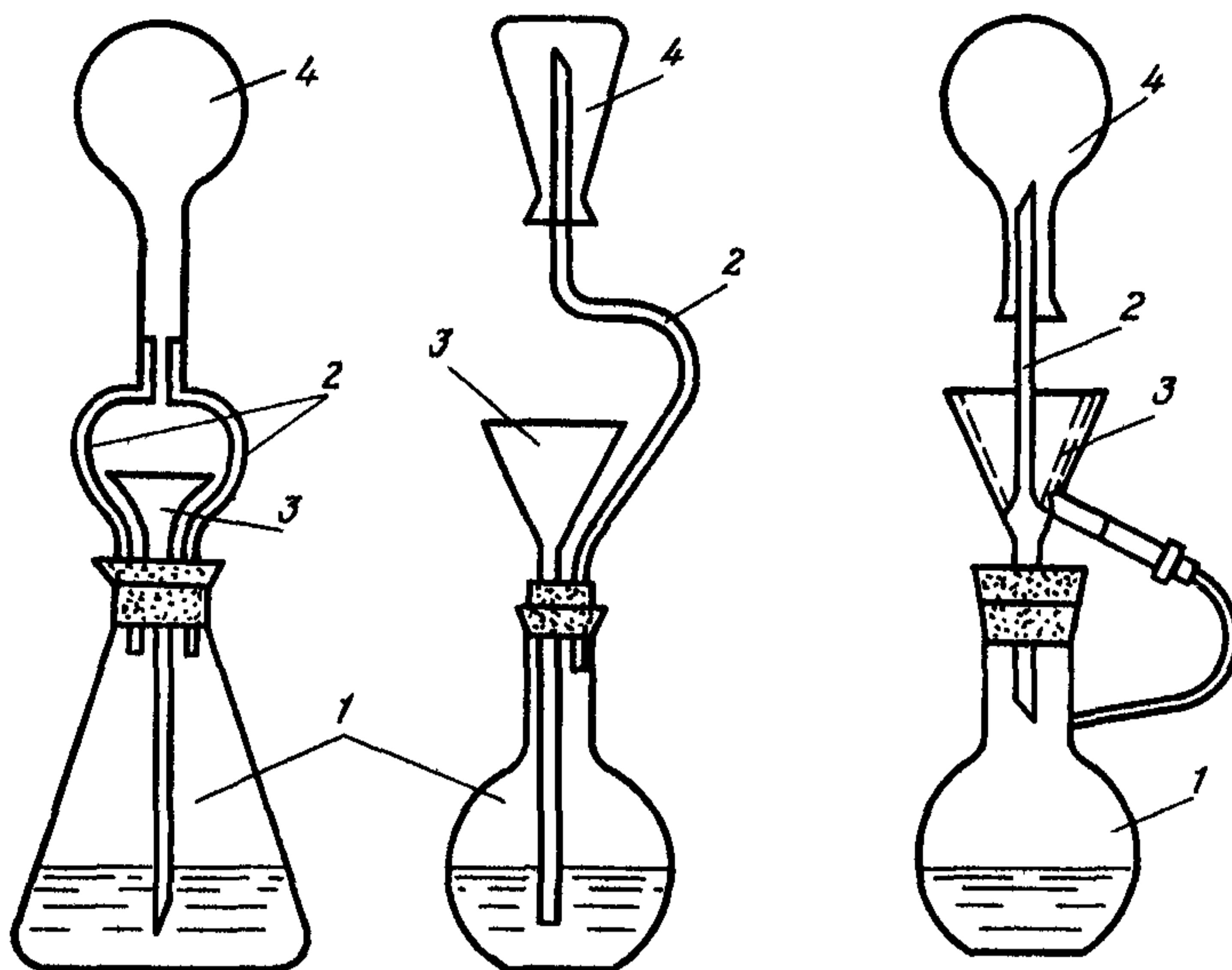
Рис.6. Приборы для обработки посуды паром:
