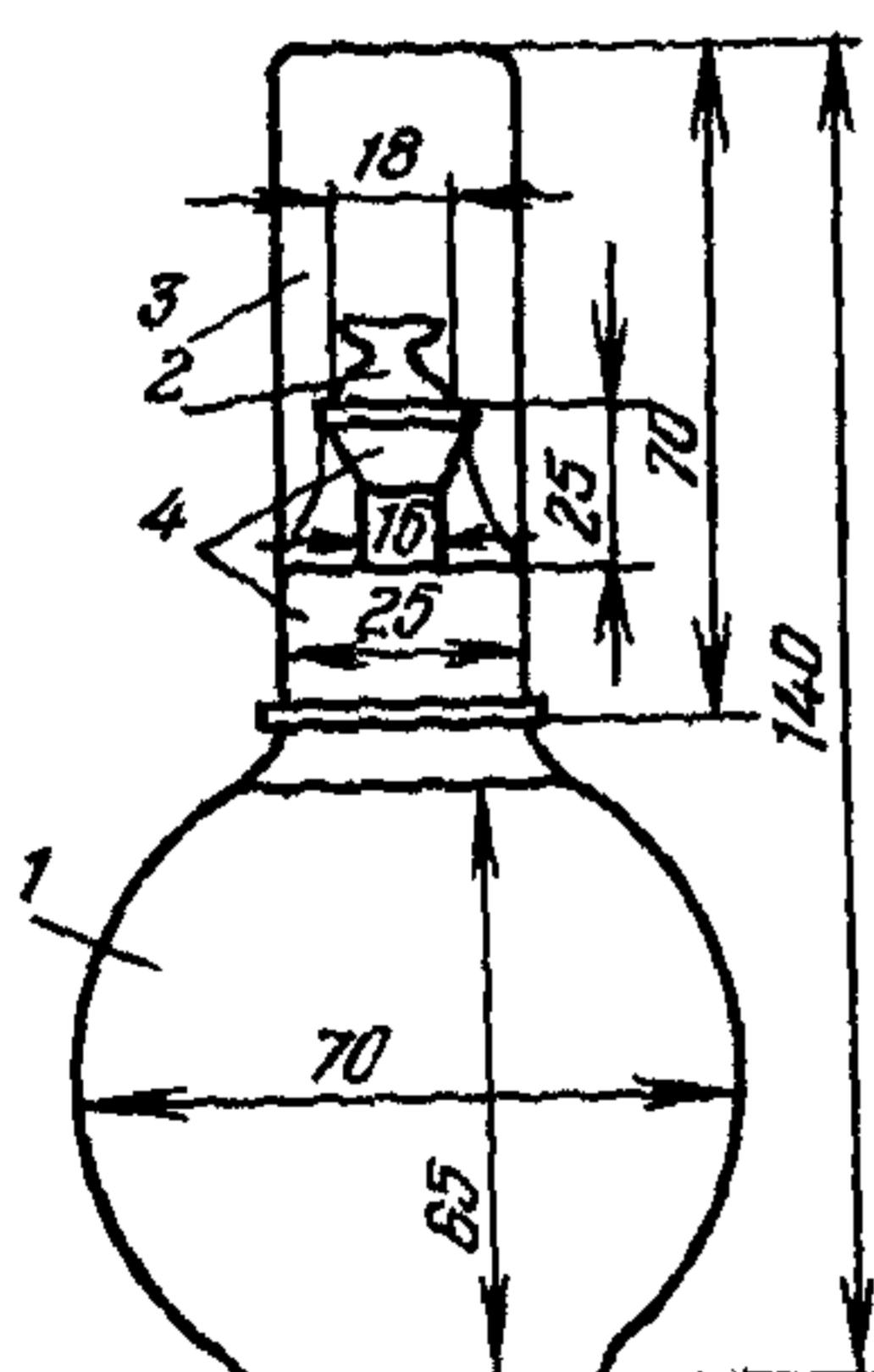
Рис.5. Склянка для инкубации при определении БПК:
