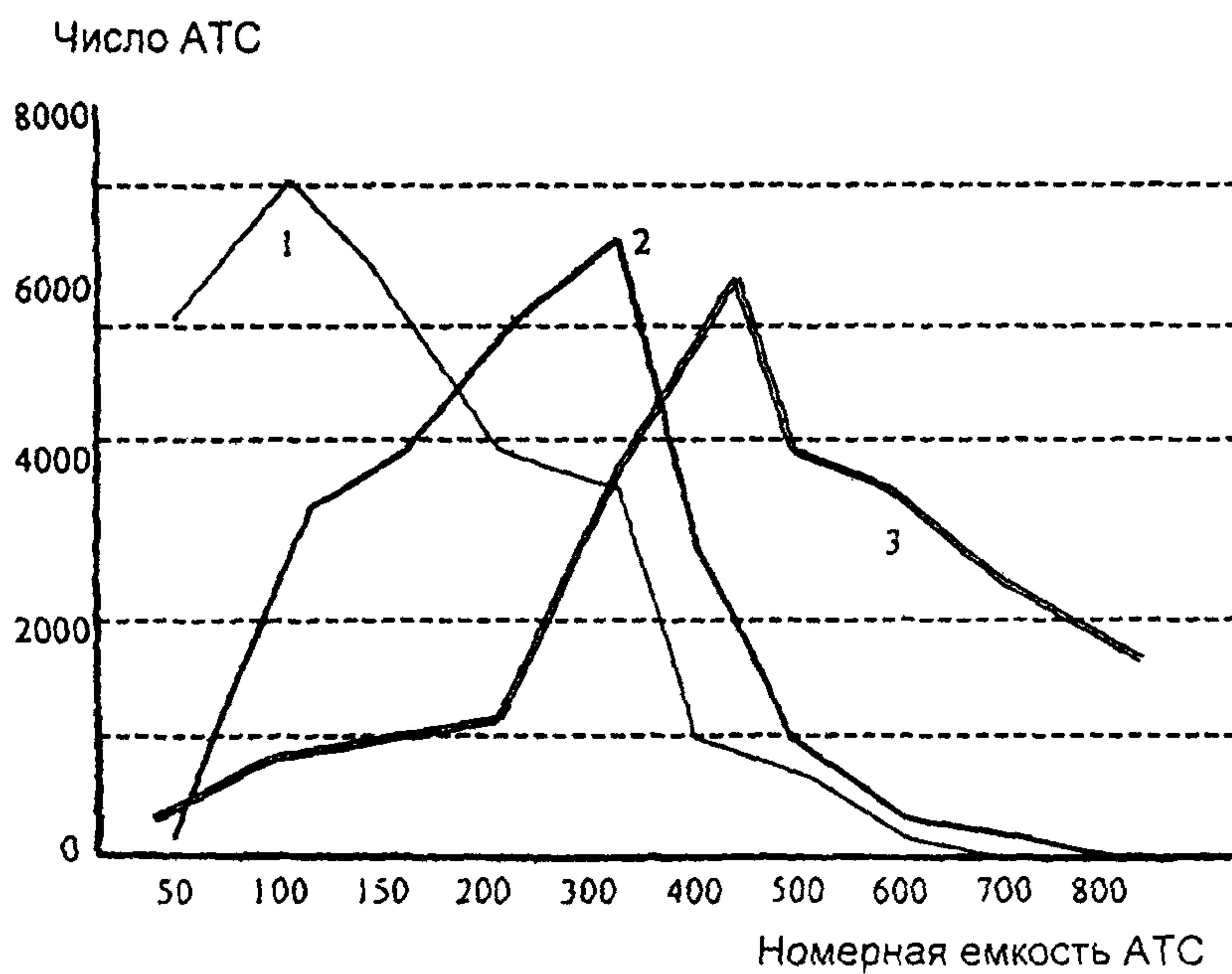
Рисунок 1 - Зависимость числа АТС от их номерной емкости при монтированной емкости телефонной сети
