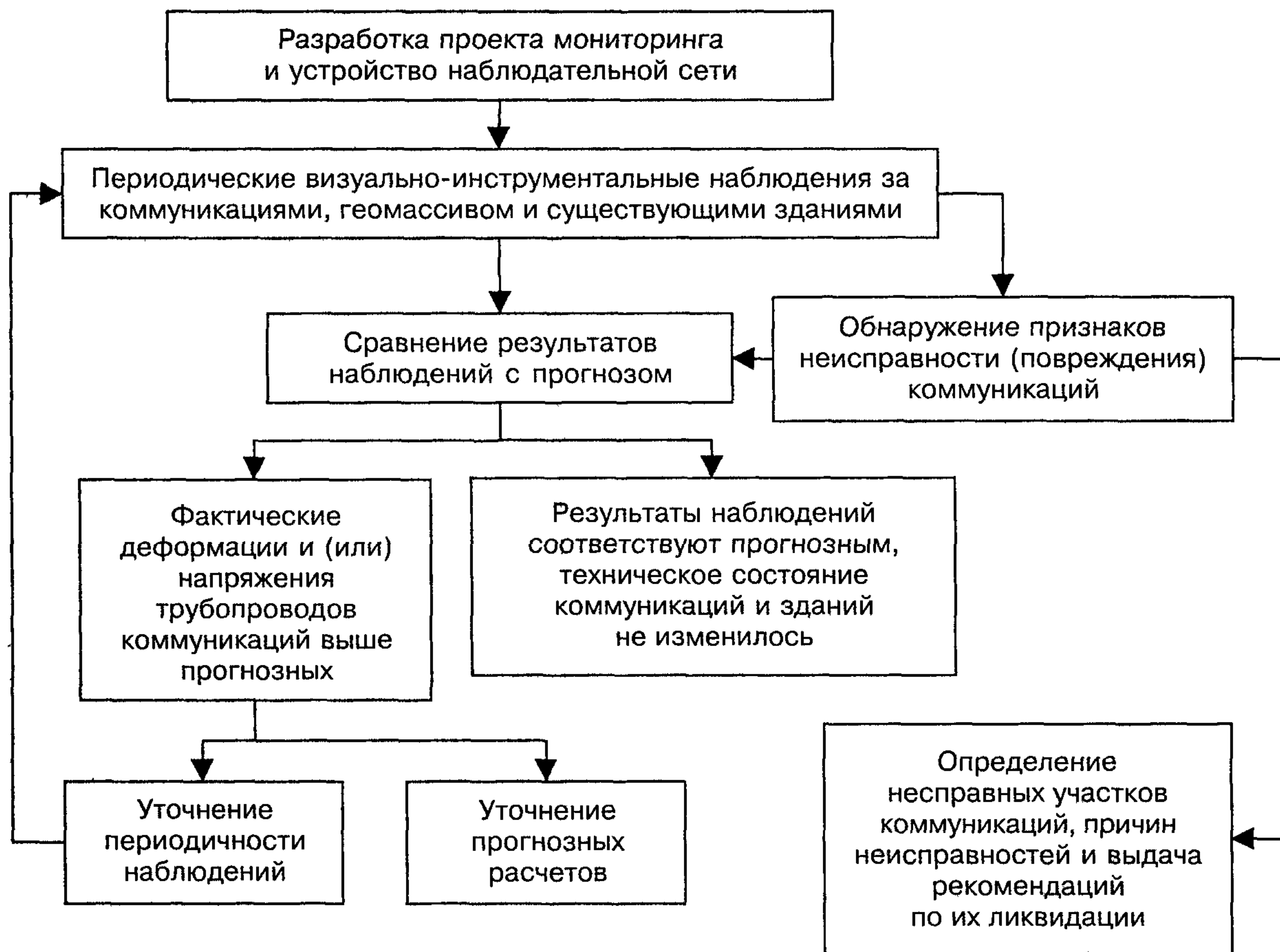
Рисунок 3.1 — Блок-схема мониторинга подземных коммуникаций на стадии строительства
