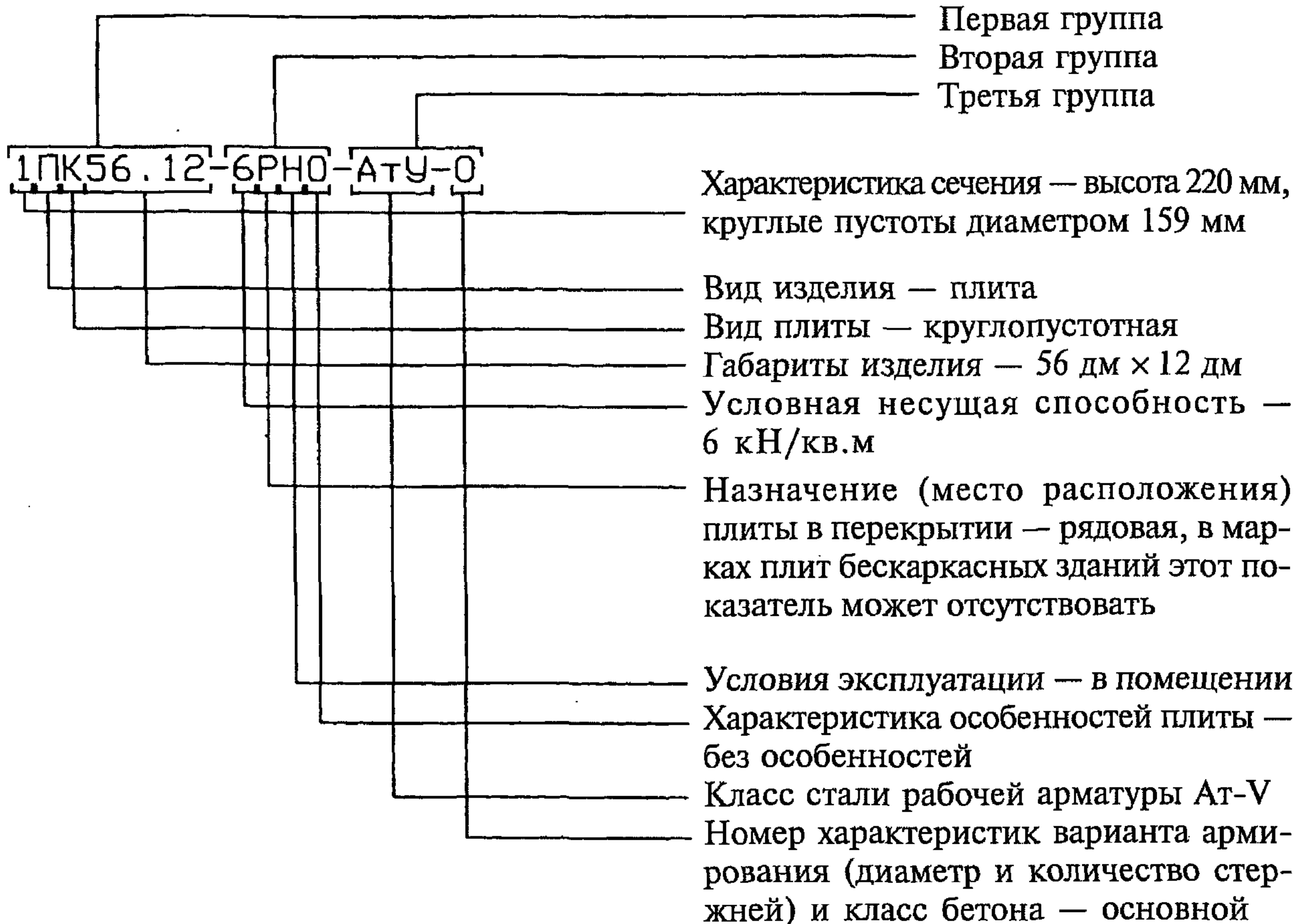
4.4. Для упрощения нанесения марок на плиту допускается при согласовании с заказчиком применять сокращенную маркировку типовых плит. Например, вместо серийной марки 1ПК56.12-6РНО-АтУ-О — сокращенная марка — П56.12-6-3.
